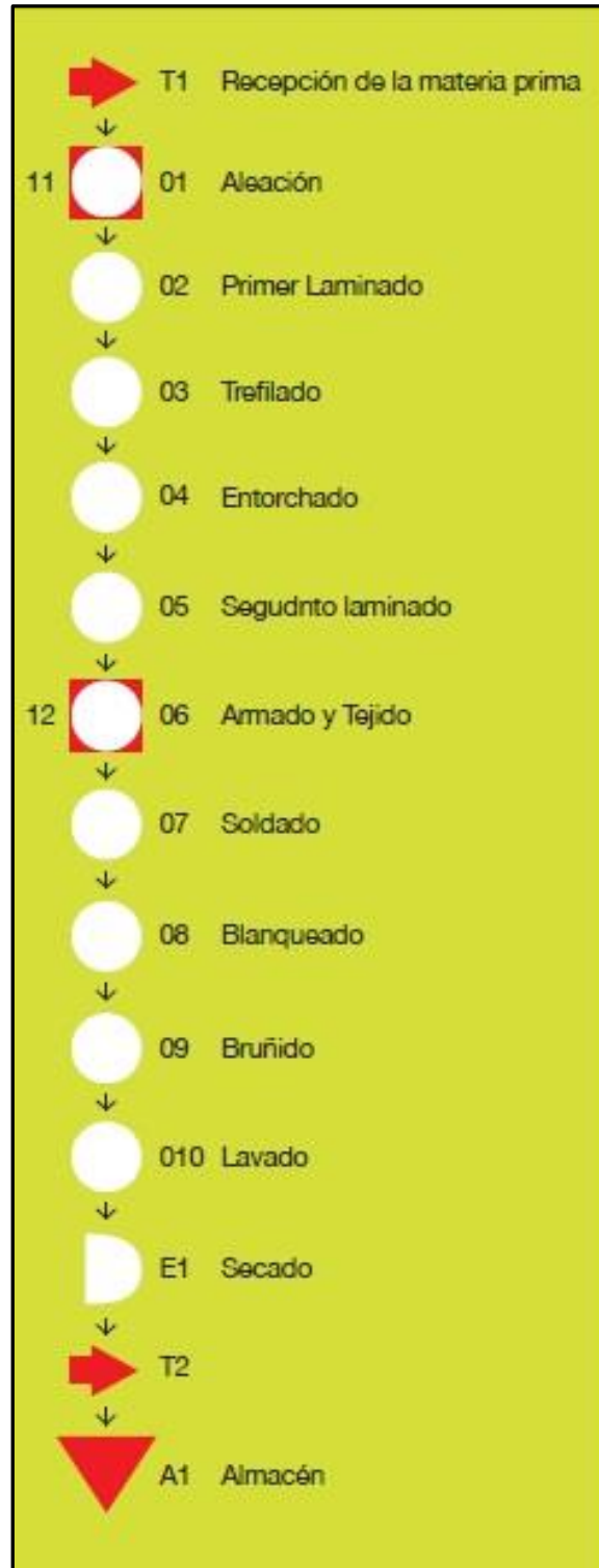
Figura N° 38. Proceso de fabricación de una joya de plata
