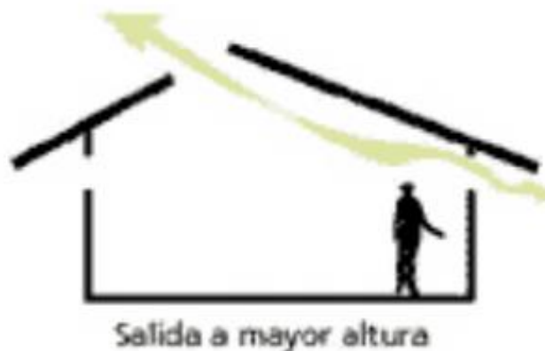
Figura 2.1.2.8. Patrón de flujo del aire según la altura de ubicación de las ventanas
