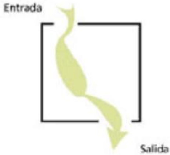
Figura 2.1.2.4. Dimensión de la abertura de entrada en relación a la de salida
