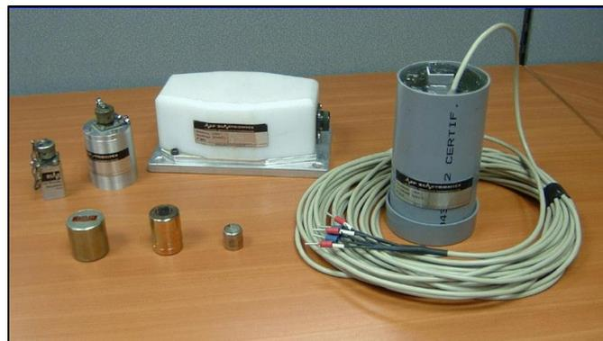
El geófono no es tan robusto como el acelerómetro, por lo cual podría eventualmente dañarse si es mal manipulado. Los geófonos son relativamente baratos y su señal de salida es simple de analizar, no requieren fuente de poder adicional y normalmente no es necesario pre amplificar su señal, antes de su grabación.
