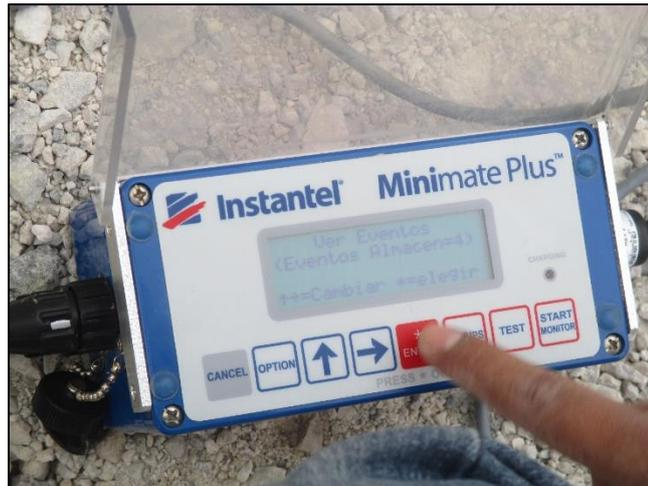
Los geófonos triaxiales utilizados fueron de origen canadiense con una resistencia de 106 (Ohm) de 8 canales de frecuencia para campo cercano, a una sensibilidad de 0.0008057 (v/mm).
