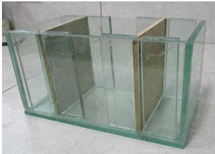
Fotografía 06: Reactor ensamblado para proceso de remediación de suelos utilizada en la presente investigación.
