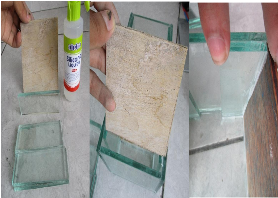
Fotografía 13: Accesorios necesarios para construcción de rector de remediación de suelo.
