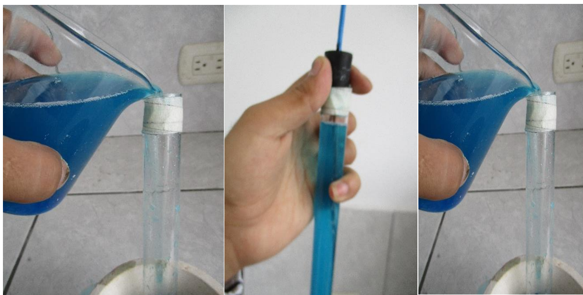
Fotografía 12: Solución saturada de sulfato de cobre; Vertido de solución de sulfato; Obtención de electrodo de referencia.
