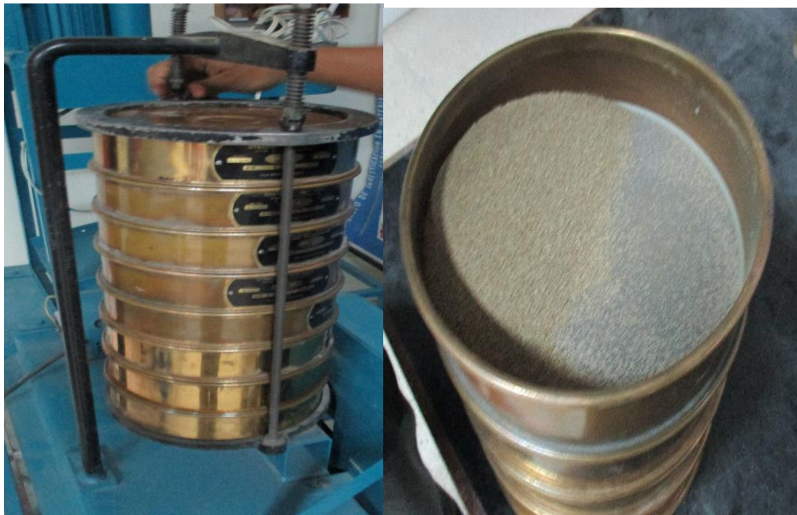
Fotografía 09: Proceso de mado de muestra de suelo; separación de muestra de suelo mado.
