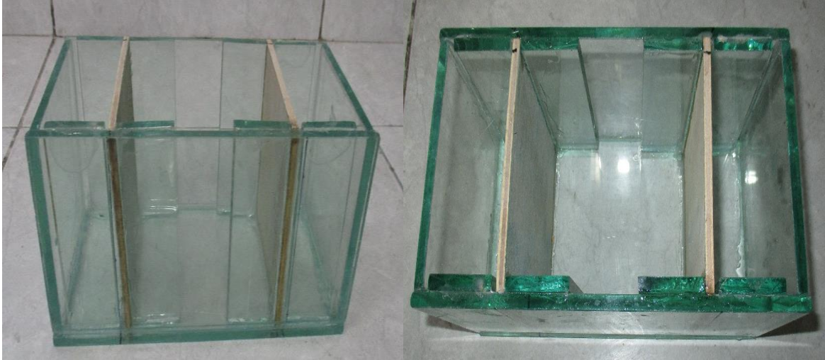
Fotografía 05: Reactor ensamblado para proceso de remediación de suelos utilizada en la presente investigación.
