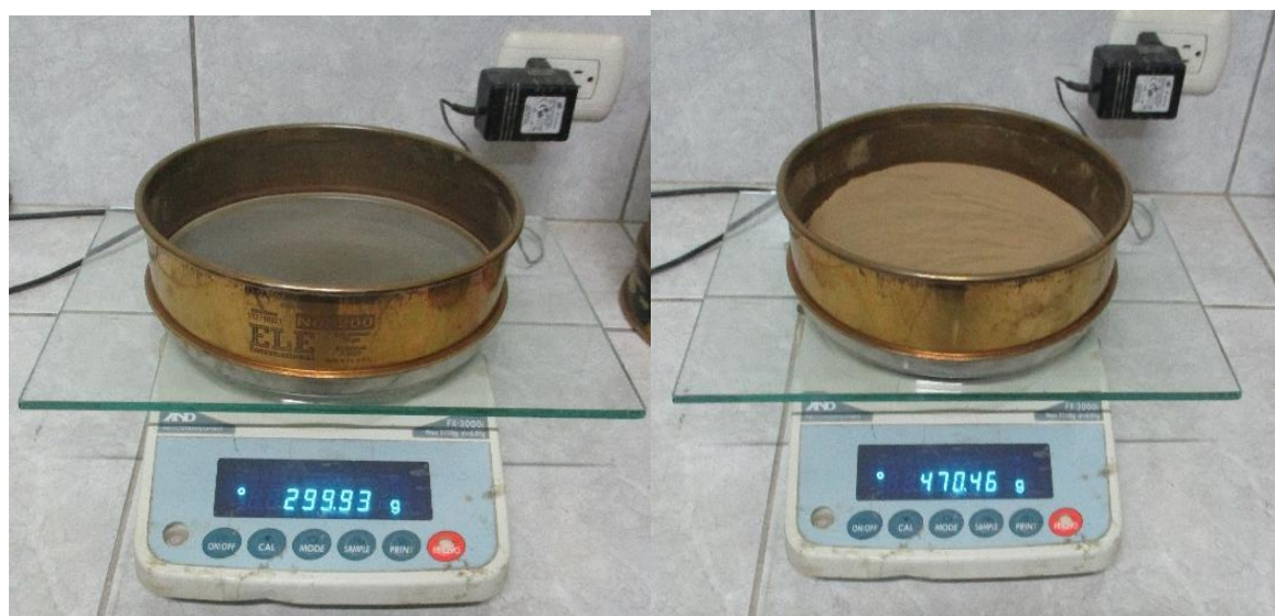
Fotografía 10: Pesado de malla sin muestra; pesado de muestra separada por mallas
