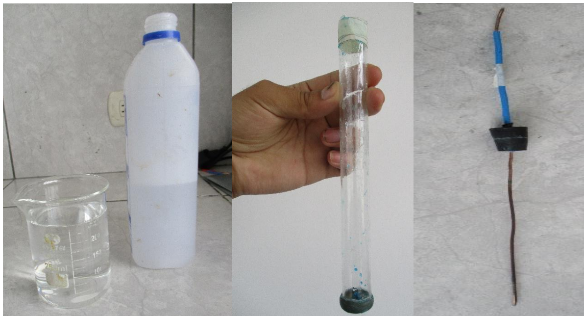
Fotografía 11: Agua destilada para preparación de electrodo de referencia; Recipiente de vidrio para electrodo; Alambre de cobre.
