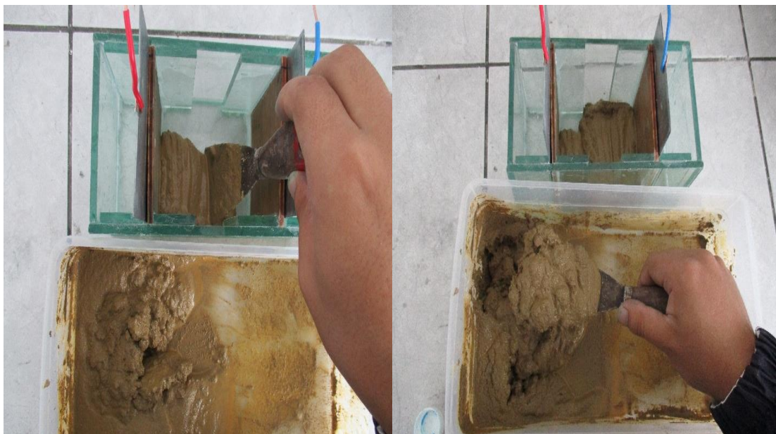
Fotografía 17: Humectación y ubicación de muestra de suelo en la celda de ensayo.
