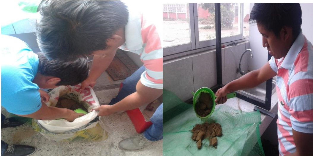
Fotografía 07: Separación y limpieza por tamizado de muestra de suelo a ensayar.
