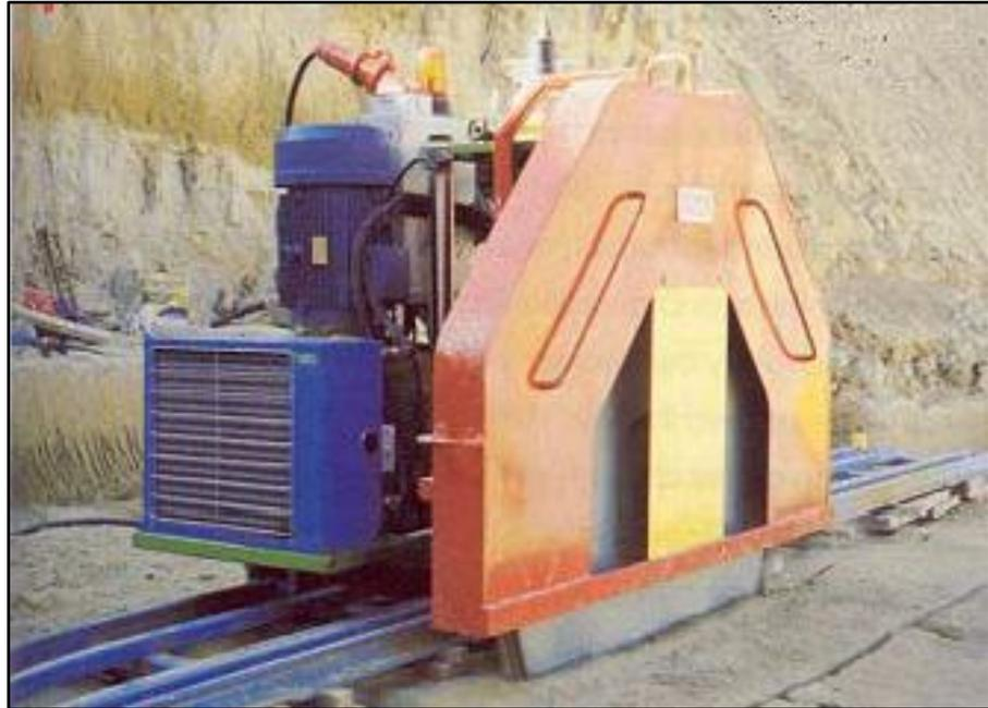
Figura N ° 8. Equipo de corte con disco sobre carretón desplazable.
