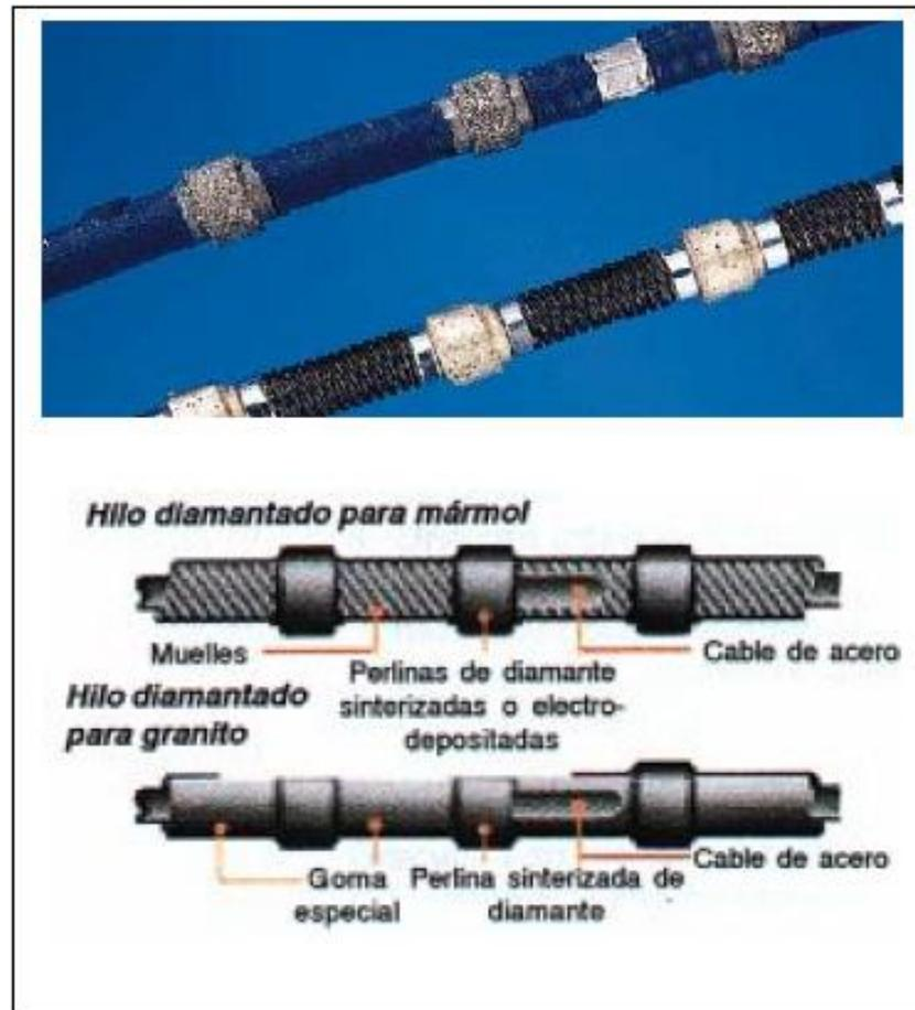
Figura N ° 5. Hilo diamantado para cortar bloques de mármol.
