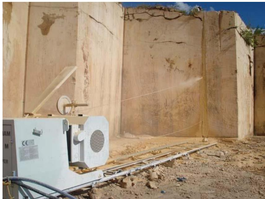
Figura N ° 4: Corte con hilo diamantado.
