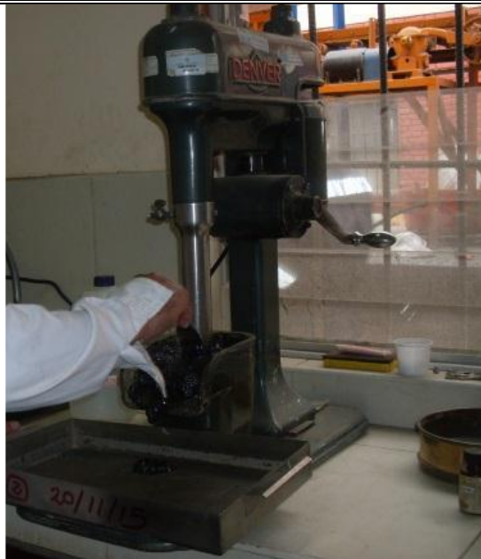
Foto N°07: Extracción del concentrado de oro y plata en celda DENVER
