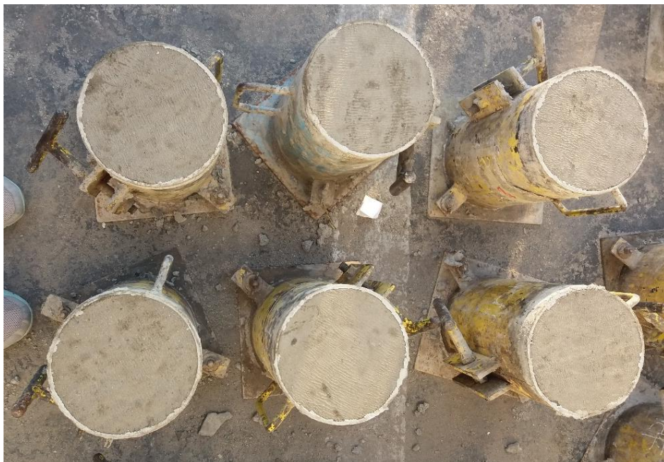
Figura 5.34: Probetas Cilíndricas de Concreto
