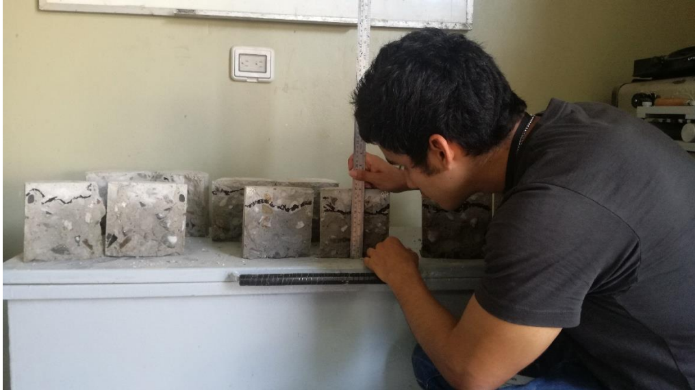
Figura 5.61: Medición de Penetración de Agua en la Probetas
