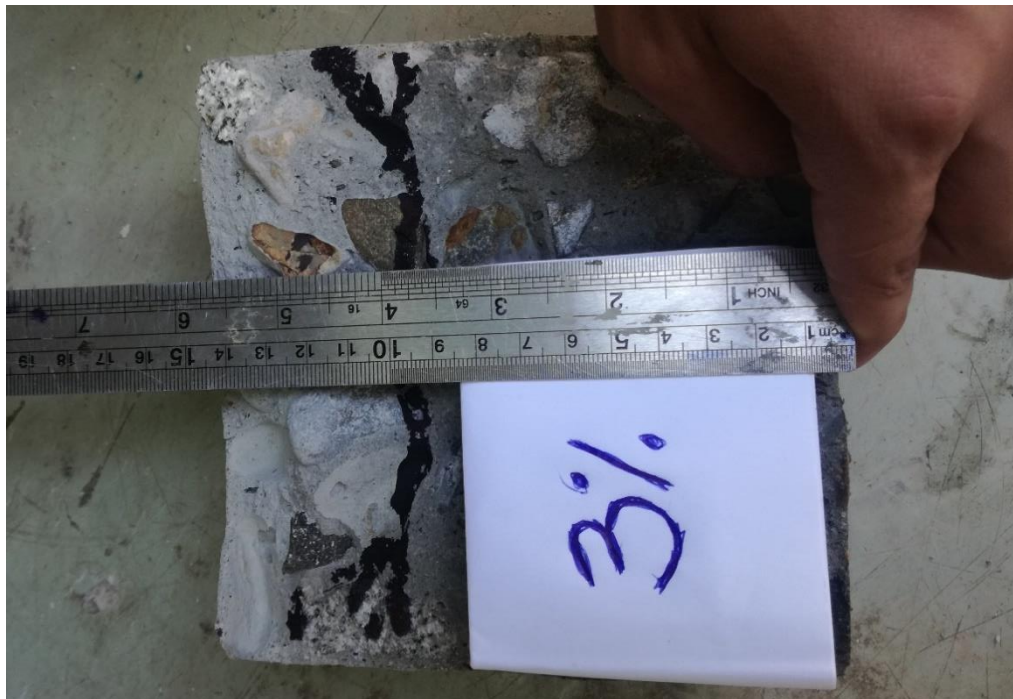
Figura 5.64: Resultado del Ensayo a la Permeabilidad de la Muestra Patrón + 3% Ceniza Volante
