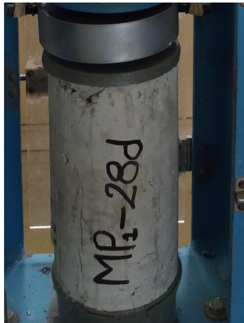
Figura 5.40: Probeta Fisurada Concreto Patrón
