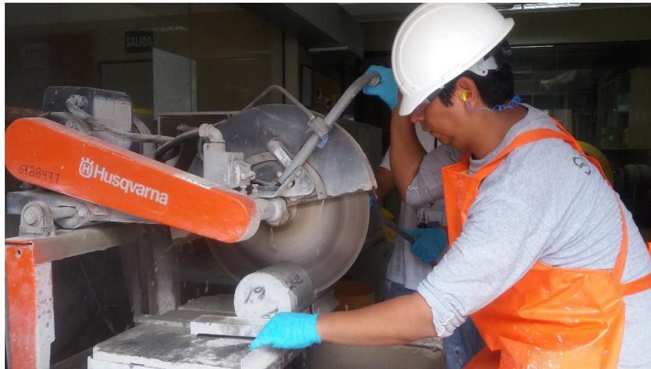
Figura 5.53: Cortado de Probetas
