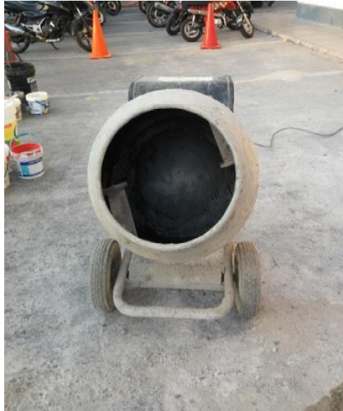
Figura 5.31: Trompo para Mezcla de Concreto
