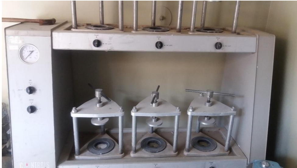
Figura 5.55: Máquina para ensayo a la Permeabilidad
