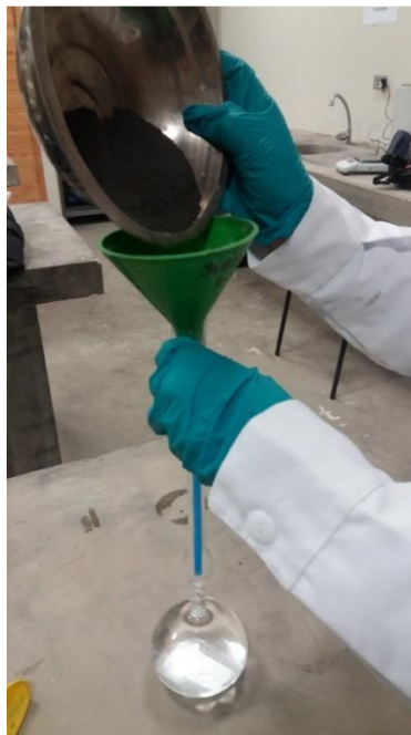
Figura 5.30: Ensayo para el Peso específico de la Ceniza Volante de Carbón
