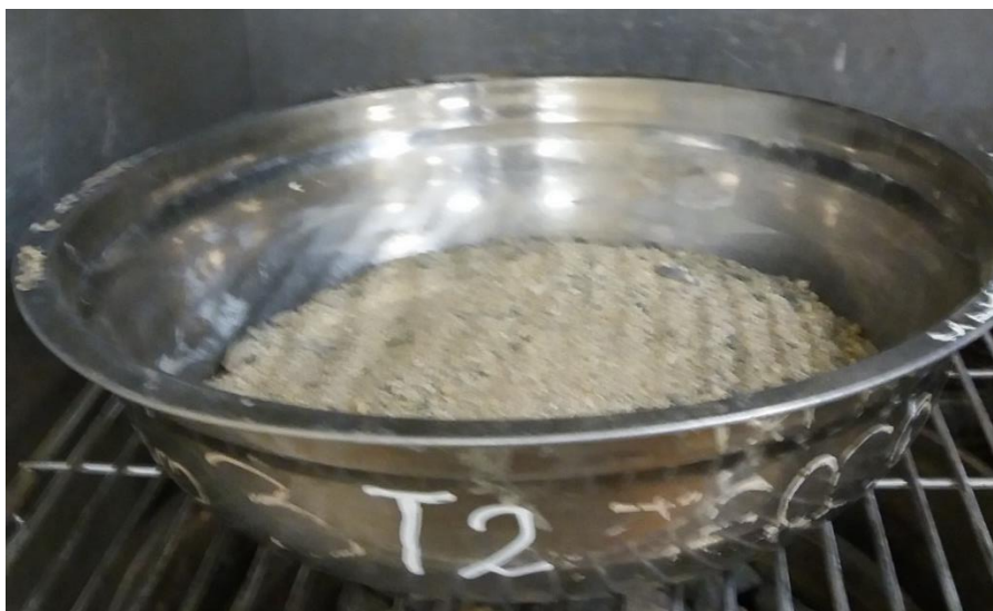
Figura 5.14: Muestra en el Horno de Agregado Fino para Contenido de Humedad
