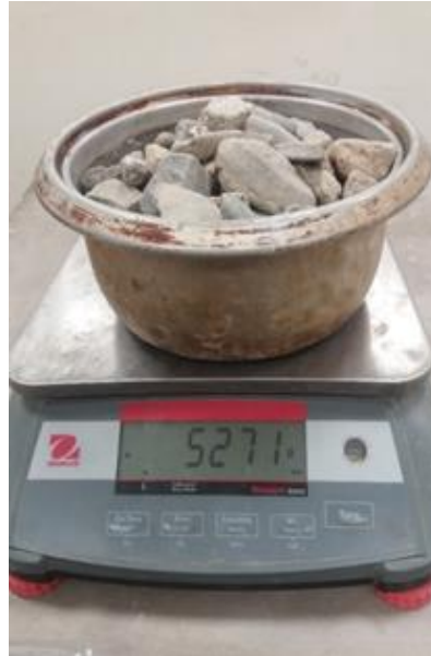
Figura 5.25: Peso del material para Ensayo Abrasión Los Ángeles
