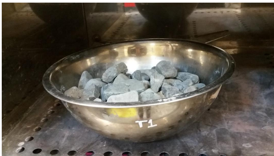
Figura 5.12: Muestra en el Horno de Agregado Grueso para Contenido de Humedad
