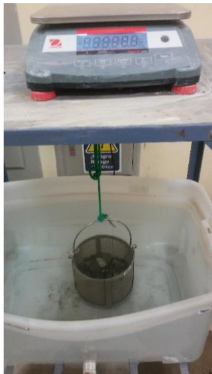
Figura 5.16: Peso Sumergido del Agregado Grueso
