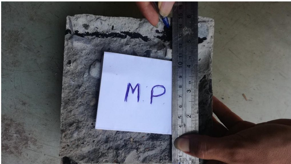
Figura 5.62: Resultado del Ensayo a la Permeabilidad de la Muestra Patrón
