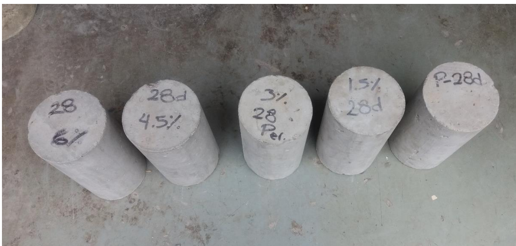
Figura 5.50: Probetas Para el Ensayo de la Permeabilidad
