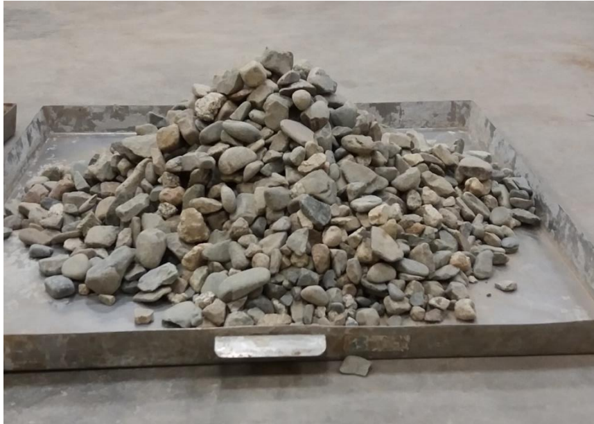
Figura 5.7: Muestra del Agregado Grueso
