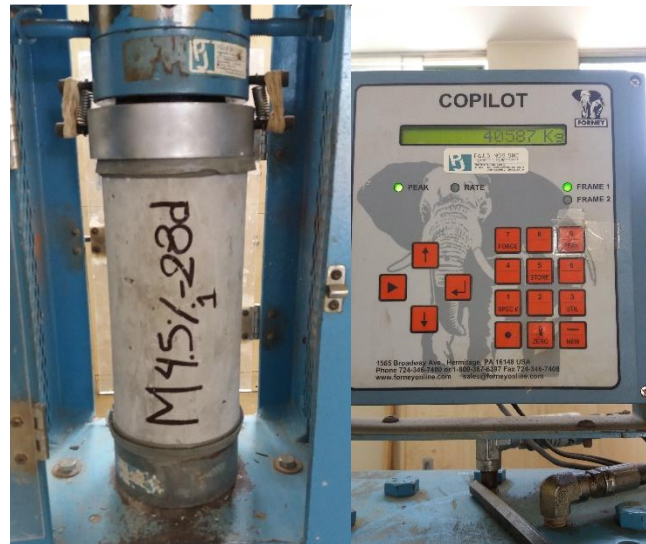
Figura 5.45: Ensayo a la Compresión de Concreto Patrón + 4.5% de Ceniza Volante
