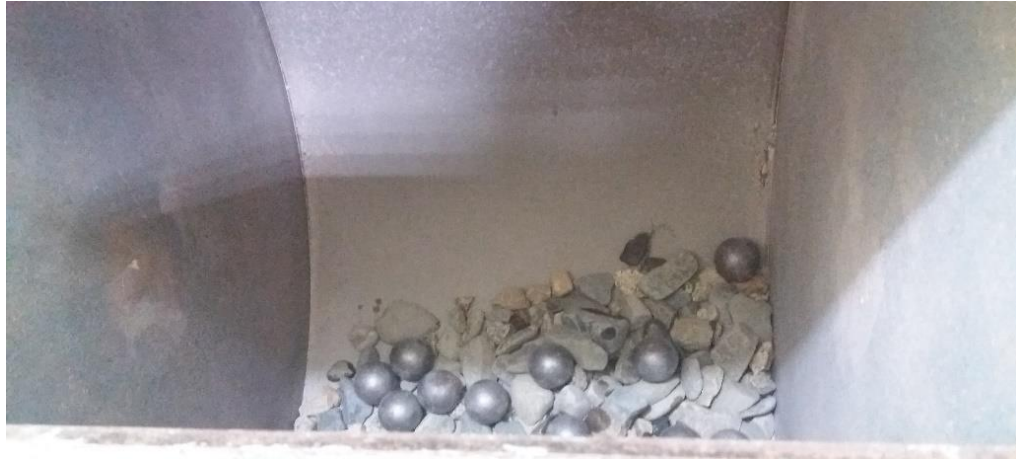
Figura 5.27: Ensayo Abrasión Los Ángeles
