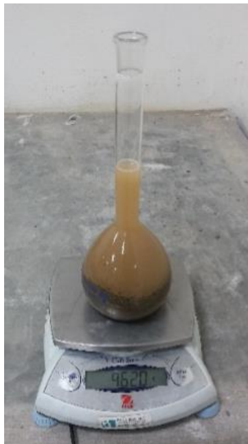
Figura 5.24: Peso del Picnómetro con Masa y Agua
