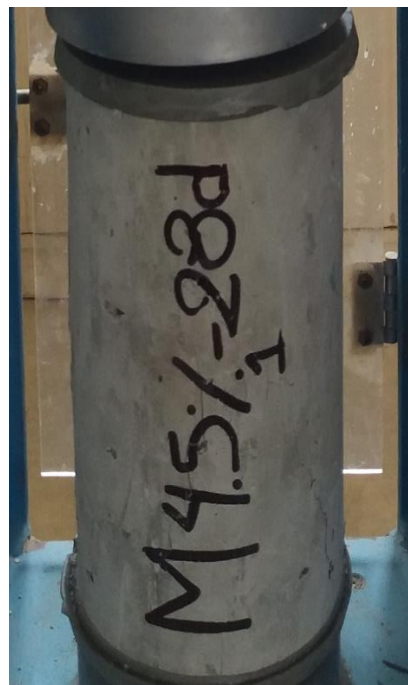
Figura 5.46: Probeta Fisurada Concreto Patrón + 4.5% de Ceniza Volante
