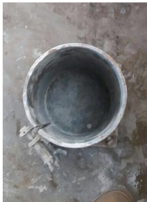
Figura 5.32: Molde de Probeta Cilíndrica (0.15m x 0.30m)
