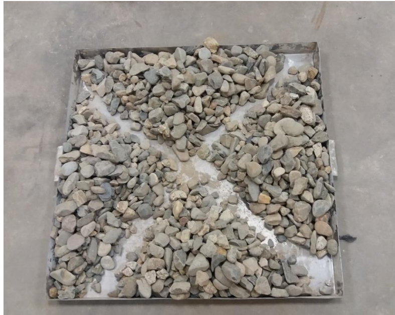
Figura 5.9: Cuarteo del Agregado Grueso
