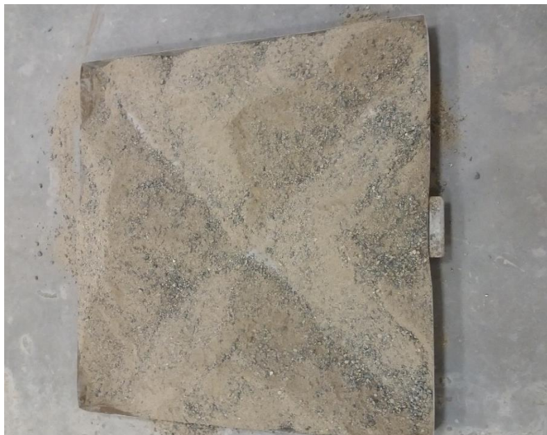
Figura 5.10: Cuarteo del Agregado Fino
