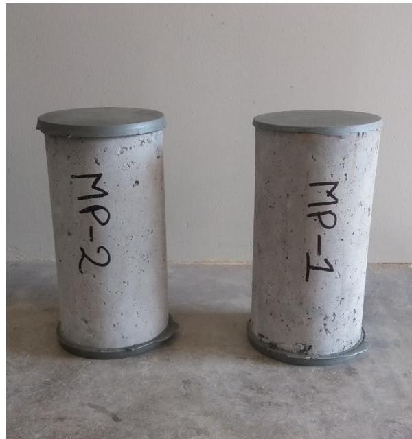
Figura 5.38: Probetas de Concreto Capeadas
