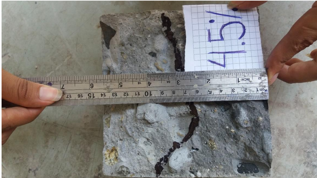
Figura 5.65: Resultado del Ensayo a la Permeabilidad de la Muestra Patrón + 4.5% Ceniza Volante
