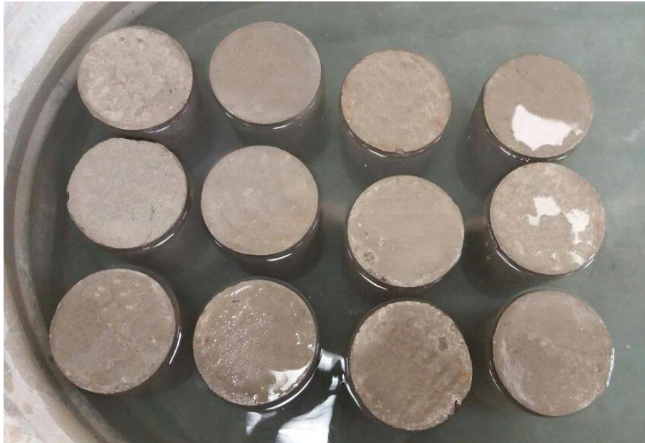
Figura 5.35: Curado de Probetas Cilíndricas de Concreto
