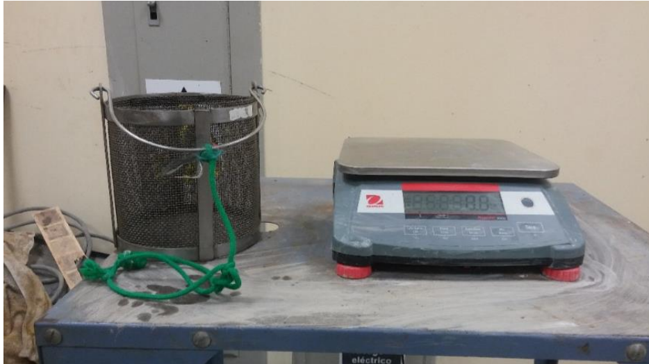
Figura 5.15: Materiales para el Peso Específico del Agregado Grueso
