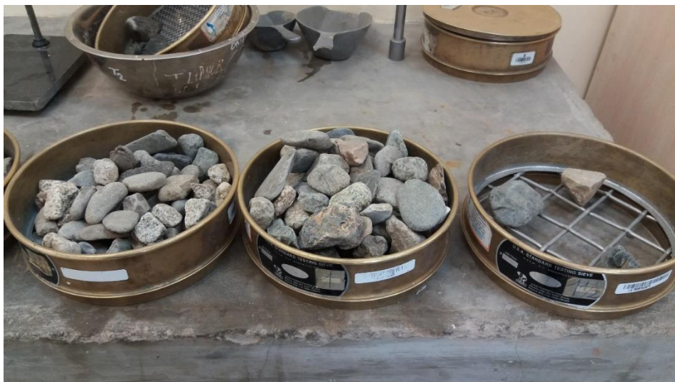
Figura 5.18: Tamizado del Agregado Grueso
