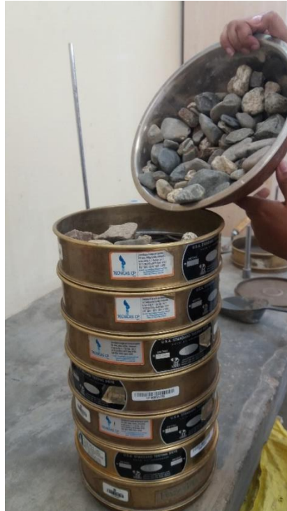
Figura 5.17: Granulometría del Agregado Grueso
