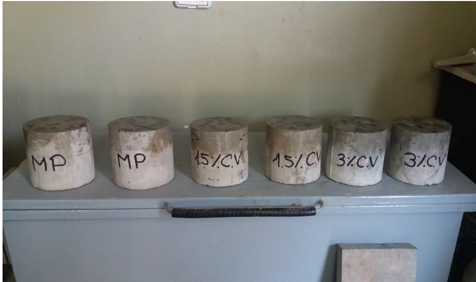
Figura 5.59: Probetas después de permanecer bajo presión de agua
