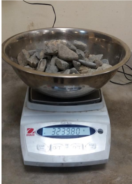
Figura 5.11: Peso de Agregado Grueso para Contenido de Humedad
