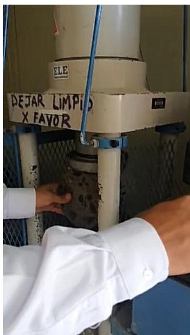
Figura 5.60: Rotura de Probeta bajo Tracción Indirecta
