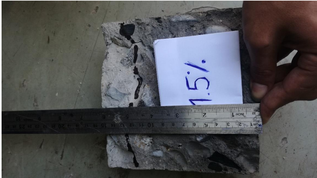
Figura 5.63: Resultado del Ensayo a la Permeabilidad de la Muestra Patrón + 1.5% Ceniza Volante
