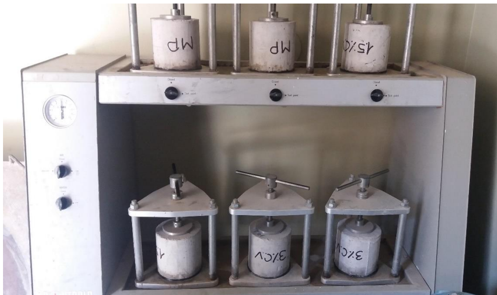
Figura 5.56: Probetas Ensayadas a Permeabilidad
