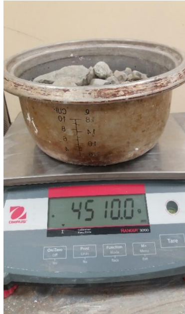
Figura 5.29: Peso Final del Desgaste por Abrasión
