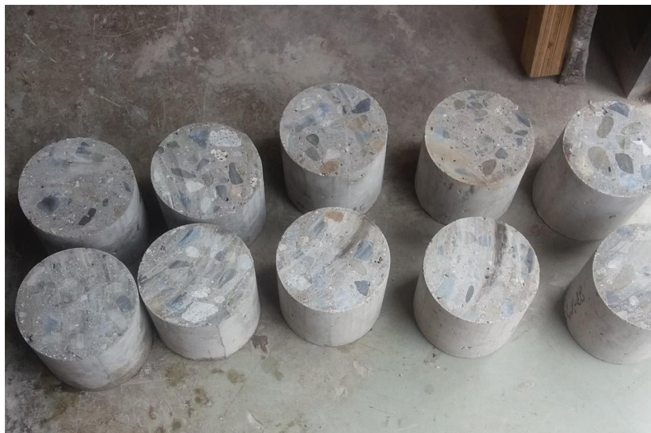
Figura 5.54: Probetas Adaptadas para la máquina de Permeabilidad
