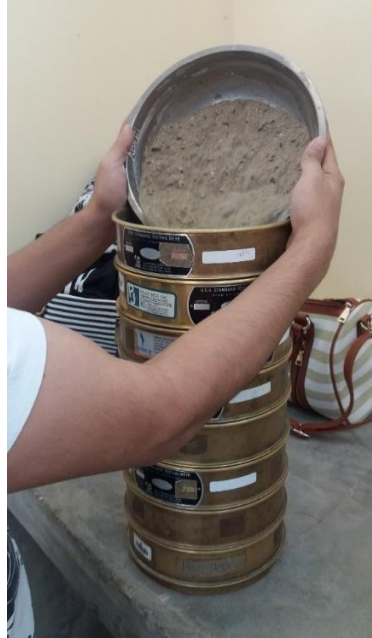
Figura 5.19: Granulometría del Agregado Grueso
