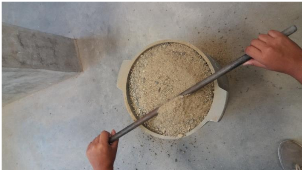
Figura 5.22: Peso Unitario del Agregado Fino
