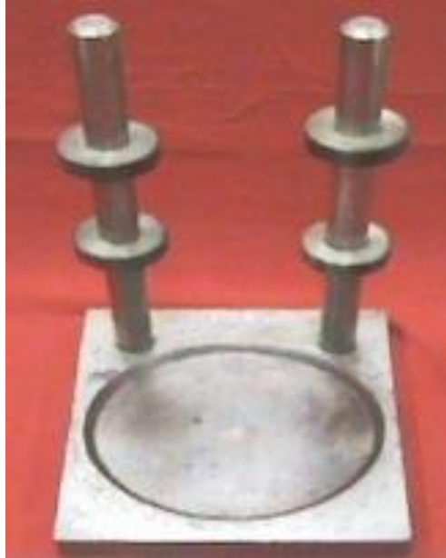
Figura 5.37: Dispositivo de alineación para Capeado de Probetas
