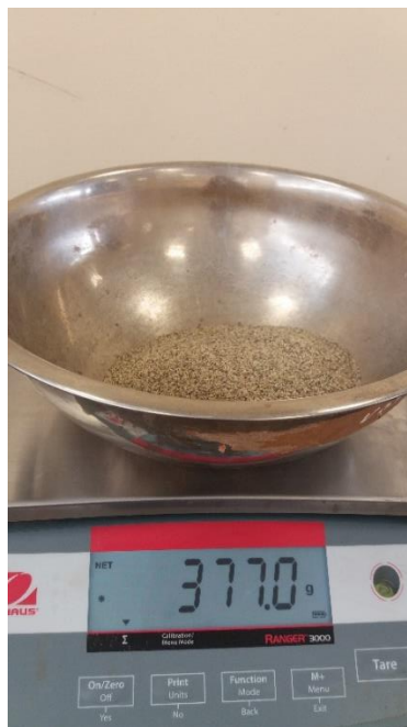
Figura 5.20: Peso del Agregado Fino Tamizado
