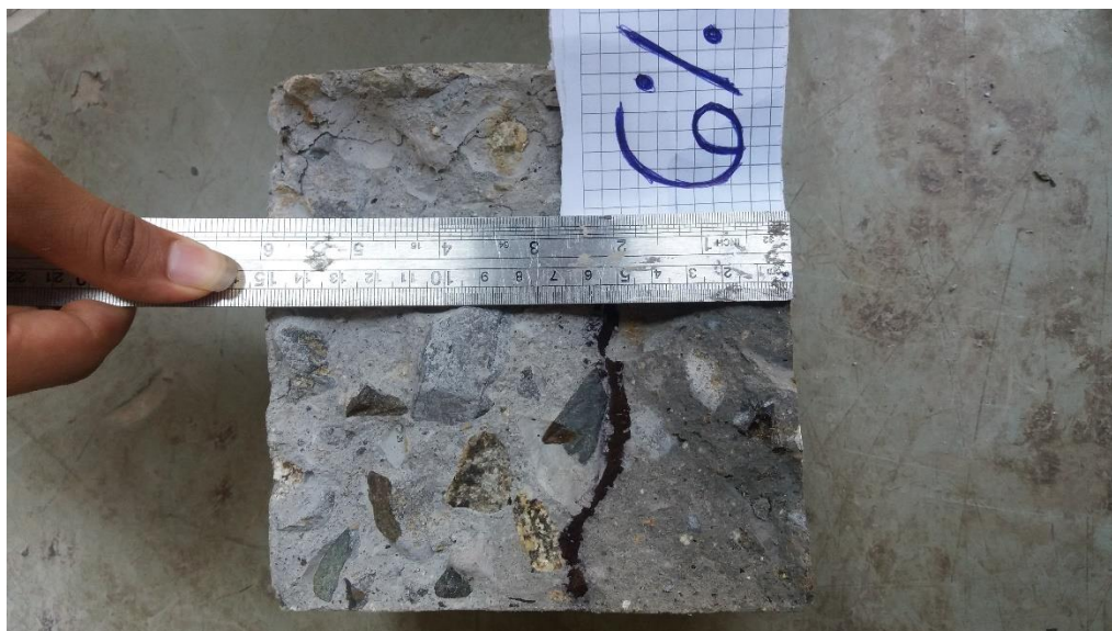
Figura 5.66: Resultado del Ensayo a la Permeabilidad de la Muestra Patrón + 6% Ceniza Volante
