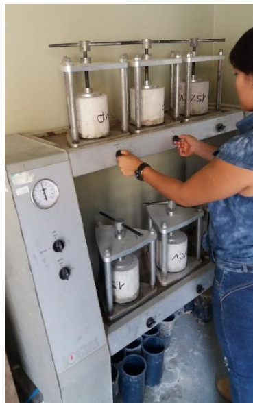
Figura 5.58: Abriendo pase de agua para cada Probeta
