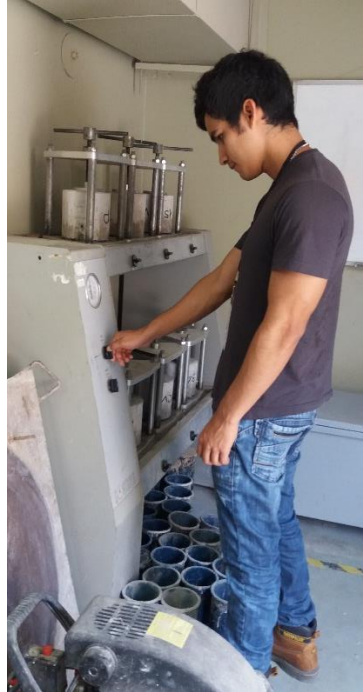
Figura 5.57: Control de Presión Constante de Agua
