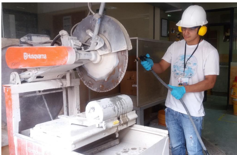
Figura 5.52: Máquina para cortar las Probetas
