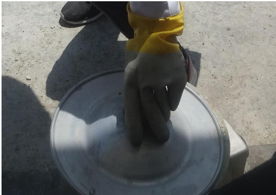
Figura 5.36: Recipiente para calentar el compuesto para el Capeado de Probetas
