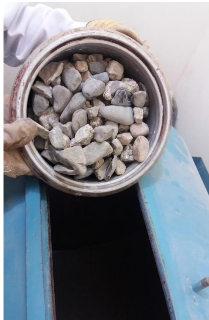
Figura 5.26: Vaciado del material en máquina de Ensayo Abrasión Los Ángeles
