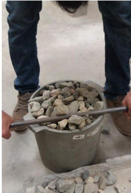
Figura 5.21: Peso Unitario del Agregado Grueso
