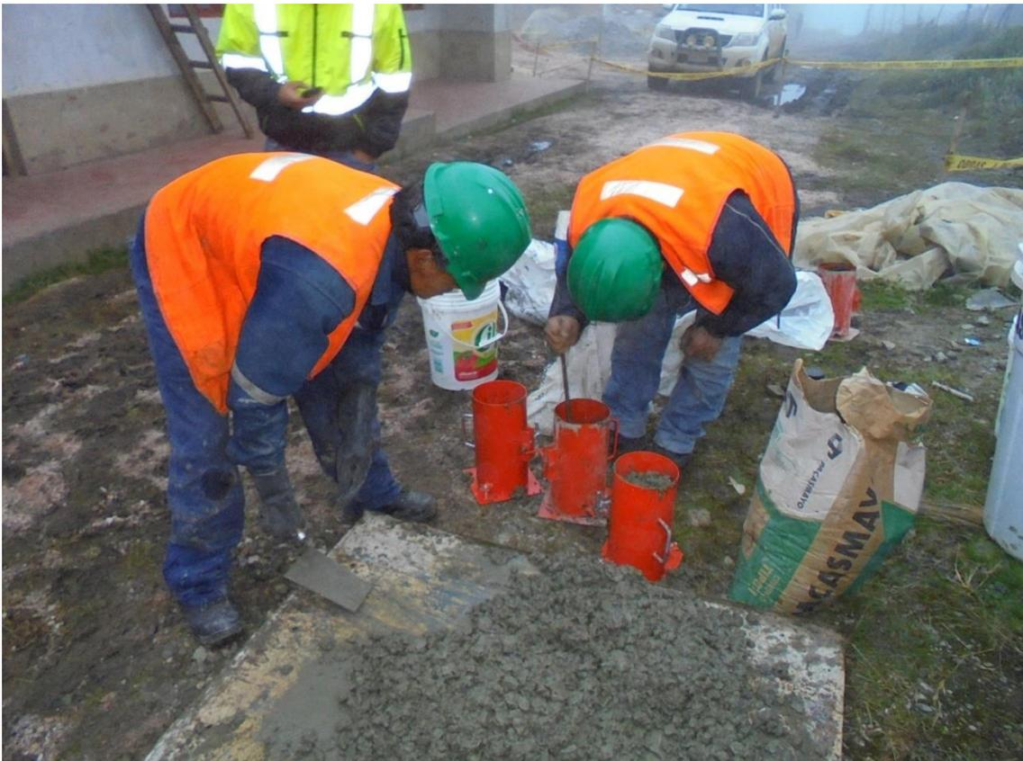
**Probando la resistencia del material a usar en la construcción del reservorio de agua**
