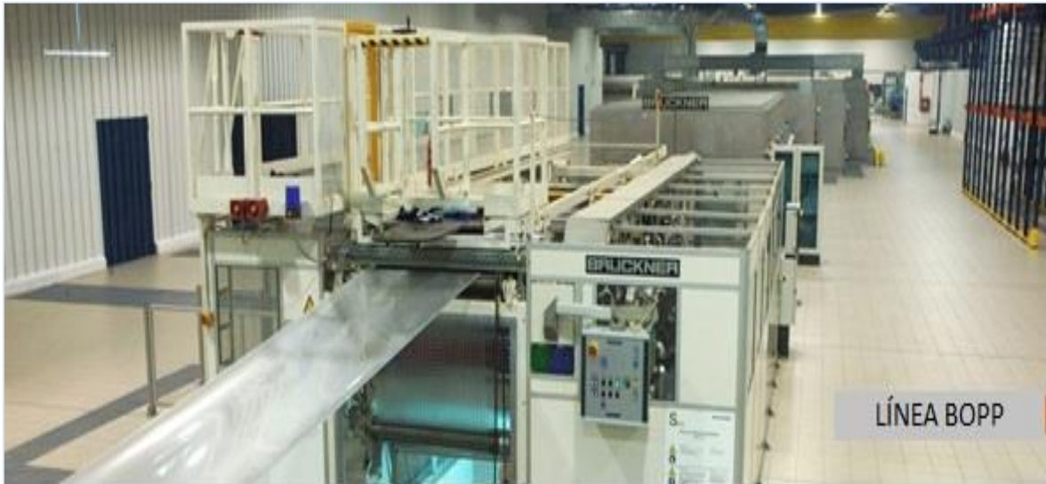
Figura n.º 2. Línea de polipropileno bi-orientado Fuente: Opp Film.
