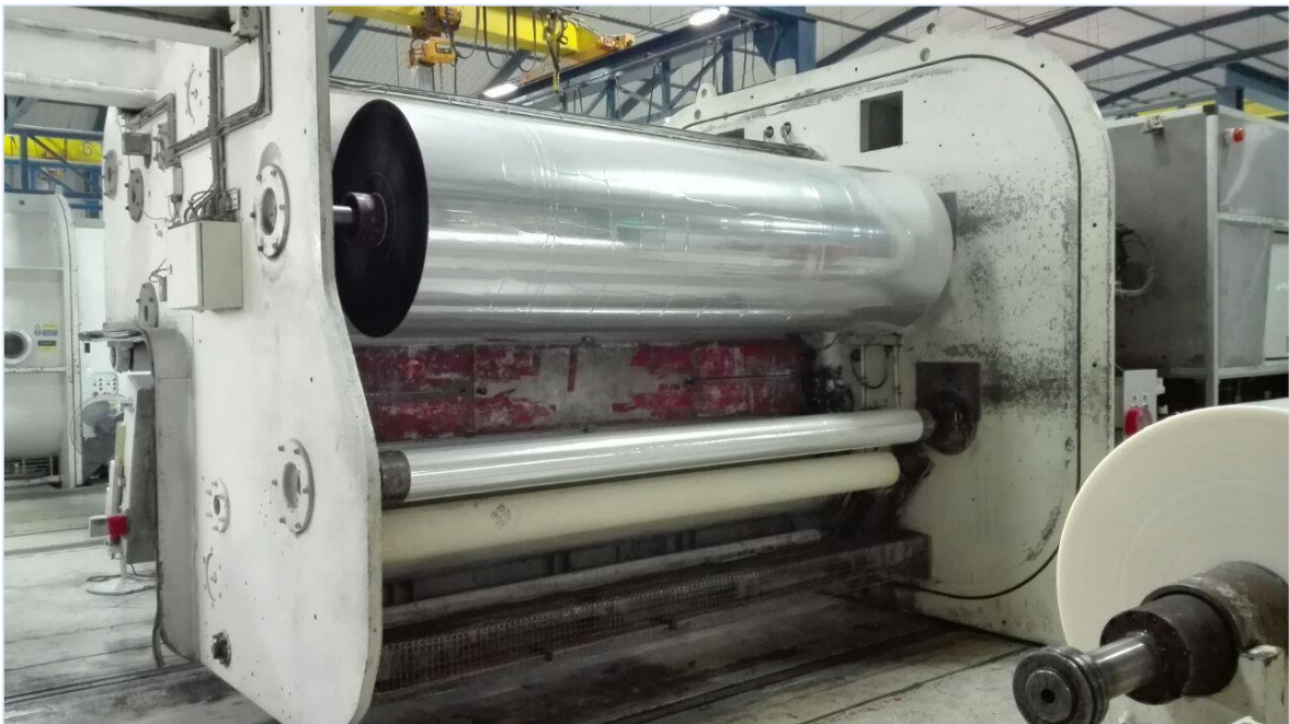
Figura n.º 3. Metalizadora bi-orientado. Fuente: Opp Film.
