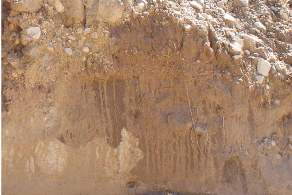
*Figura 17: Corte estratigráfico de un talud de la Gravera Shudal para identificar las terrazas de tipo coluvial.*
