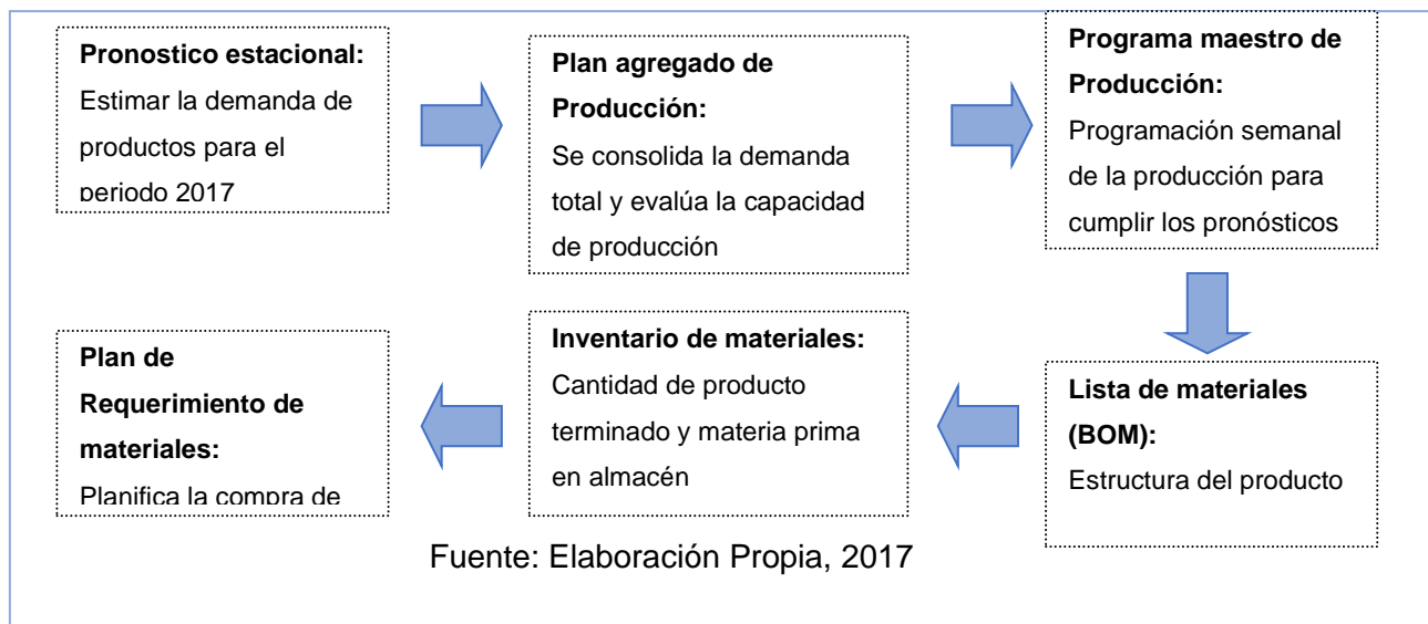
Figura N°31: Proceso de ejecución del sistema MRP
