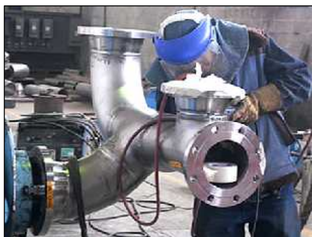
Figura 15. Proceso de soldadura GTAW.
