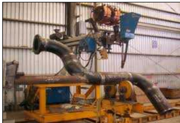
Figura 17. Proceso de Soldadura de Arco sumergido.
