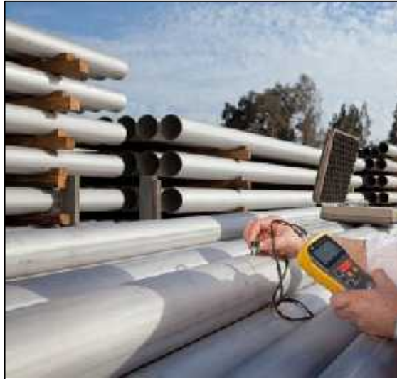
Figura 18. Inspección de material de spool.
