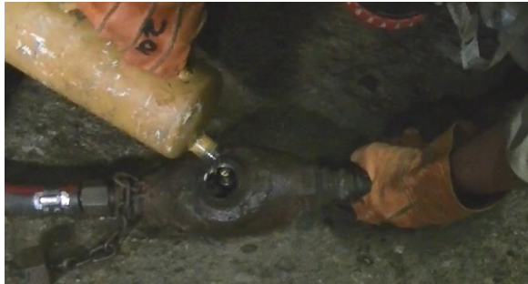
Fig. N° 10: Llenado de aceite al nivel señalado de la lubricadora
