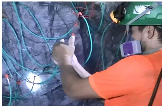
Fig. N° 27: El perforista prende la mecha
