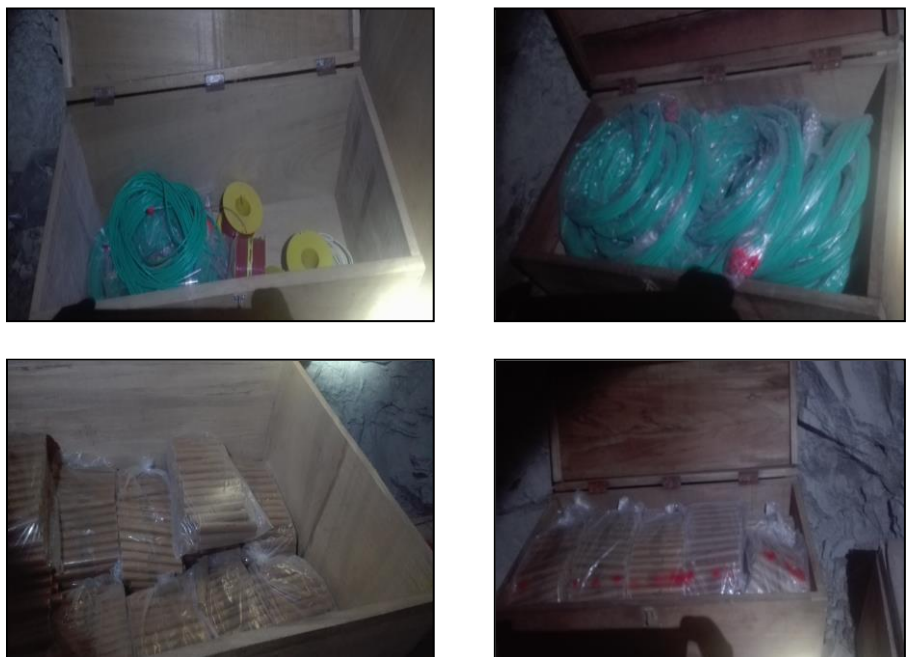
Fig. N° 34: Almacenamiento actual de los explosivos
