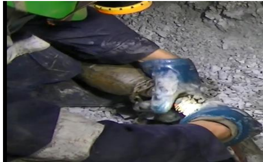
Fig. N° 12: Empatado de máquina usando grapas en ambas conexiones
