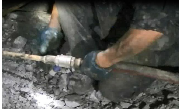
Fig. N° 20: Instalación de manguera de aire comprimido
