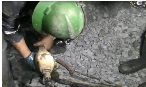
Fig. N° 19: Desempatado de mangueras de agua y aire
