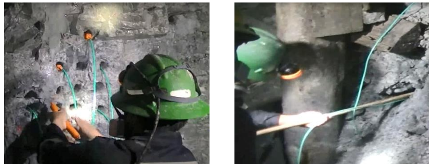
Fig. N° 23: Carguío de explosivo en los taladros
