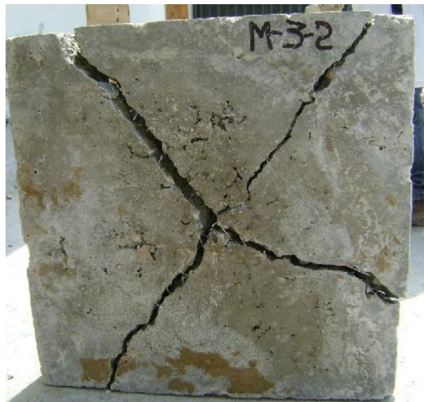
Figura 6.44. Probeta Fisurada de la M-3-2
