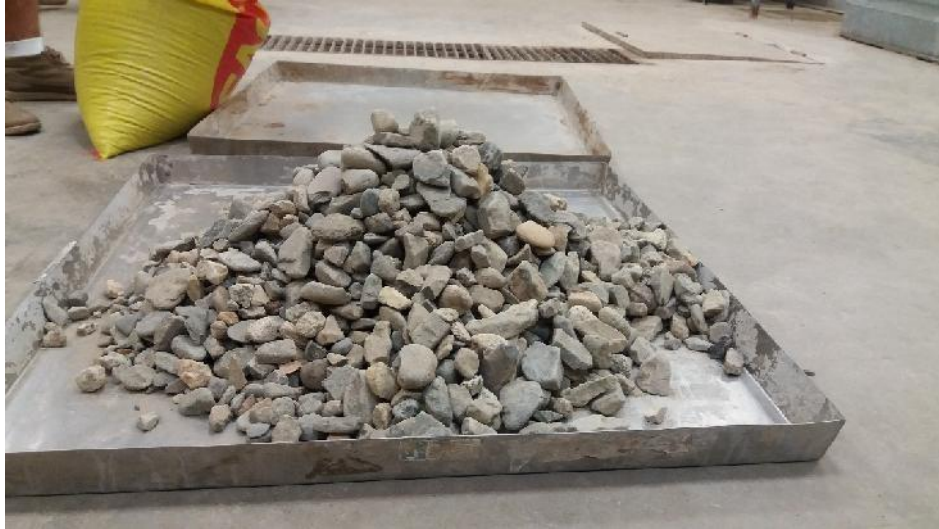
Figura 6.9. Muestra del Agregado Grueso
