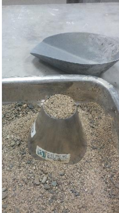
Figura 6.15. Pisonado del Agregado Fino
