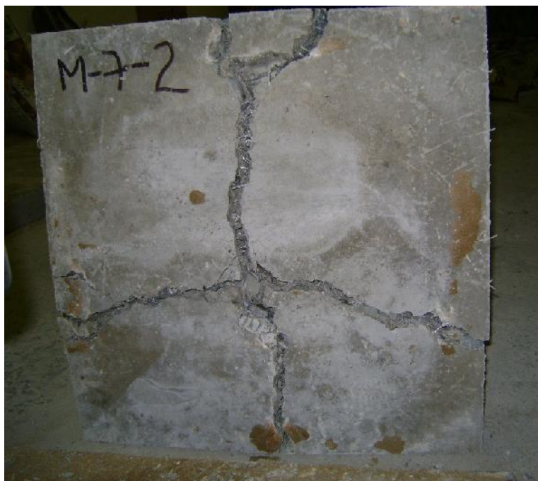
Figura 6.52. Probeta Fisurada de la M-7-2
