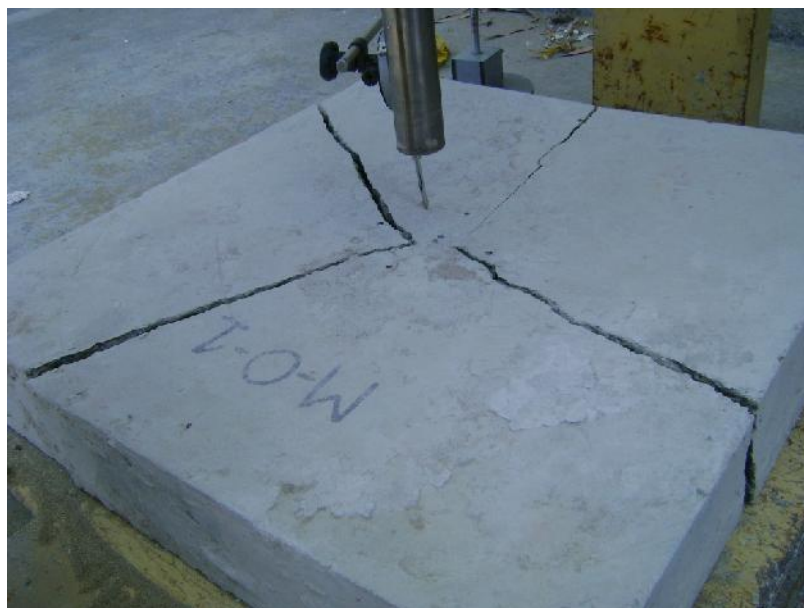
Figura 6.38. Probeta Fisurada de la M-0-1
