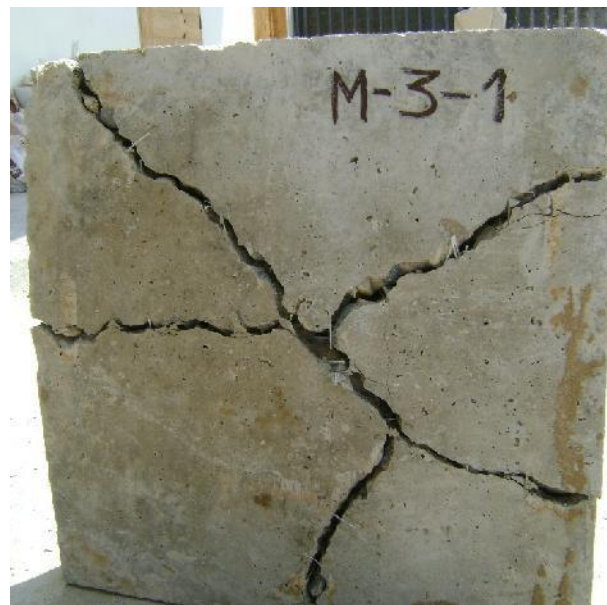
Figura 6.42. Probeta Fisurada de la M-3-1
