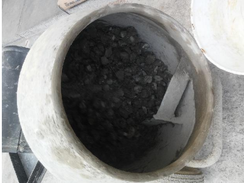
Figura 6.35. Mezcla de Concreto + Macrofibra 5 kg/m 3
