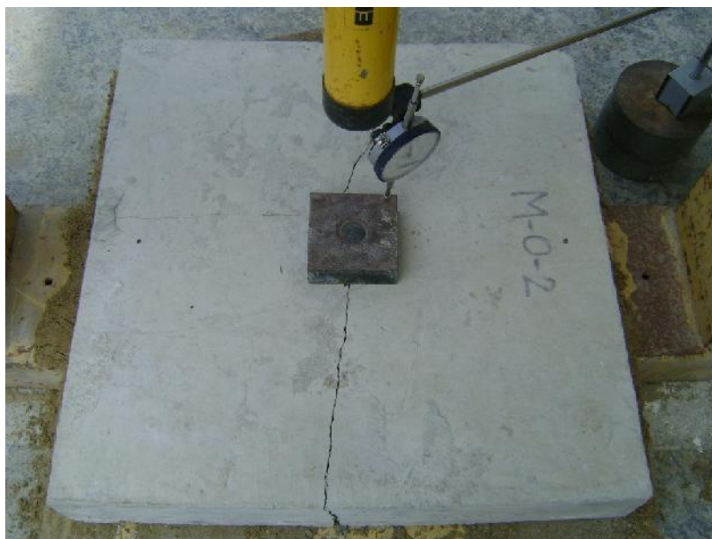
Figura 6.40. Probeta Fisurada de la M-0-2
