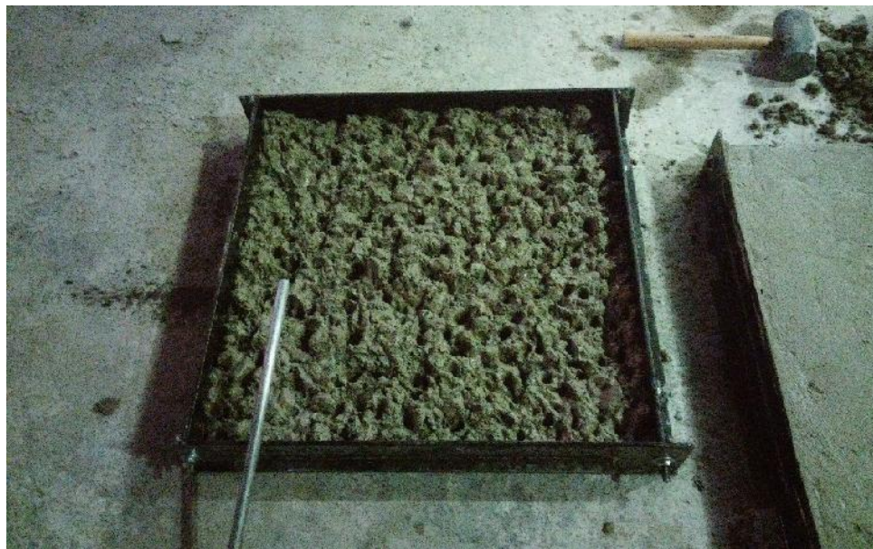
Figura 6.27. Mezcla de Concreto Patrón en las probetas
