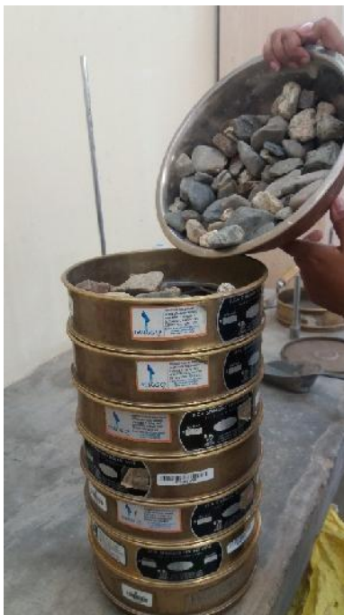
Figura 6.19. Granulometría del Agregado Grueso
