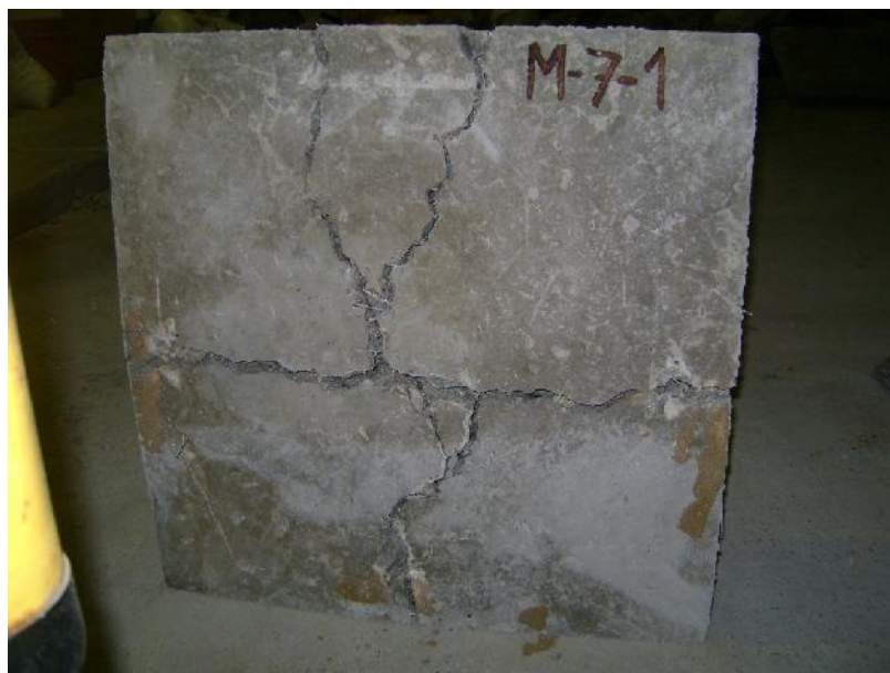
Figura 5.50. Probeta Fisurada de la M-7-1
