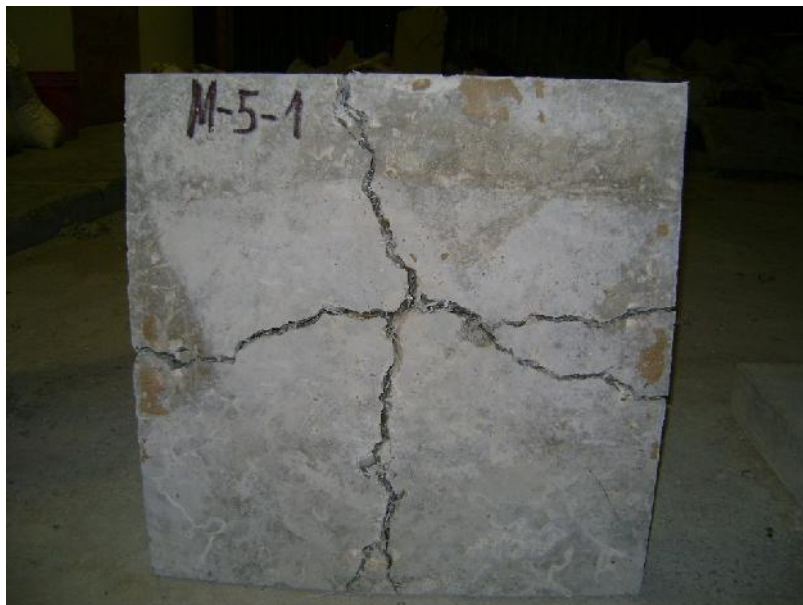
Figura 6.46. Probeta Fisurada de la M-5-1
