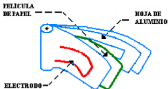
Figura n°4. Ilustración de una armadura de capacitor.
