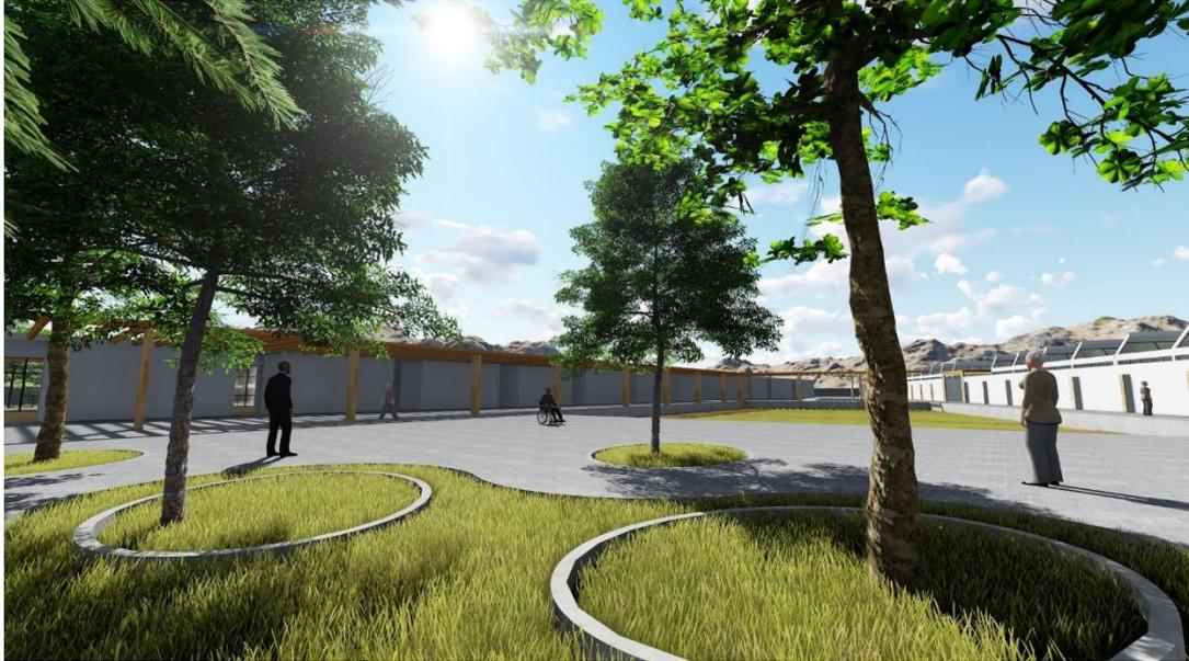
El centro utiliza pisos de adoquín, por su rugosidad, tienen una distancia de frenada menor que otros tipos de pisos, lo que se traduce en seguridad para los peatones, adecuados para el adulto mayor.
