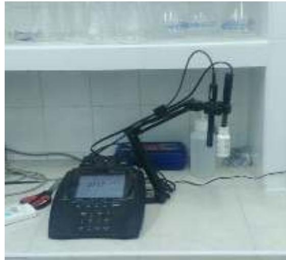
*Figura N° 54: Medición de salinidad, conductividad y sólidos suspendidos. (Propia)*
