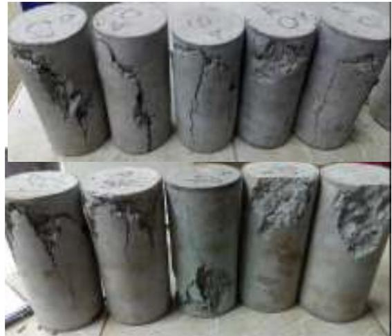
*Figura N° 66: Falla de las probetas. (Propia)*
