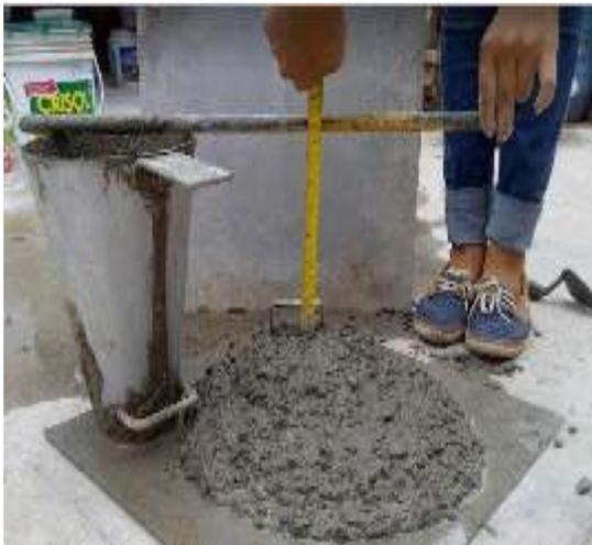
Figura N° 57: Asentamiento de mezcla patrón con plastificante. (Propia)
