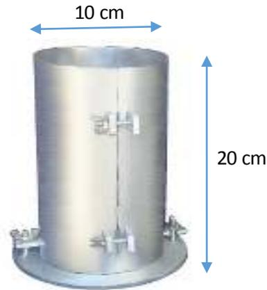
Figura N° 4: Molde para ensayar a compresión. (Propia)
