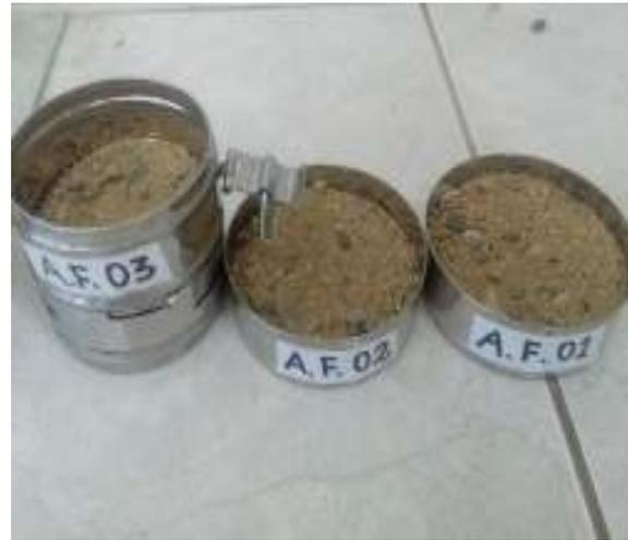
Figura N° 49: Contenido de humedad del agregado fino. (Propia)
