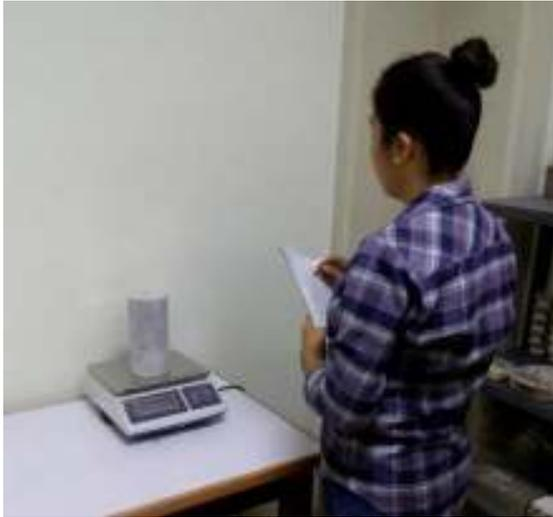
*Figura N° 63: Peso seco de la probeta. (Propia)*
