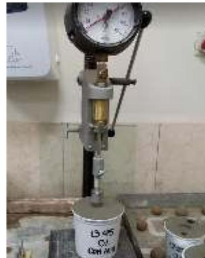
Figura N° 58: Resistencia a la penetración del concreto. (Propia)
