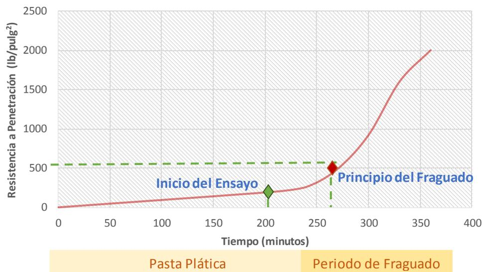
Figura N° 24: Resistencia a la penetración de la muestra patrón sp. (Propia)
