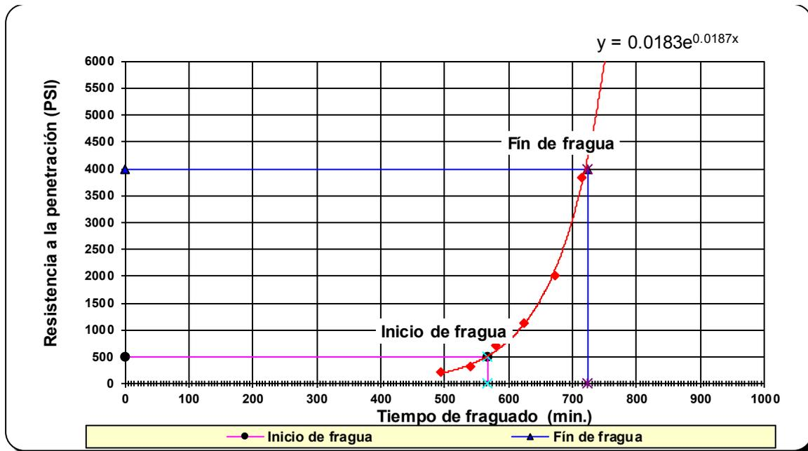
Figura N° 36: Resistencia a la penetración de muestra con súperplastificante y 3% de adición (Propia)
