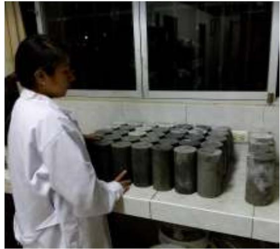
Figura N° 60: Probetas a 28 días. (Propia)
