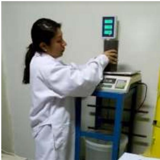
Figura N° 61: Peso saturado de la probeta. (Propia)
