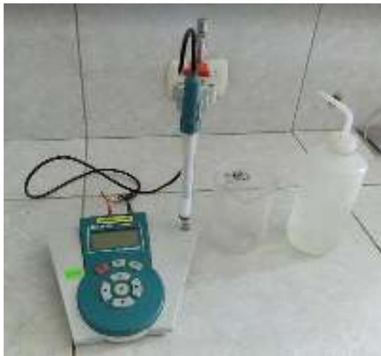
*Figura N° 53: Medición de Ph. (Propia)*
