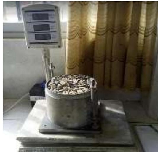
Figura N° 51: Peso suelto y compactado del agregado grueso. (Propia)
