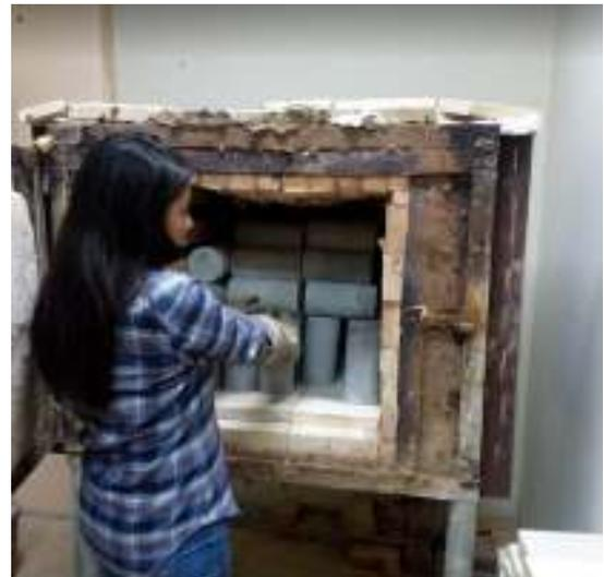
Figura N° 62: Secado al horno de las probetas. (Propia)
