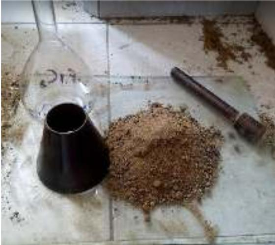
*Figura N° 52: Densidad y absorción del agregado fino. (Propia)*
