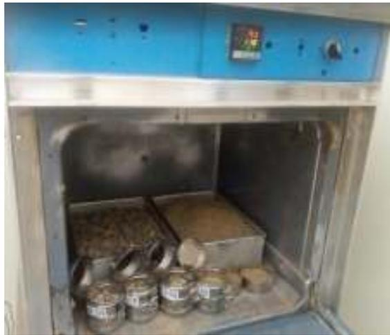
Figura N° 50: Secado de las muestras en la estufa. (Propia)
