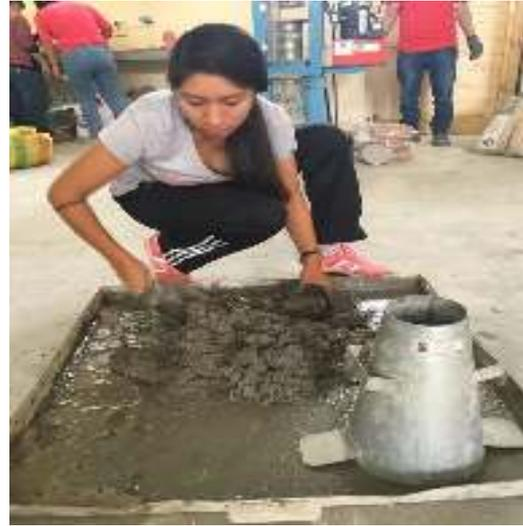
Figura N° 56: Ensayo de trabajabilidad. (Propia)
