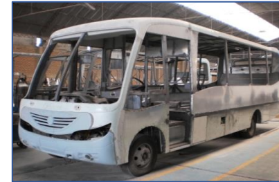
MONTAJE DE AUTOPARTES DE FIBRA DE VIDRIO
