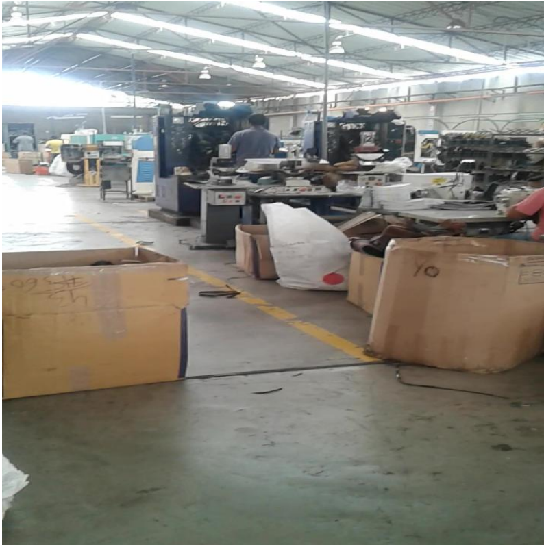
Área de perfilado: cajas en medio del pasadizo, interrumpiendo la libre circulación de obreros.
