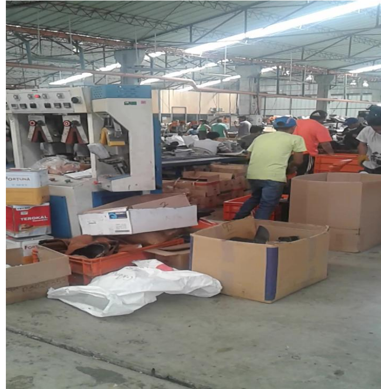
Área de perfilado, actividad conformadora de talón, puesto de trabajo desordenado cajas de aparados y latas de pegamento, terokal, mal ubicados.
