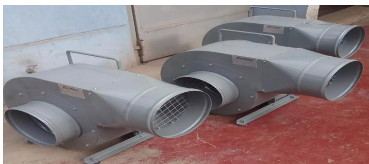
Figura N° 44 Extractores de Aire
