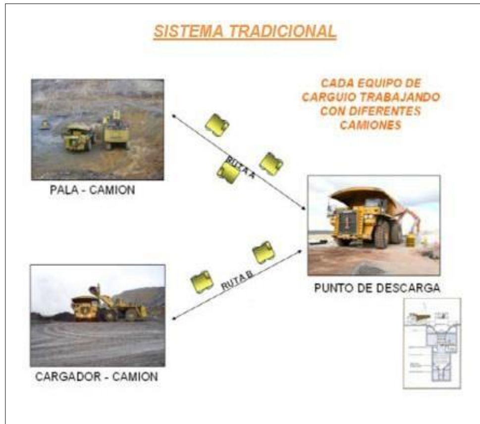
Figura N° 18. Sistema Tradicional de Carguío - Acarreo
