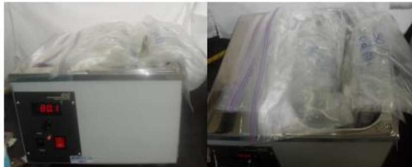
Figura 16: Celulosa en baño de calentamiento
