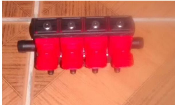
Figura n.º 20. Inyectores
