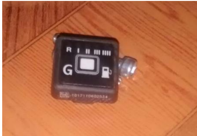
Figura n.º 9. Conmutador
