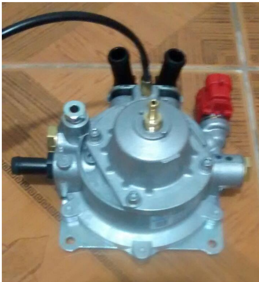
Figura n.º 17. Reductor - vaporizador GLP
