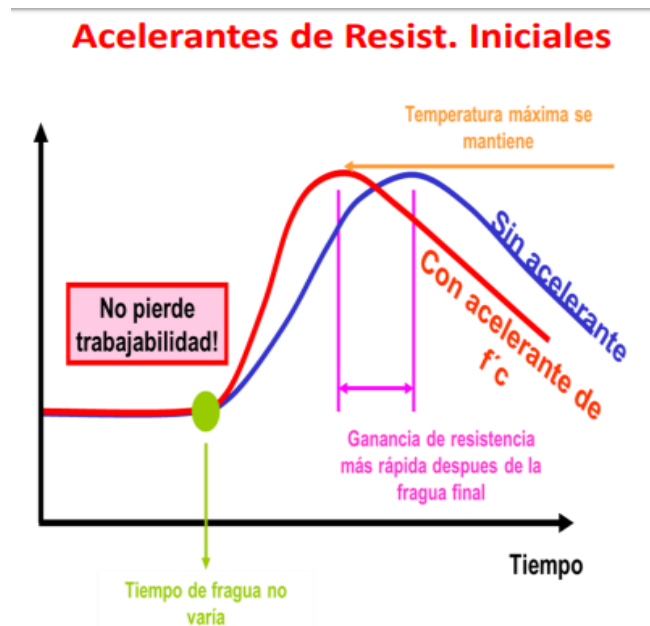
Figura 30: Modo de acción de los acelerantes de resistencias. (SIKA, 2015)
