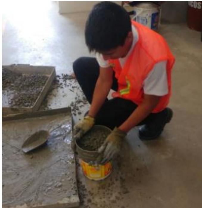
Figura 44: Elaboración y tamizado de la mezcla de concreto convencional.
