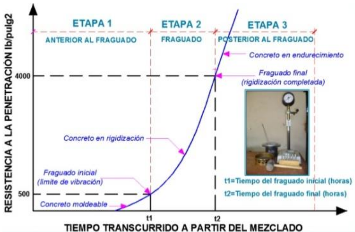
Figura 21: Etapas del fraguado en el concreto. (Beltrán Romero, George, 2016)
