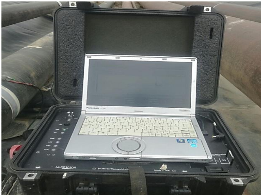
Anexo 7. Equipo de Ondas Guiadas Magnetoestructivas.
