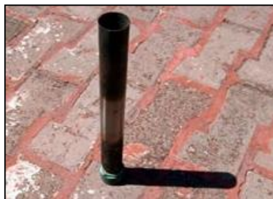
Figura N° 20: Tubo de metal de 1.5 pulgadas de diámetro exterior o broca de 1.5 pulgadas
