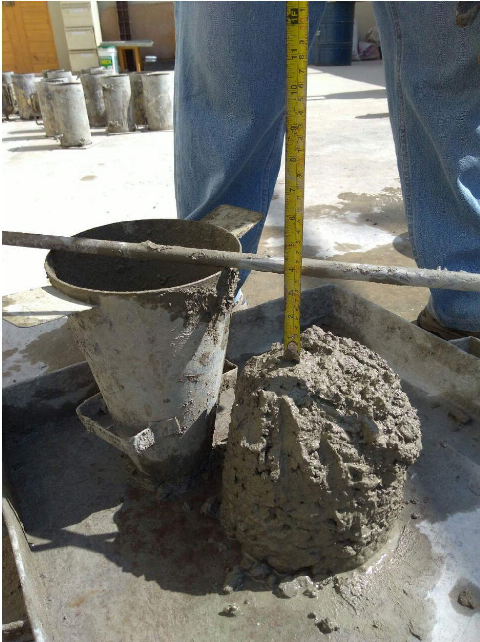
Fotografía 21: Asentamiento de 9.5 cm de la mezcla con adición de ceniza de cascarilla de arroz.
