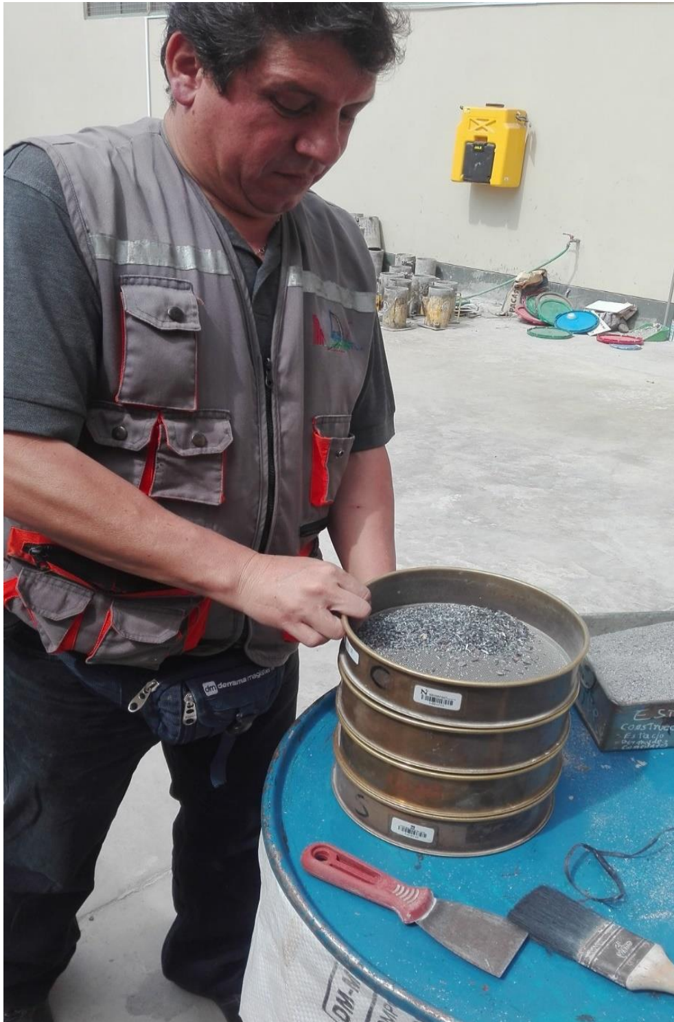
Fotografía 10: Tamizado de la ceniza de cascarilla de arroz (CCA).
