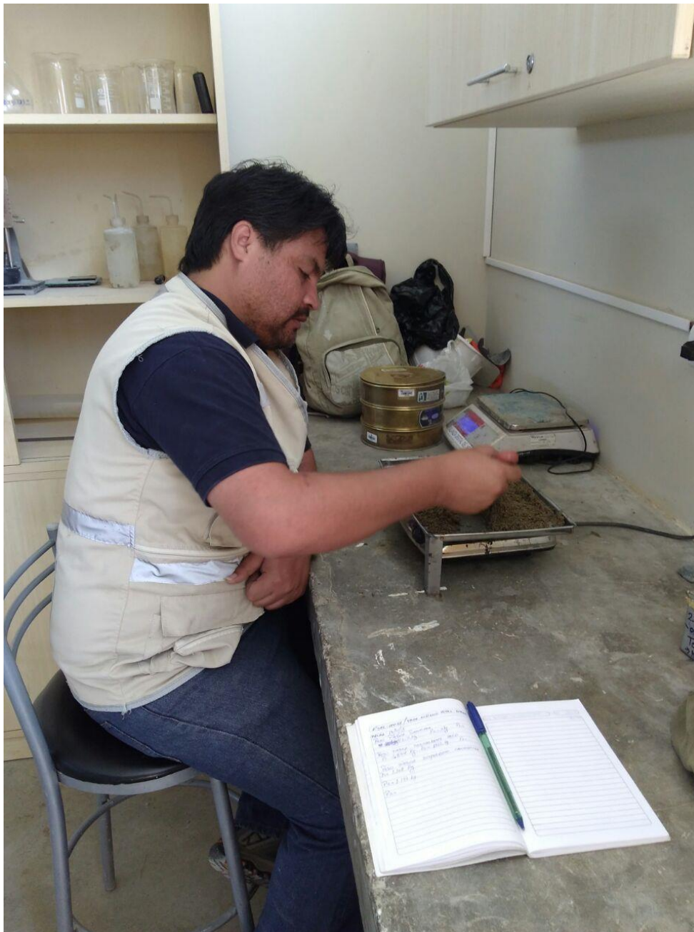
Fotografía 6: Ensayo peso específico agregado fino.
