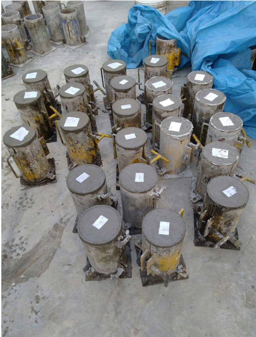
Fotografía 19: Probetas de concreto terminadas.
