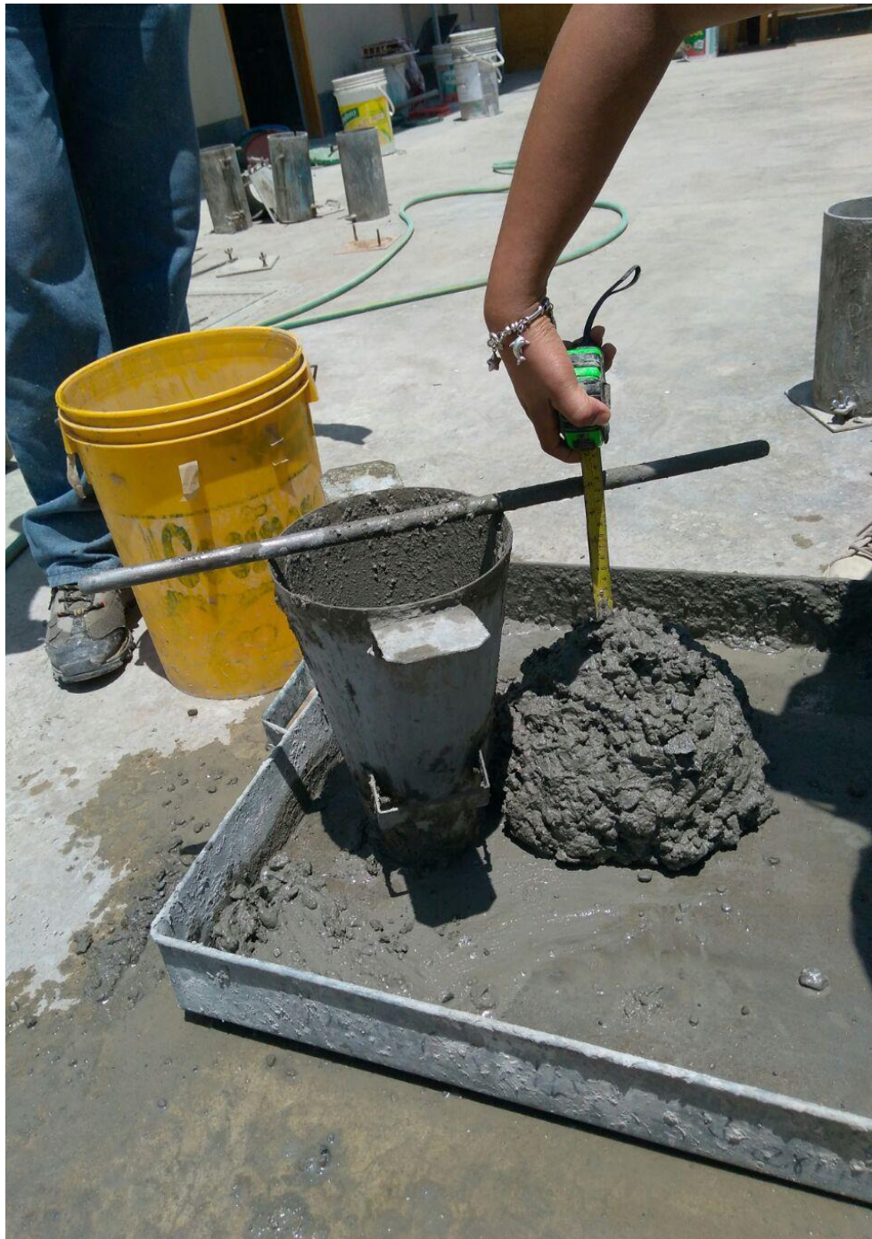
Fotografía 17: Asentamiento de 12.5 cm de la mezcla con ceniza de cascarilla de arroz (CCA).
