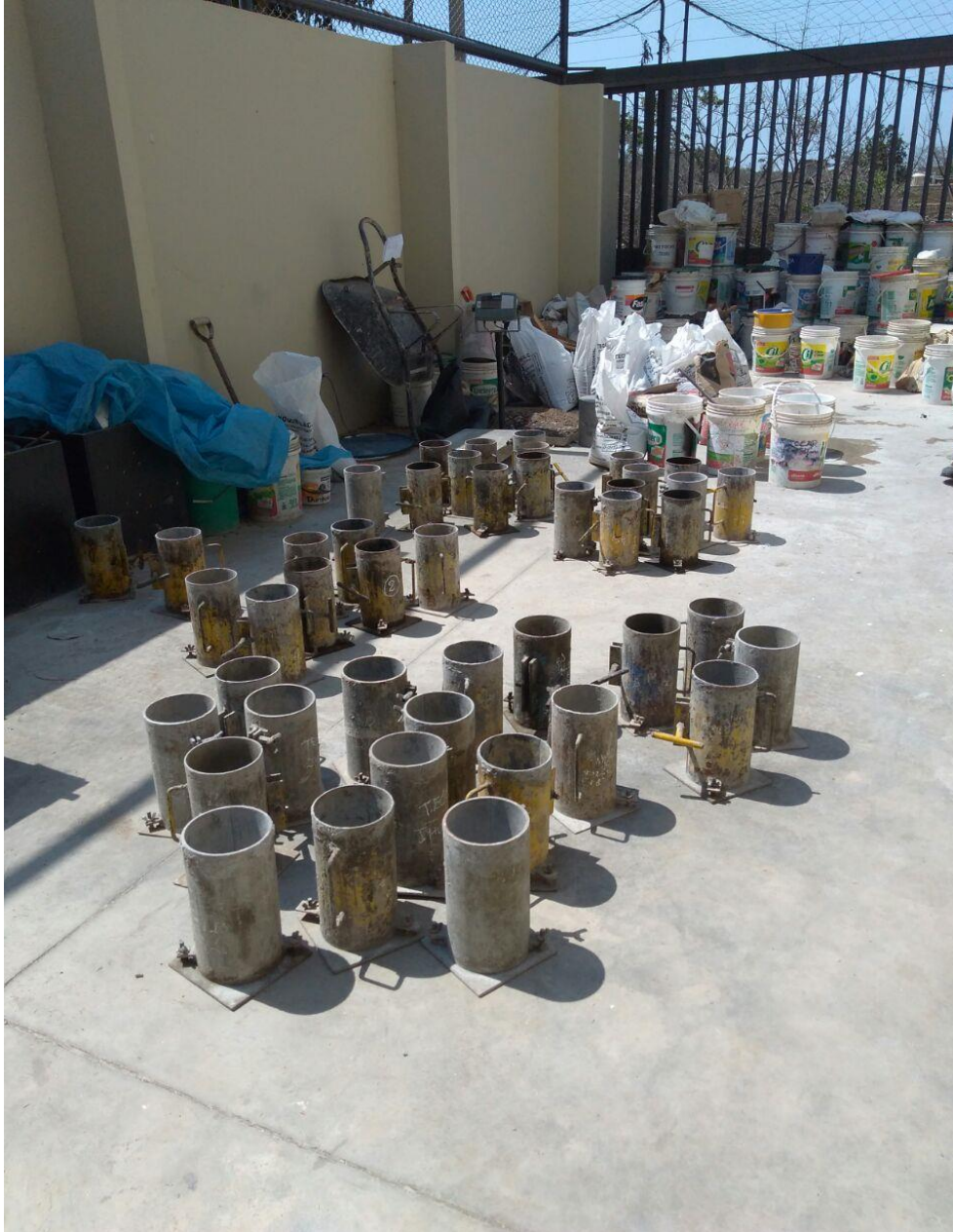
Fotografía 15: Moldes para probetas de concreto.
