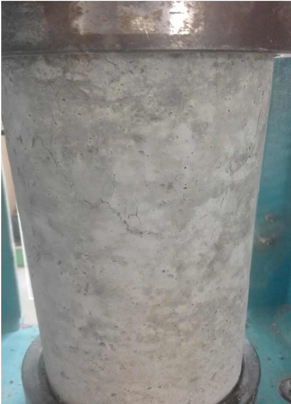
Fotografía 25: Rotura de probeta en la prensa hidráulica.
