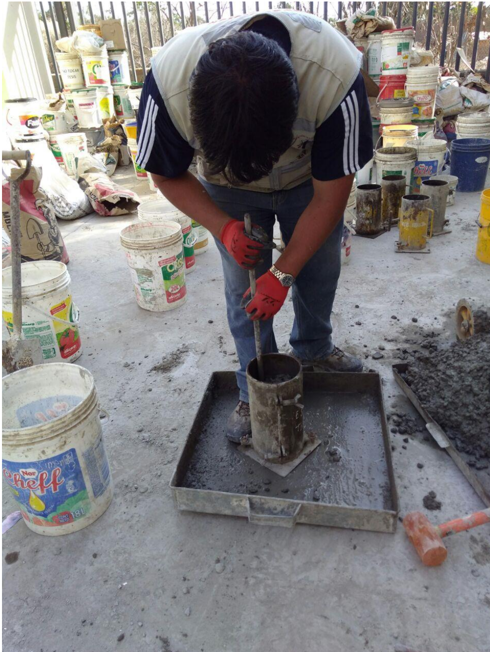
Fotografía 18: Elaborando probetas de concreto.
