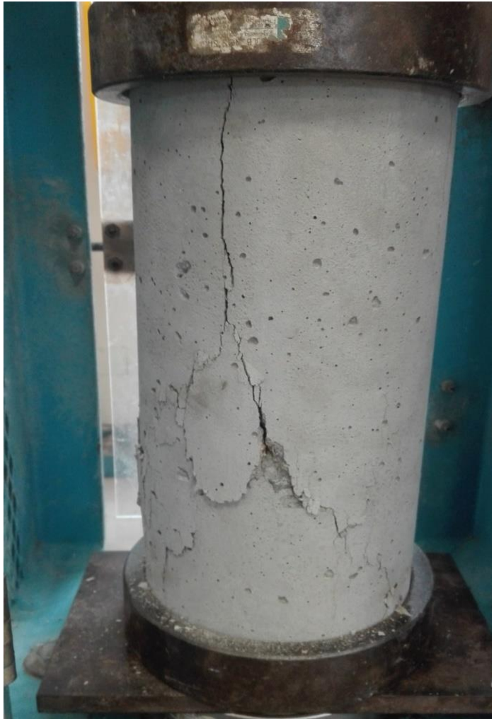
Fotografía 26: Rotura de probeta en la prensa hidráulica.
