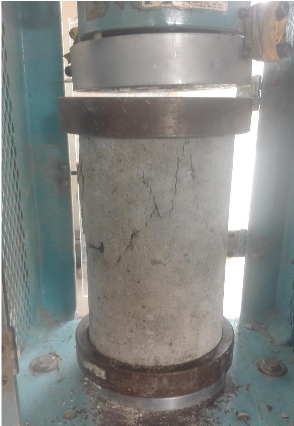
Fotografía 24: Rotura de probeta en la prensa hidráulica.
