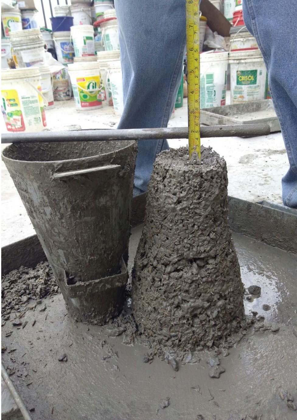
Fotografía 20: Asentamiento de 3.7 cm de la mezcla con adición de cascarilla de arroz.
