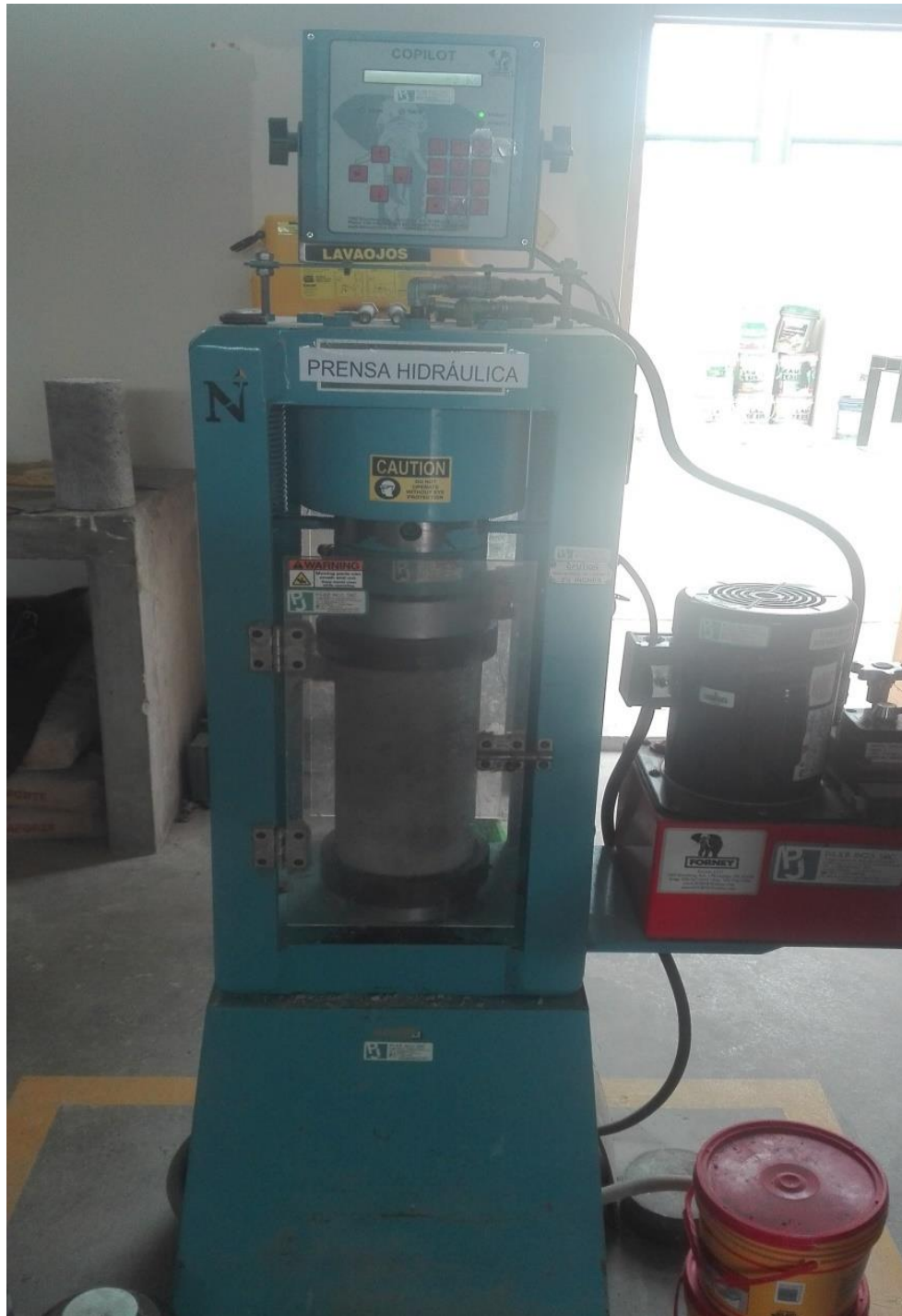
Fotografía 22: Prensa hidráulica para la rotura de probetas.
