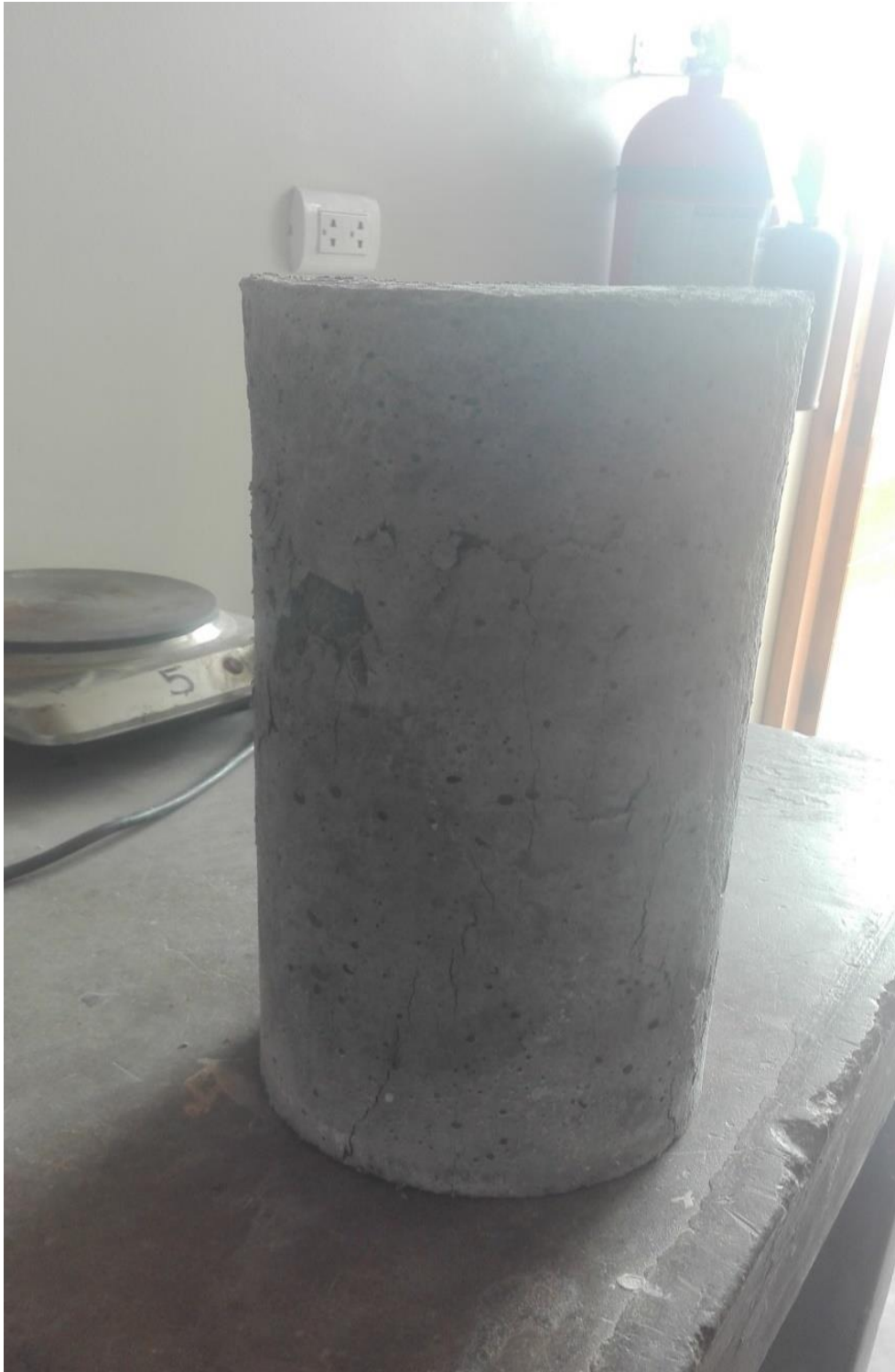
Fotografía 23: Probeta después de su comprobación en la prensa hidráulica.
