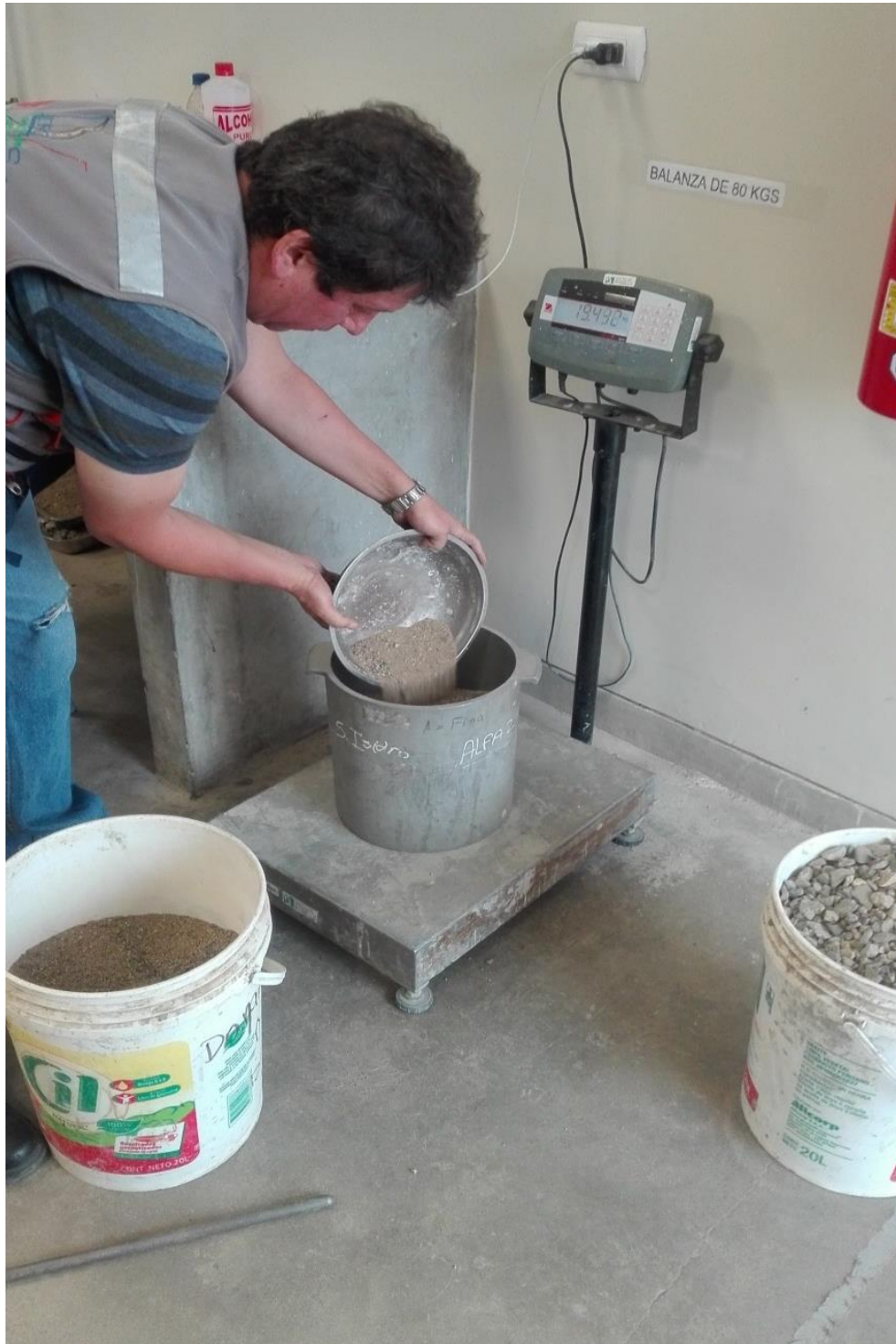
Fotografía 4: Ensayo para PUCS y PUSS.
