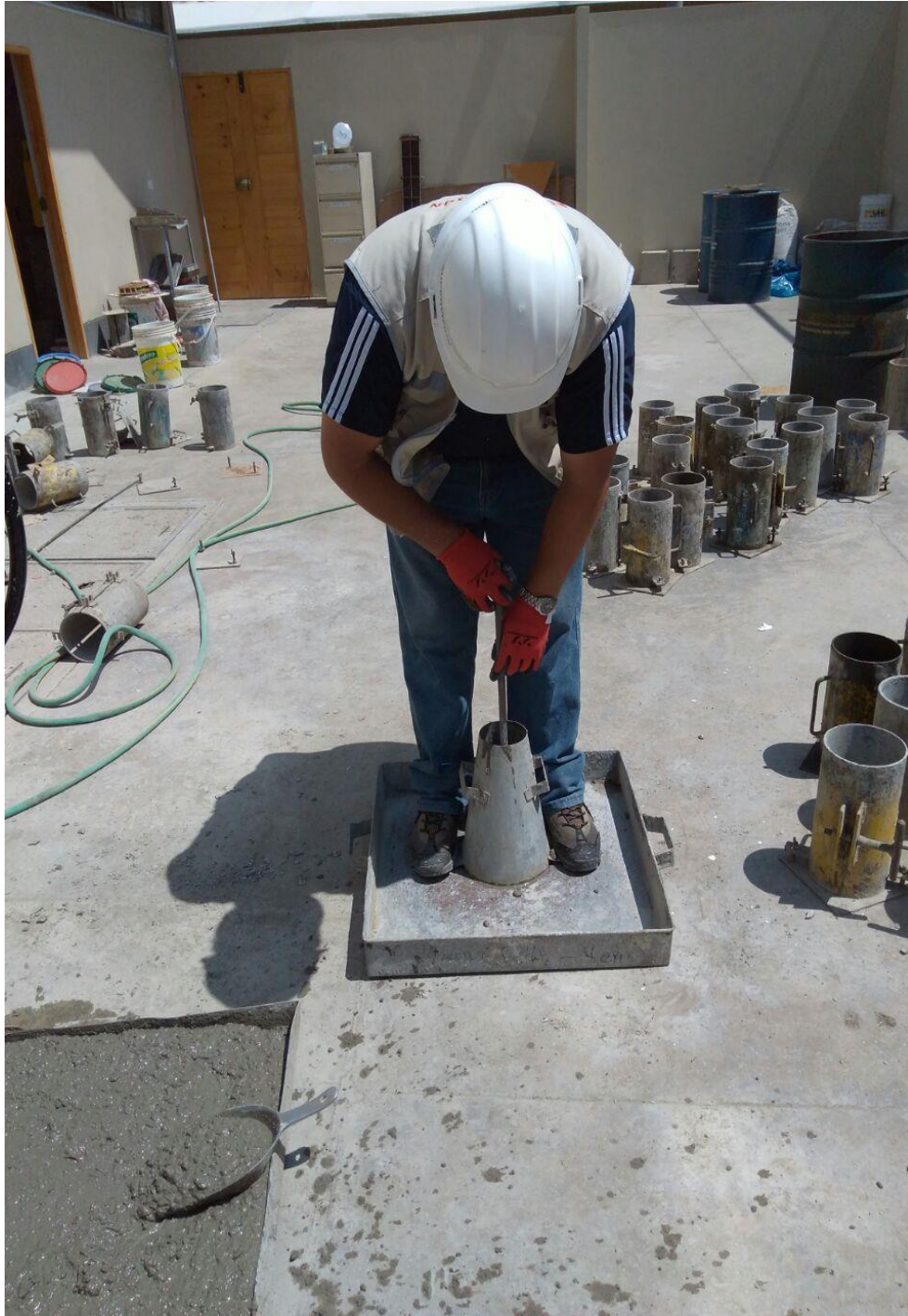
Fotografía 16: Ensayo del cono de Abrams (Slump).
