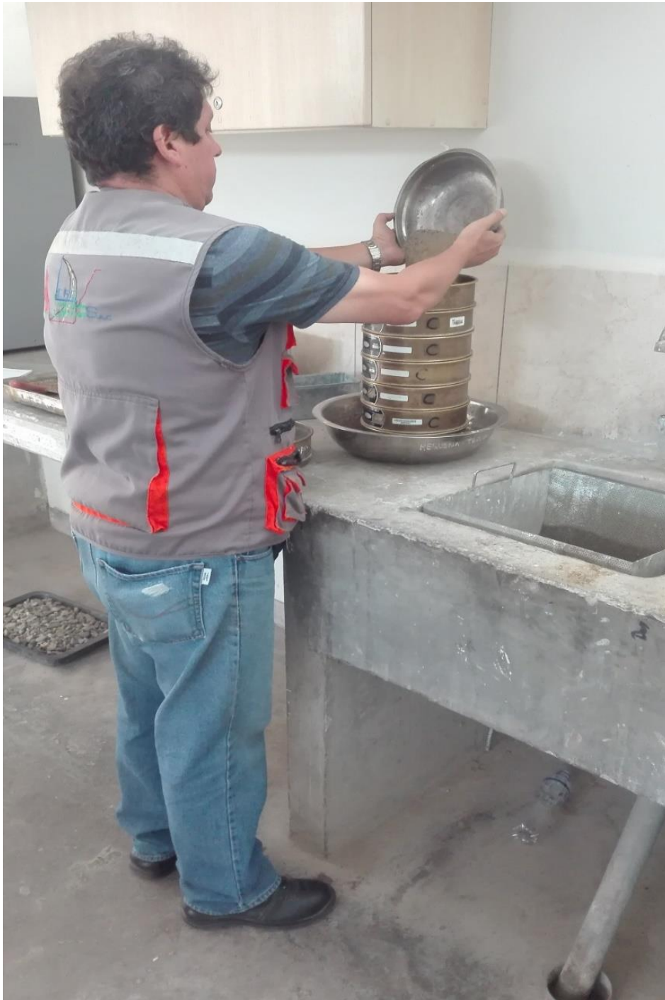
Fotografía 3: Colocación de ceniza de cascarilla de arroz (CCA) para su tamizado.
