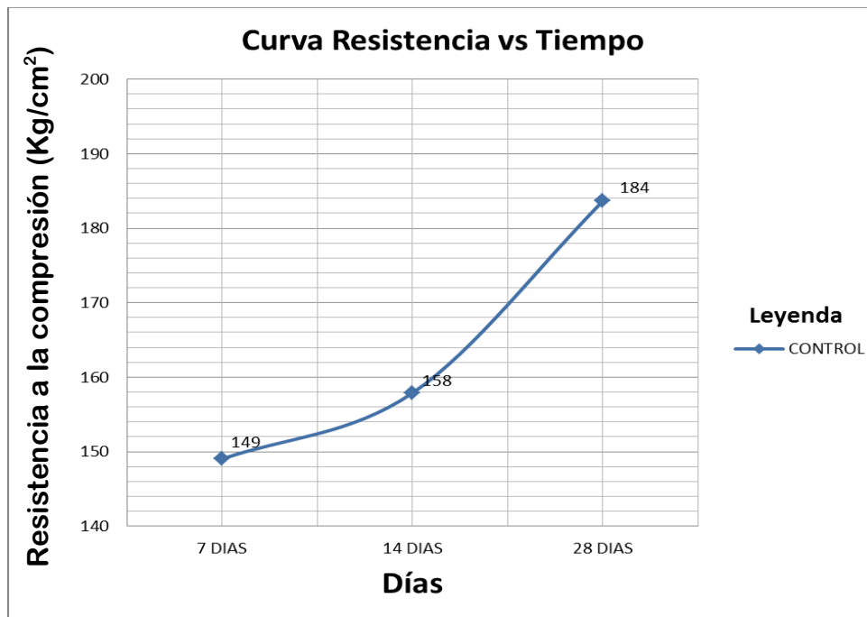
Figura 11: Gráfico de la curva de resistencia de las probetas control.
