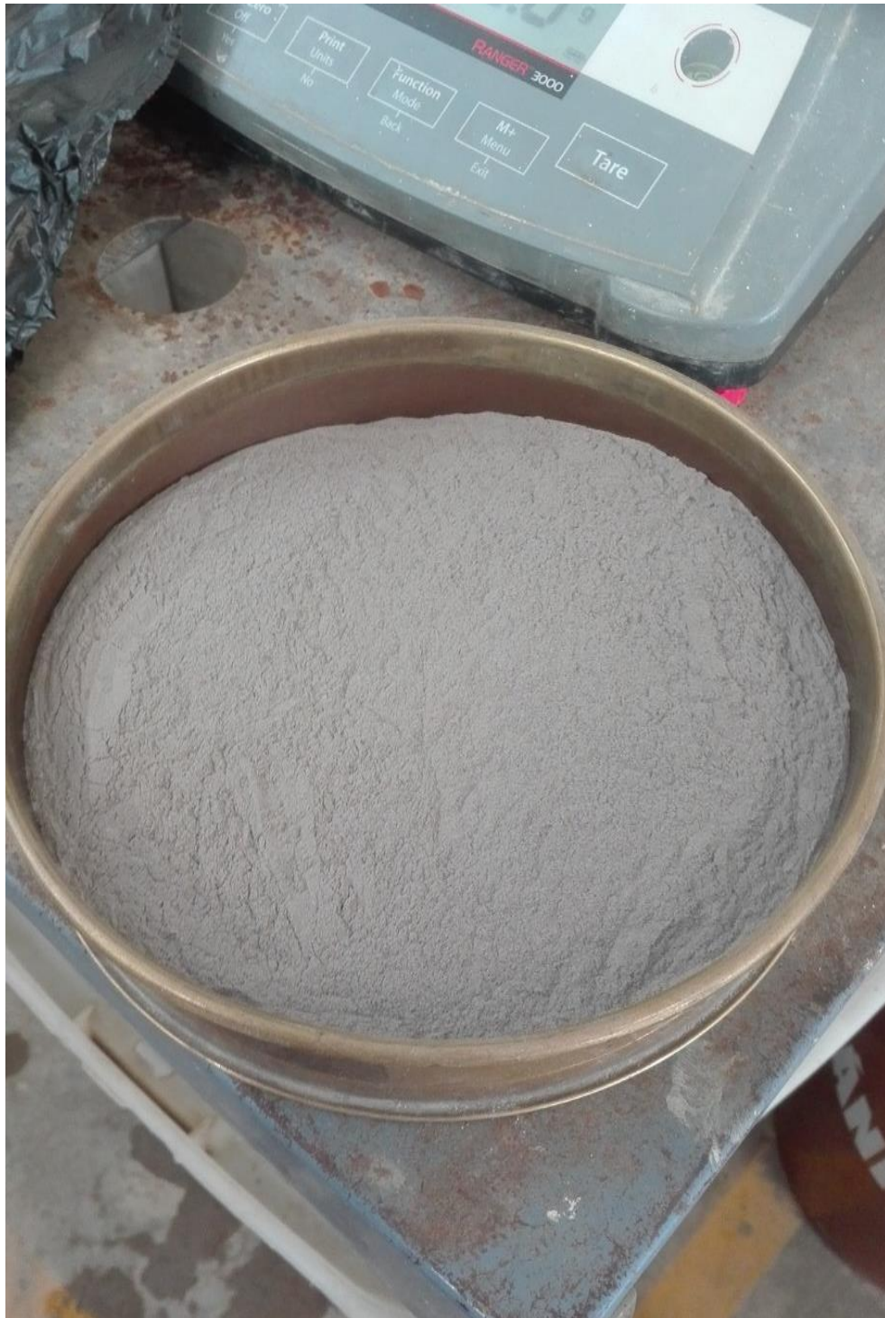
Fotografía 11: Ceniza de cascarilla de arroz (CCA) que pasó por la malla # 200.
