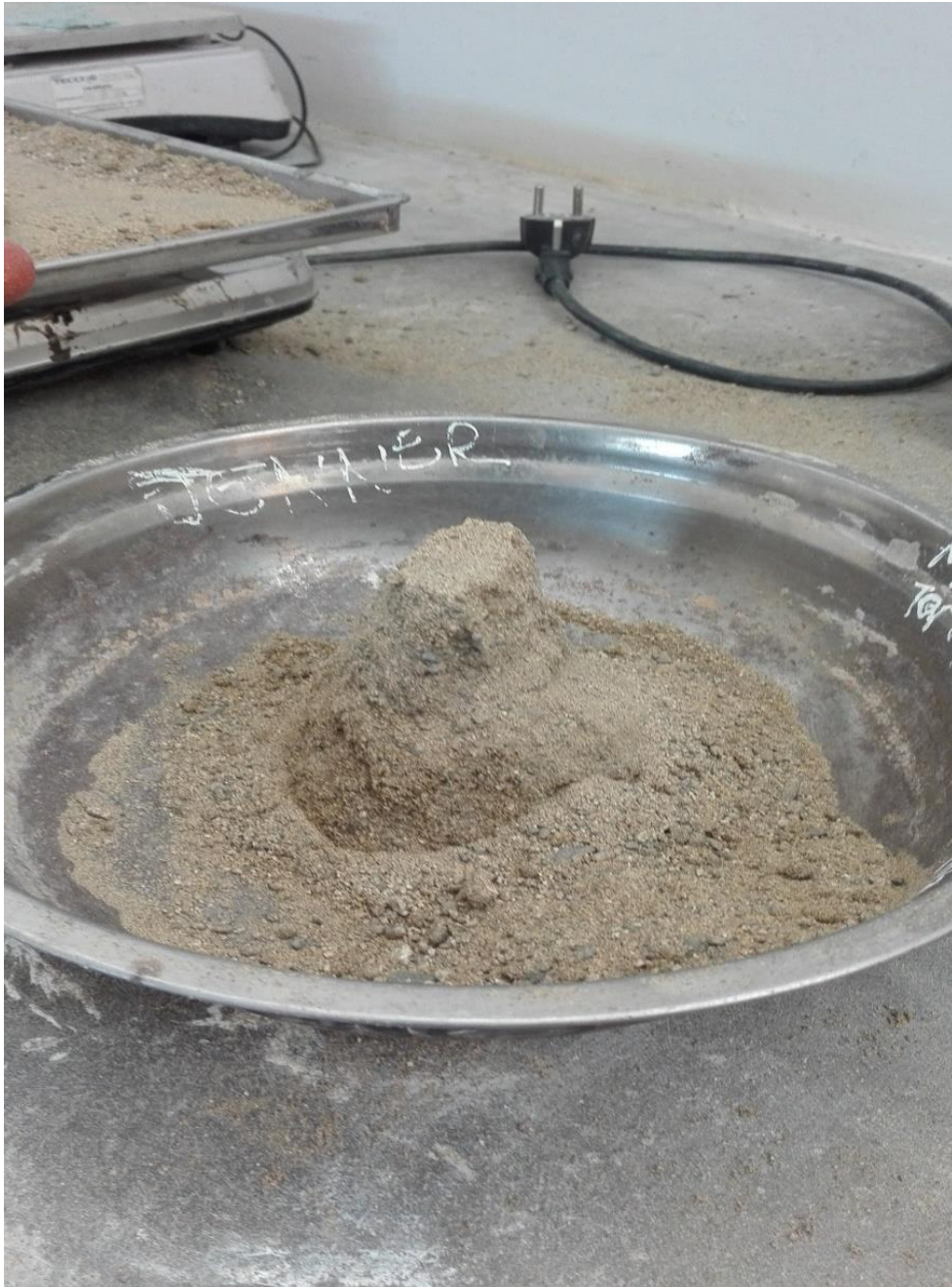
Fotografía 8: Ensayo peso específico de la arena.
