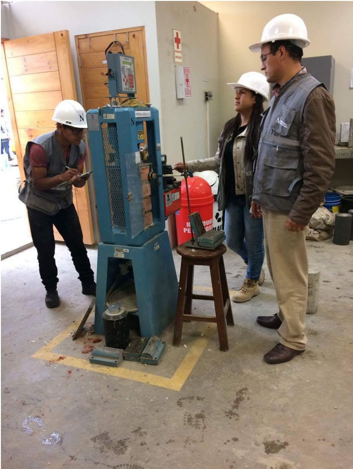
Figura n.º 10. 33. Resistencia a compresión de pilas de albañilería.
