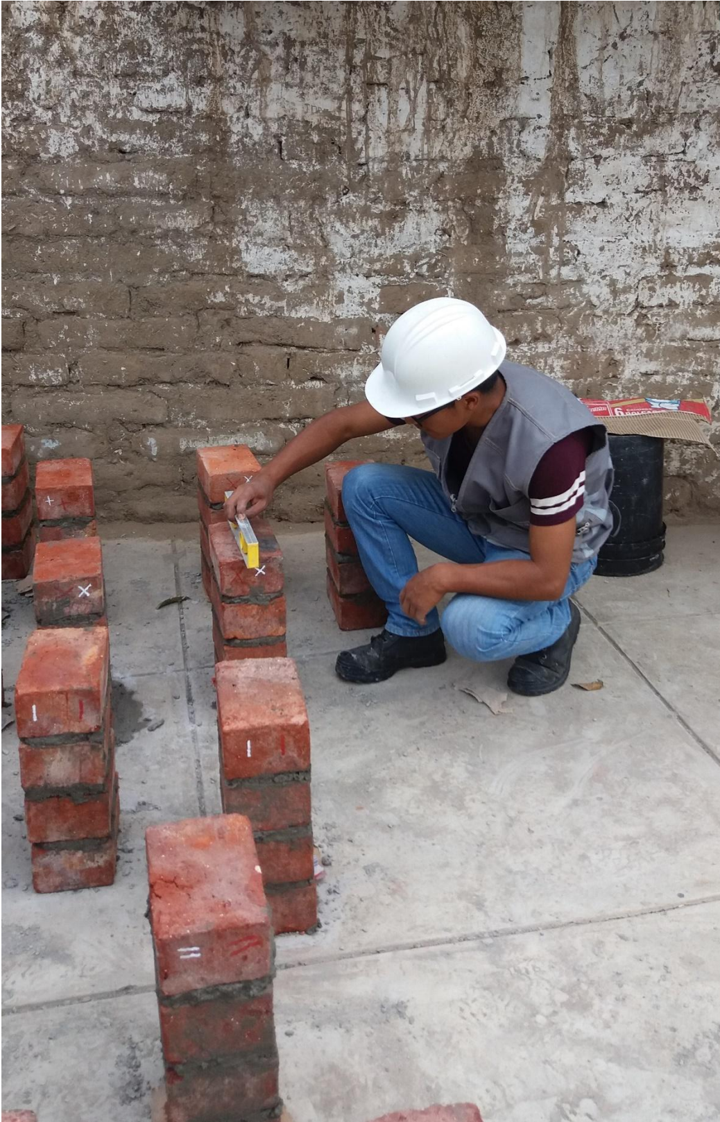
Figura n.º 10. 32. Nivelación de pilas con nivel de mano.
