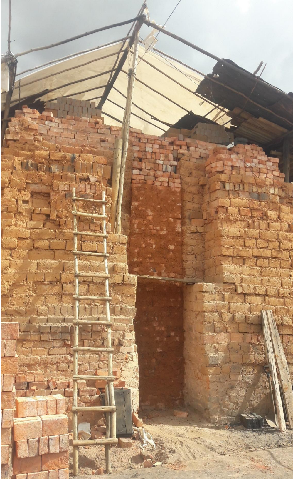
Figura n.º 10. 19. Cocción de los ladrillos artesanales King Kong en el horno.
