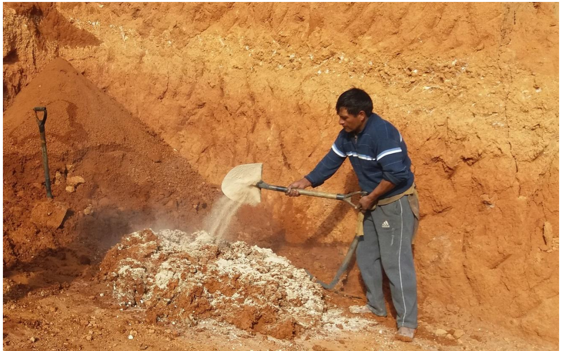
Figura n.º 10. 13. Uso de la arcilla de Caolín en la mezcla, para la fabricación de ladrillos artesanales King Kong.
