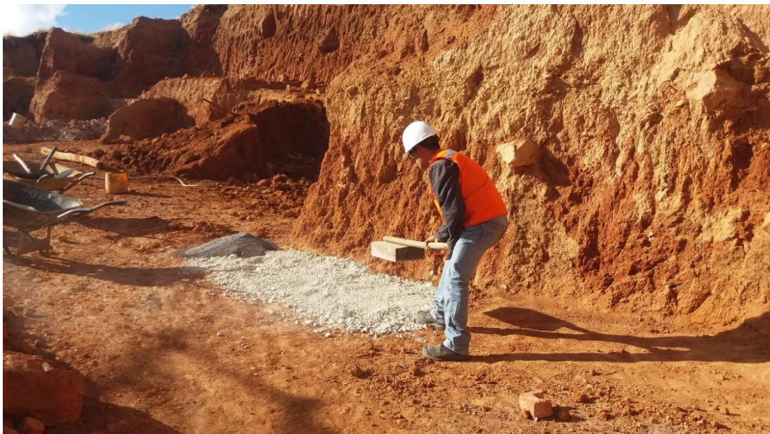
Figura n.º 10. 10. Apisonado de la arcilla de Caolín, para su uso en la materia prima del ladrillo artesanal King Kong.
