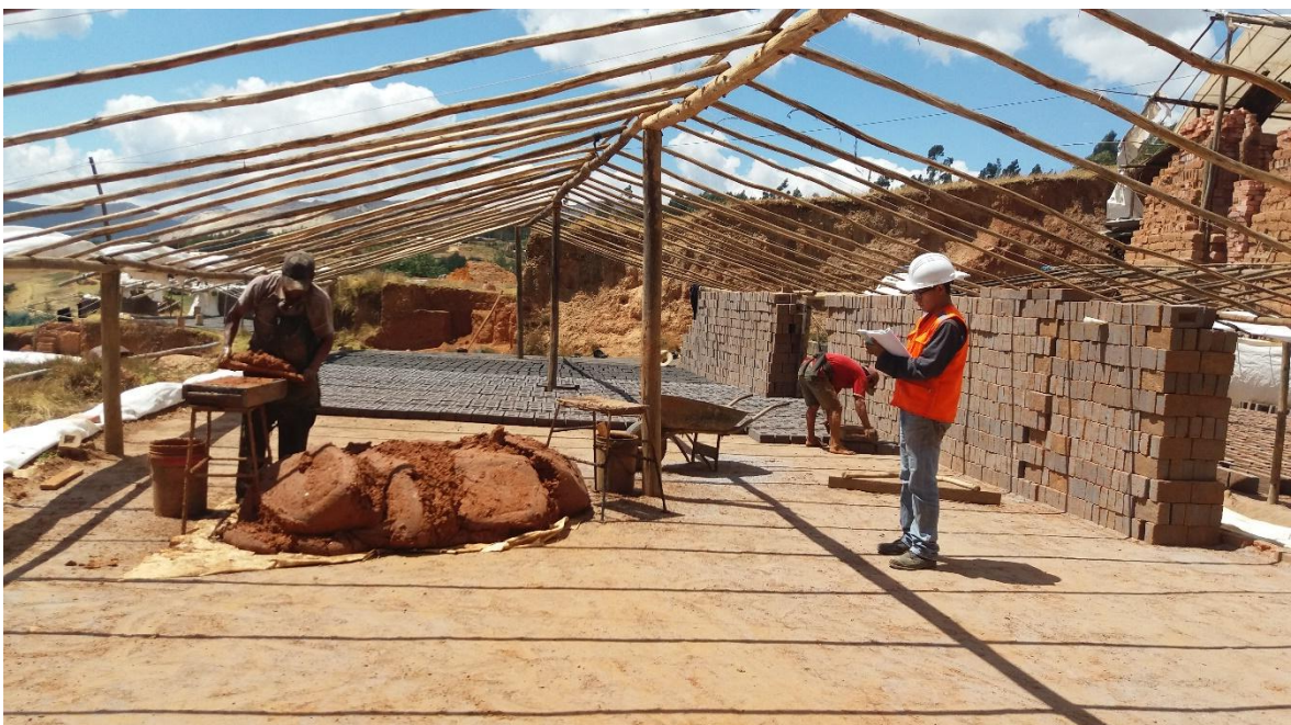
Figura n.º 10. 15. Proceso de moldeado de los ladrillos artesanales King Kong.
