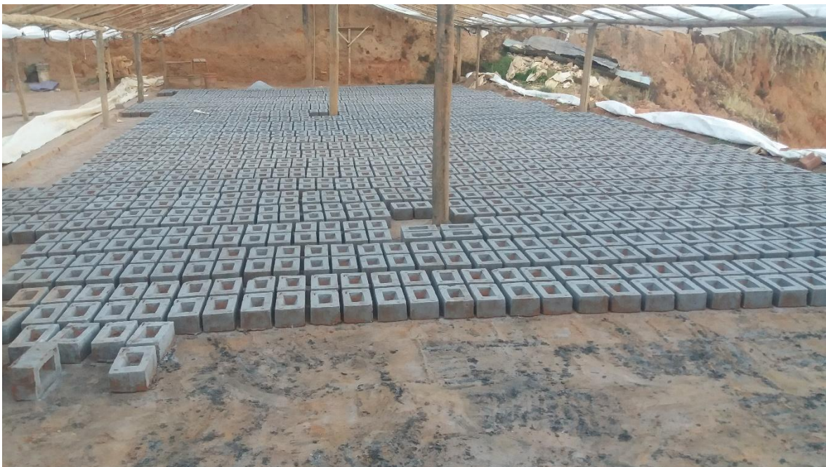
Figura n.º 10. 17. Proceso de secado de los ladrillos artesanales King Kong.
