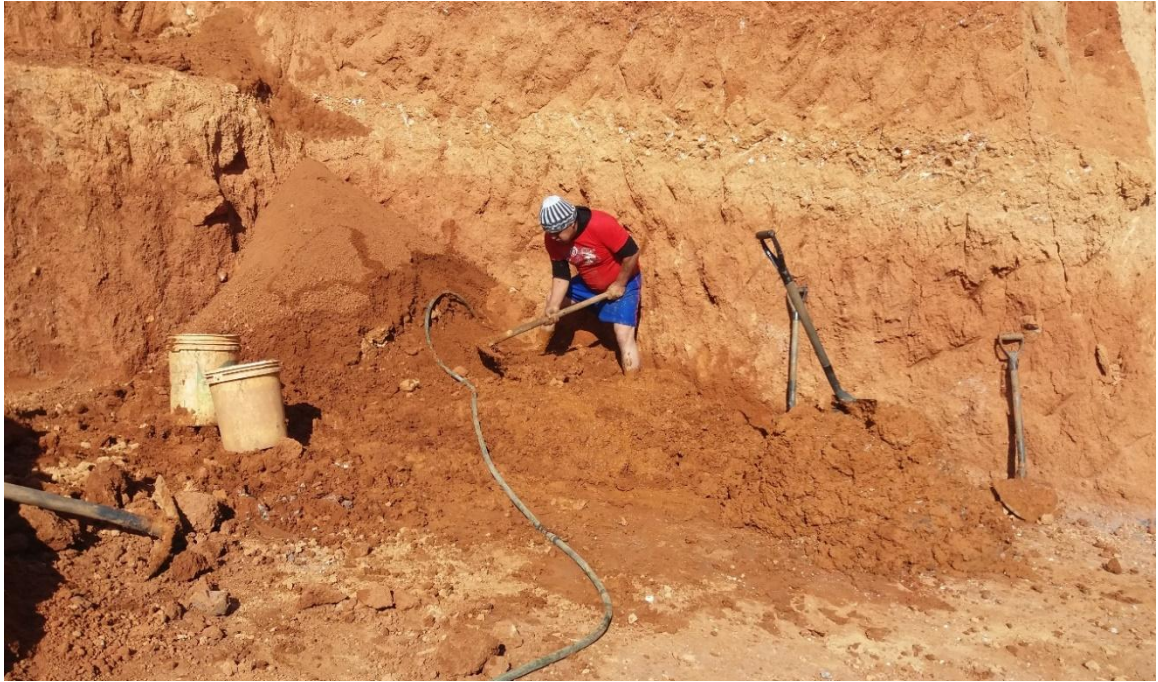
Figura n.º 10. 12. Preparación de arcilla roja para fabricación de los ladrillos artesanales King Kong.
