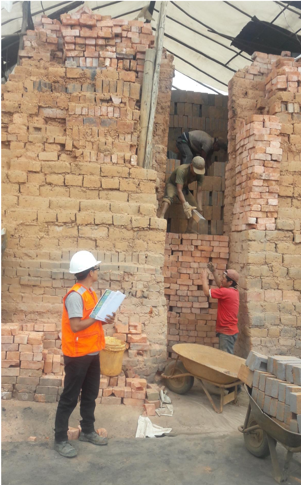
Figura n.º 10. 18. Proceso de carga de los ladrillos artesanales King Kong en el horno.
