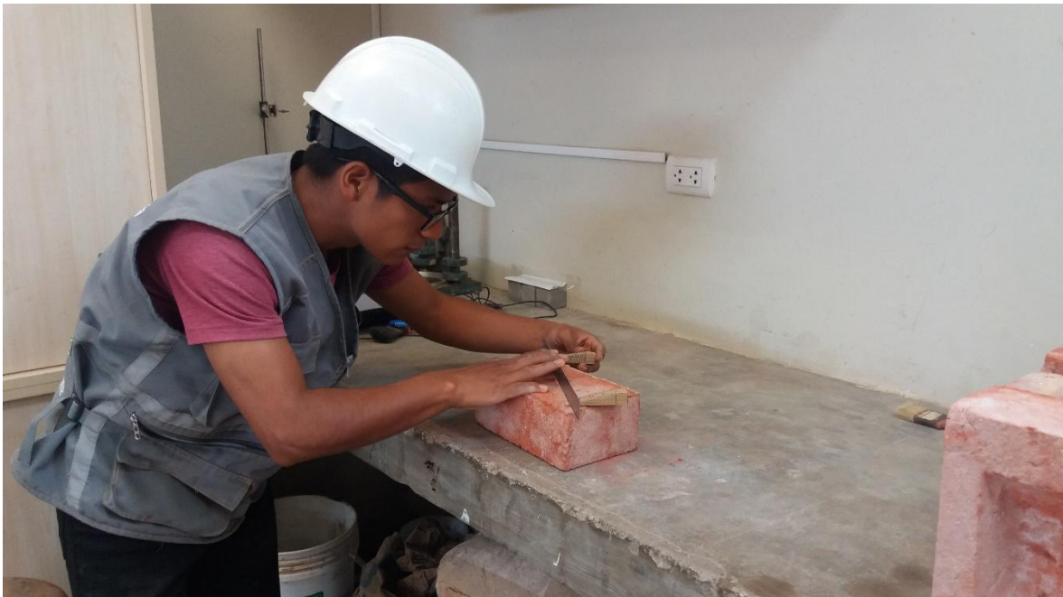
Figura n.º 10. 21. Ensayo de alabeo.
