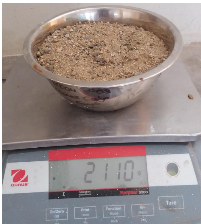
Figura n.º 10. 25. Peso de la tara más muestra seca del agregado fino.
