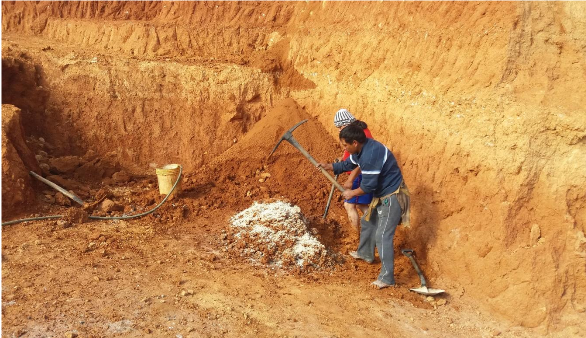
Figura n.º 10. 14. Preparación de mezcla con arcilla de Caolín, para la fabricación de ladrillos artesanales King Kong.
