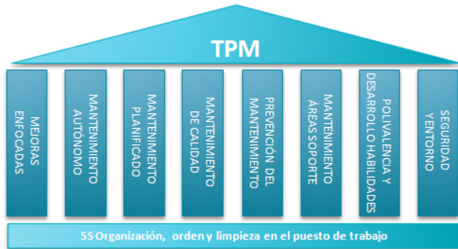
Figura 11: Pilares del TPM
