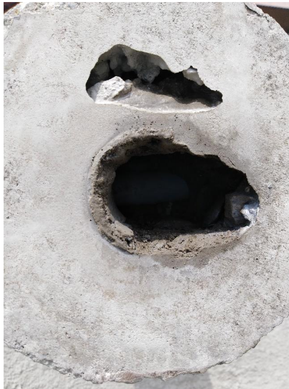
Figura n.º 9: Poste con cangrejera en la punta por efecto del vapor
