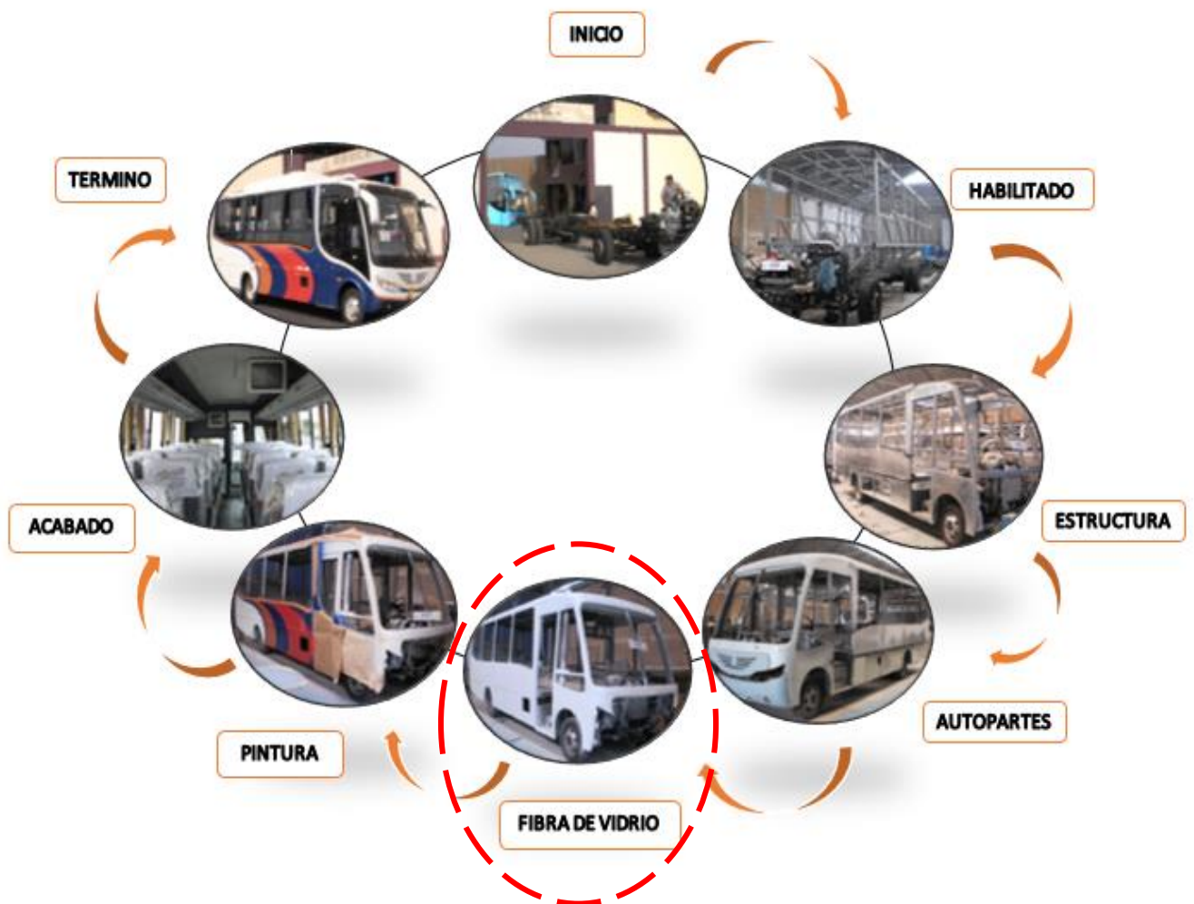
FIGURA N°02 – PROCESO PARA ELABORACIÓN DE UN BUS (1730 Y 915)
