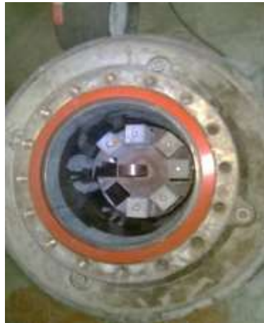
Figura 47. Expansión en autoclave; a. Pasta en moldes de autoclave, b. Calibración con probeta patrón, c. Especímenes en cámara autoclave., d. Medición de expansión.
