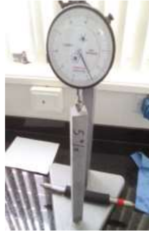
Figura 47. Expansión en autoclave; a. Pasta en moldes de autoclave, b. Calibración con probeta patrón, c. Especímenes en cámara autoclave., d. Medición de expansión.
