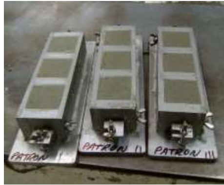
Figura 50. Probetas de mortero patrón.
