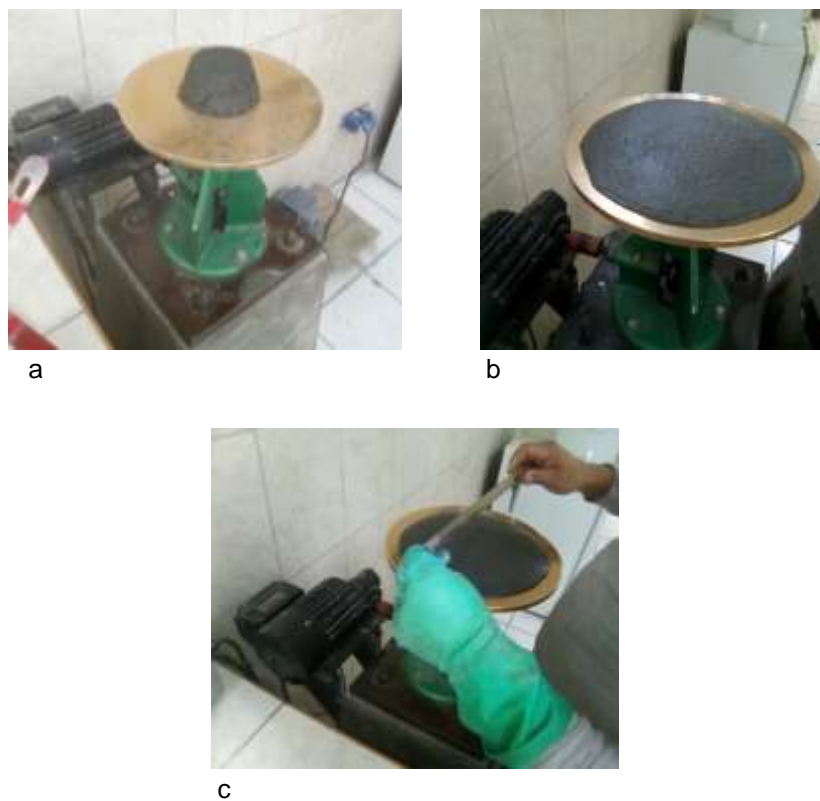
Figura 49. Fluidez; a. Mortero en mesa de flujo, b. Proceso de 25 golpes, c. Diámetro del mortero.
