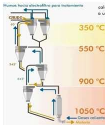
Figura 2. Ingreso del crudo a intercambiadores. (Rodríguez A. , 2013).
