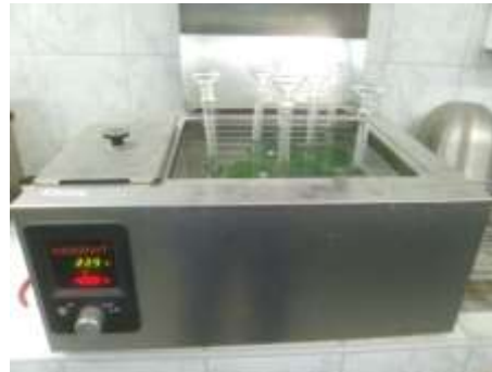
Figura 43. Densidad; a. Llenado de cemento en frasco chatelier, b. Equipo ultrasonido para evitar burbujas, c. Baño termostático de temperatura constante.
