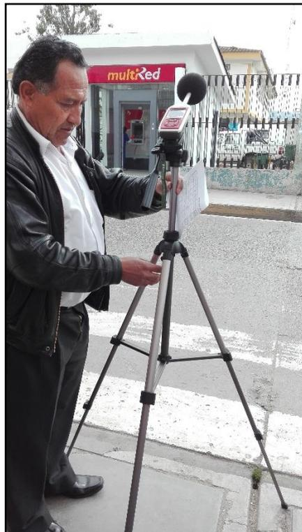
**Foto 8.** Observamos al Ing. José Bardales, instalando el sonómetro para la medición respectiva en el P5. Intersección de Av. Mario Urteaga y Jr. Guillermo Urrelo; frente al Centro de Salud Simón Bolívar.
