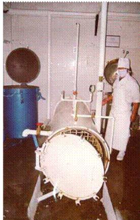
*Figura 61.* Esterilizado, en esta figura se observa el manipuleo de la maquinaria donde se realizará la esterilización de las latas ya con contenido de trucha. MINAGRI (2016).
