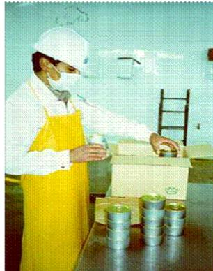
*Figura 62.* Embalado y reposo, en este proceso ya se tiene un producto sellado y terminado para posteriormente ser etiquetado. MINAGRI (2016).
