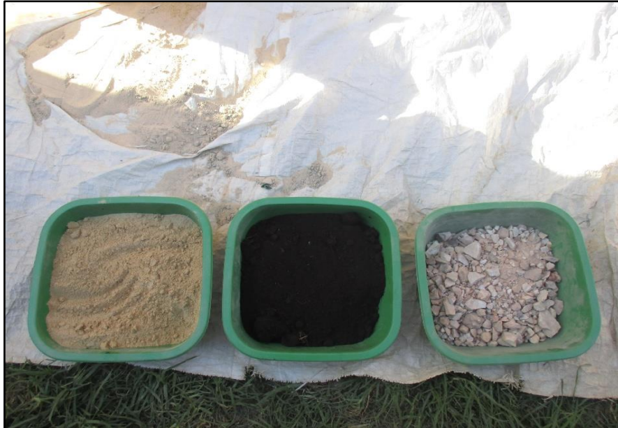
Figura 59: Agregados para el sustrato de los humedales
