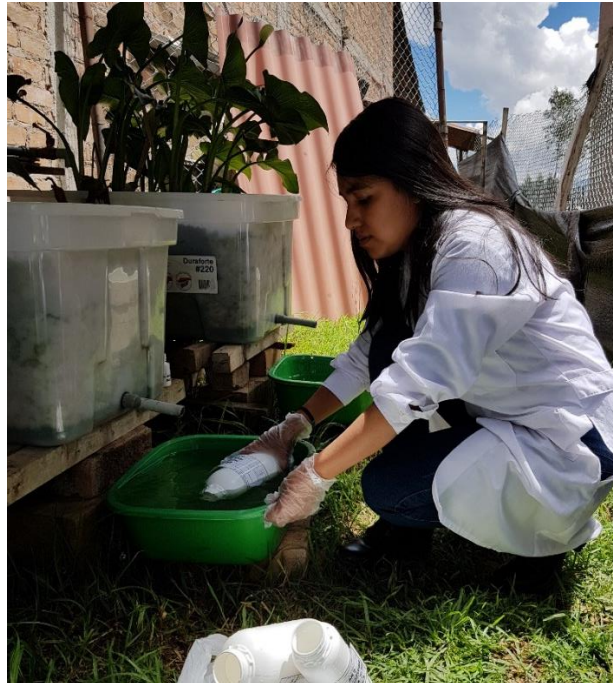
Figura 63: Toma de muestras después del tratamiento en el humedal 2
