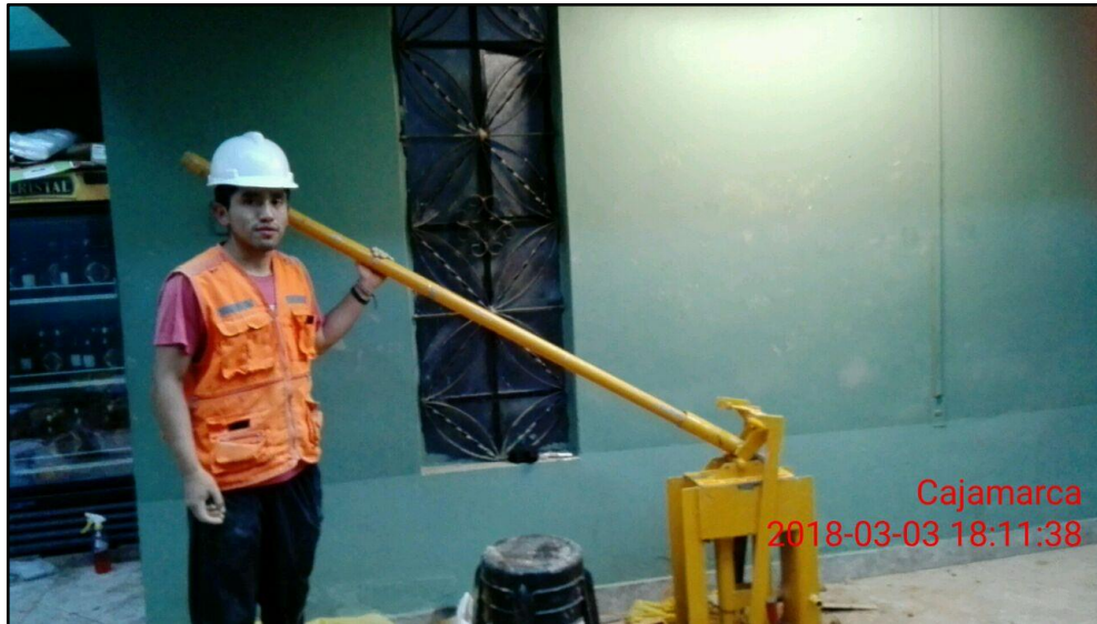
Figura N° 19 Usando la maquina CINVA RAM.
