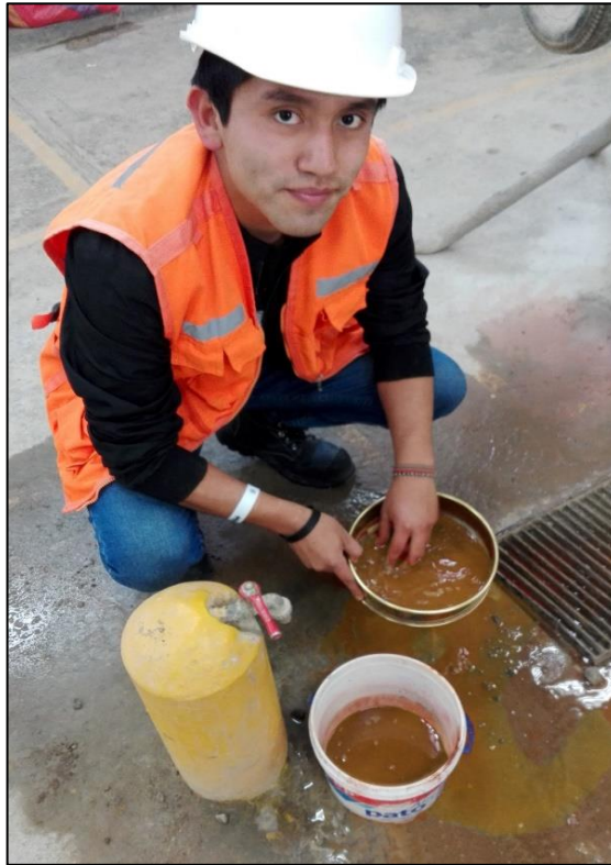
Figura N° 11 Granulometría por lavado debido a la presencia de limos y arcillas.
