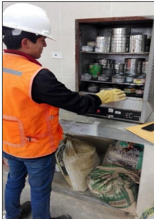
Figura N° 12 Colocando la muestra lavada al horno
