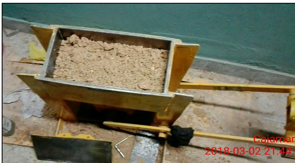
Figura N° 20 Elaboración de los adobes en la maquina CINVA RAM
