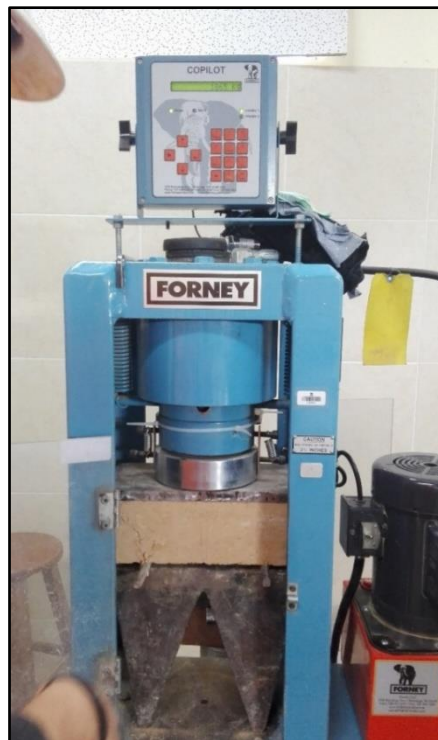
Figura N° 45 Sometiendo la unidad de adobe compactado a un esfuerzo de flexión.
