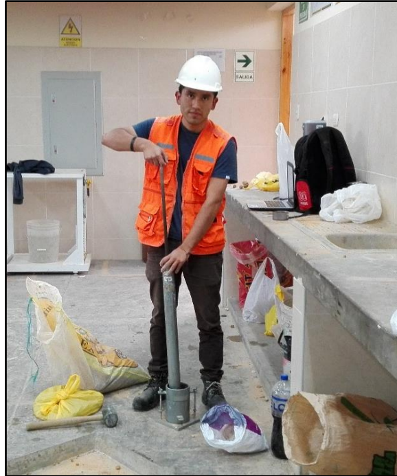
Figura N° 38 Realizando el proctor modificado en el laboratorio de concreto de la Universidad Privada del Norte.
