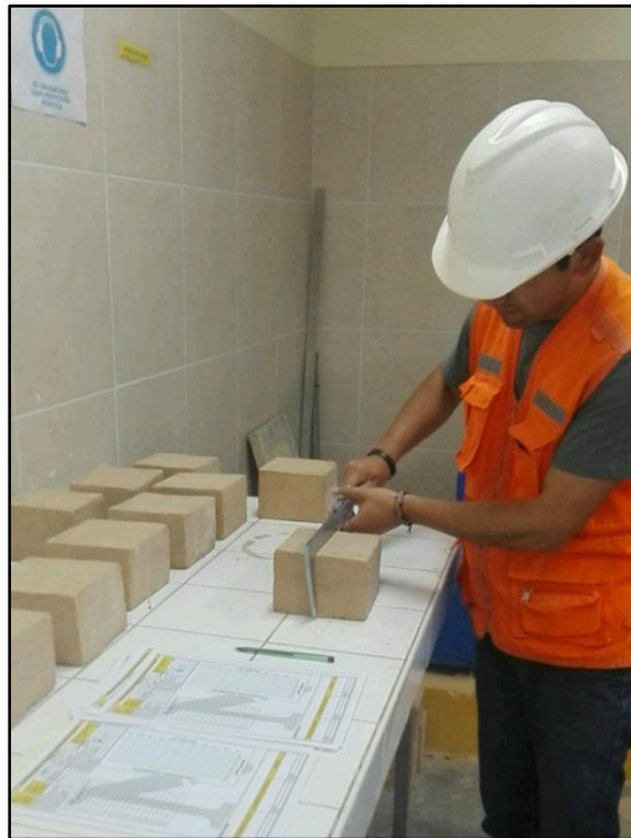
Figura N° 44 Tomando datos de las dimensiones de las unidades de adobe compactado.
