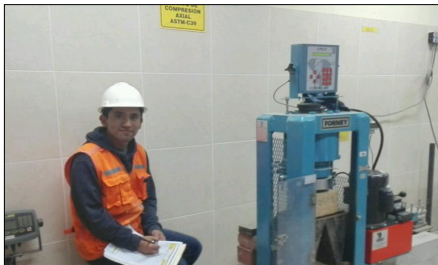
Figura N° 23 Tomando datos de la deformación en la resistencia a compresión de las unidades de adobe compactado.
