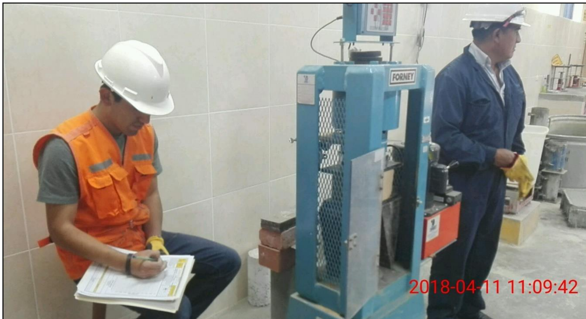
Figura N° 46 Tomando datos de la deformación en la resistencia a compresión de las unidades de adobe compactado.
