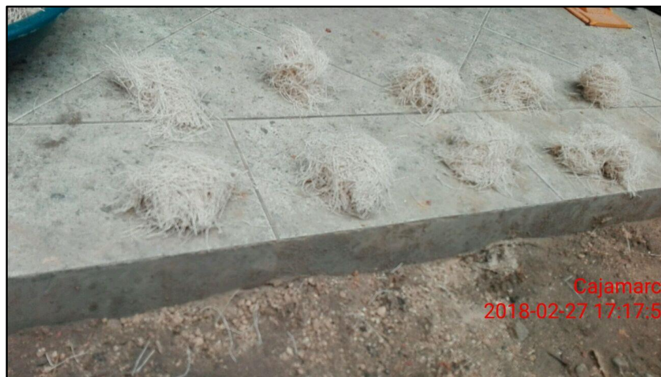
Figura N° 18 Separación del yute incorporación 1% con respecto al peso del adobe.
