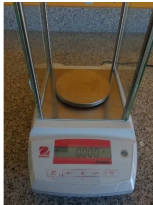
Figura 1. Balanza analítica Pioneer.
