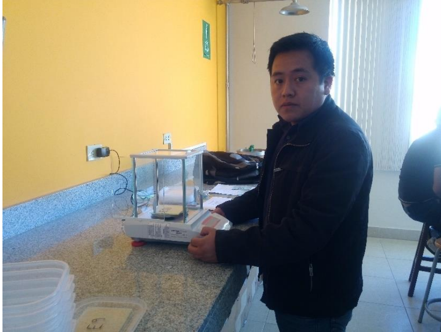
Fotografía N° 1. Pesado de cada placa de vidrio con vaselina en balanza analítica.
