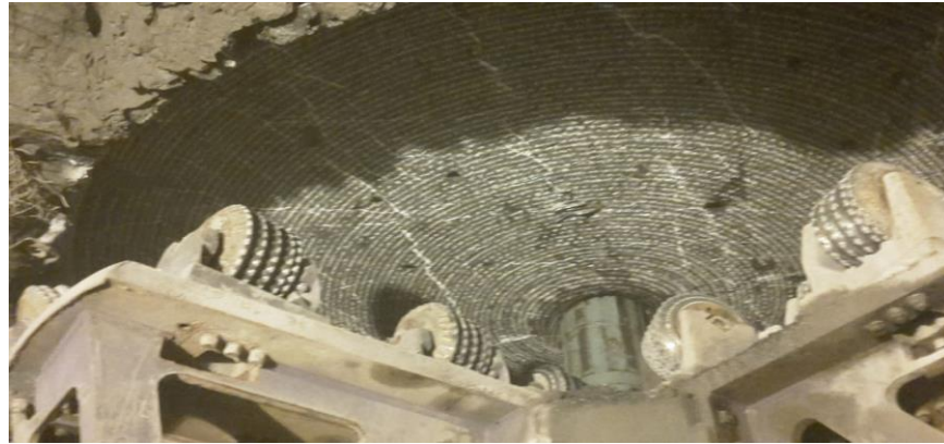
Figura 14: Cara techo al inicio de la perforación rimado.
