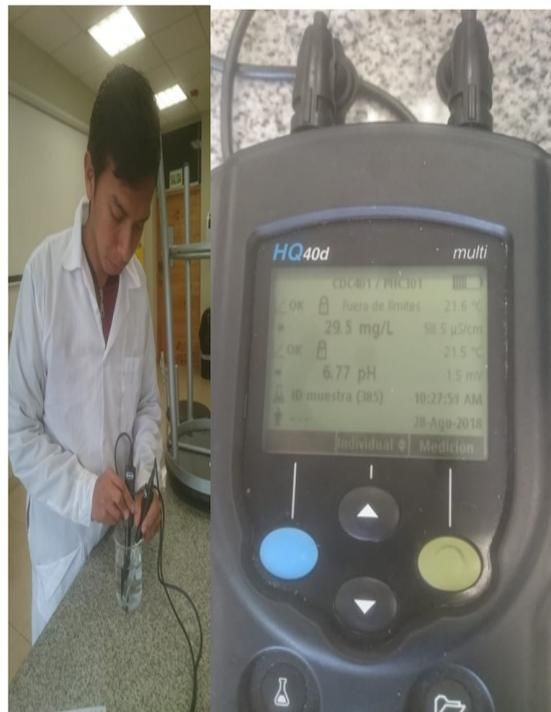
*Figura 24: Determinación del pH y conductividad usando equipo multiparámetro*
