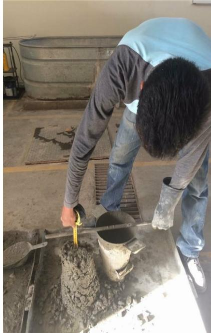
*Figura 38: Asentamiento concreto patrón*
