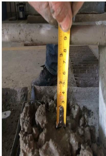
*Figura 39: Asentamiento con 10%(R.A): 0.5%+20 kg/m³*
