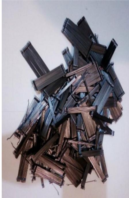
*Figura 44: Aditivo Acero Trefilado*
