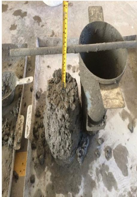
Figura 40: Asentamiento con 20%(R.A): 0.75%+20 kg/m<sup>3</sup>
