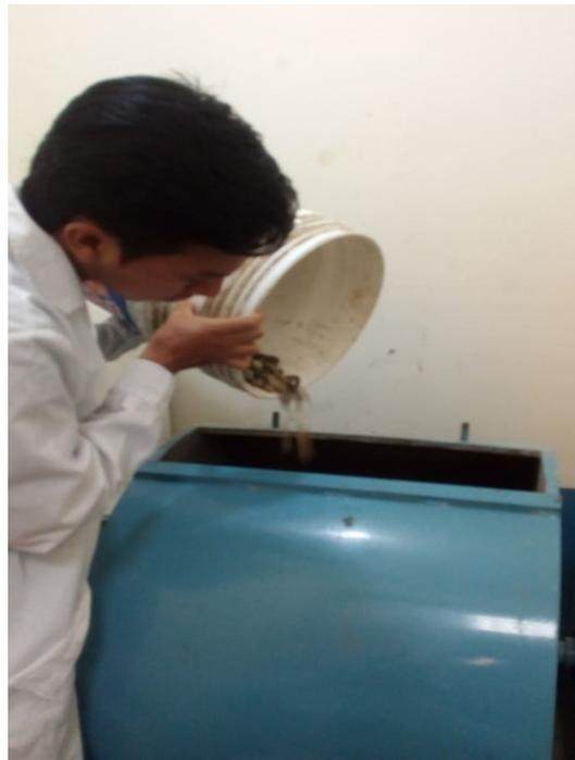
*Figura 33: Ensayo de Máquina de los Ángeles*
