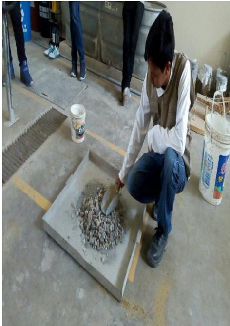
*Figura 30: Cuarteo del Agregado Grueso*
