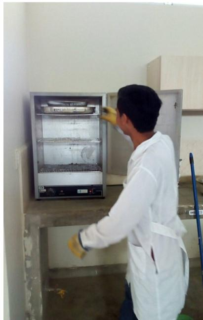
*Figura 35: Ensayo de Contenido de Humedad*
