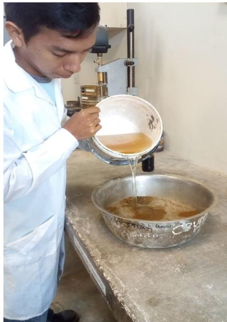
*Figura 31: Ensayo de Durabilidad del agregados sometido a sulfatos*
