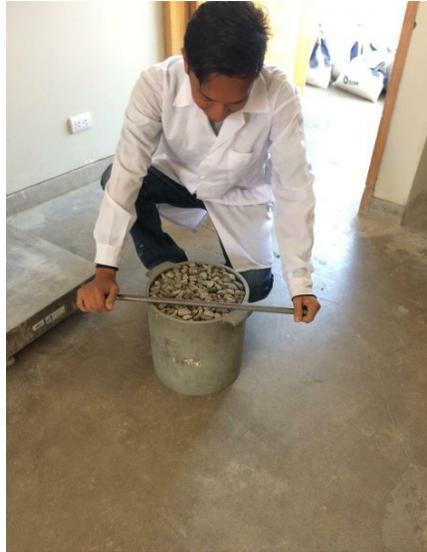
*Figura 36: Ensayo de Peso Unitario Seco Compactado del agregado Grueso*
