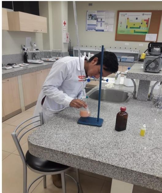
*Figura 27: Titulación de la muestra con nitrato de plata*
