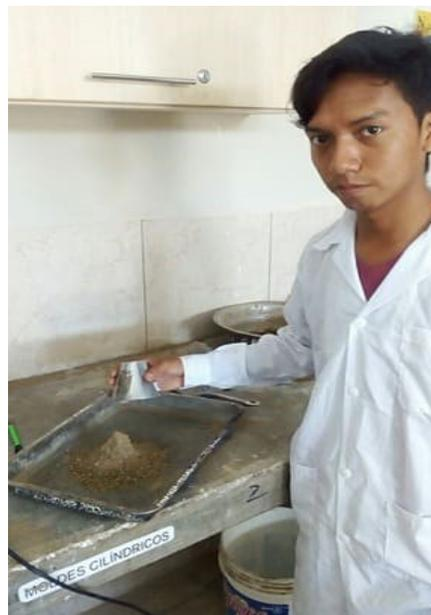
*Figura 37: Ensayo de Gravedad Específica del agregado Fino*
