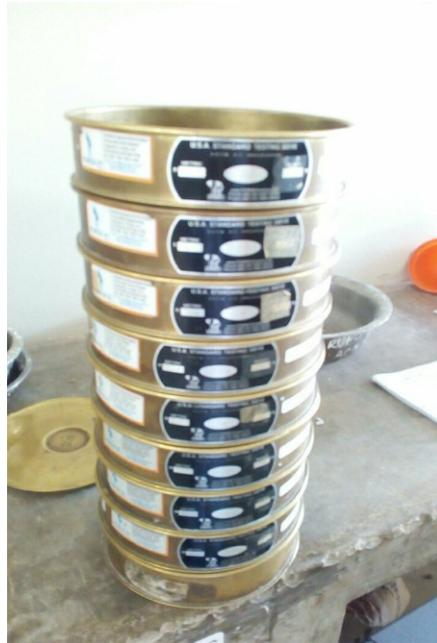
*Figura 34: Ensayo de Análisis Granulométrico*
