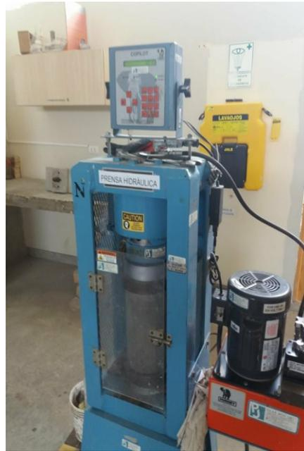
*Figura 42: Rotura de Probetas Cilíndricas – Compresión*
