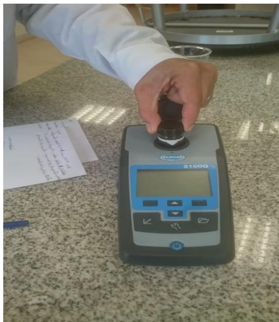
*Figura 25: Determinación de la turbidez y concentración de sulfatos usando equipo turbidímetro*
