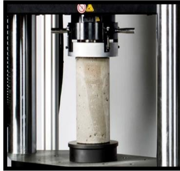
*Figura 4: Ensayo resistencia a compresión (Written by E., 2016)*
