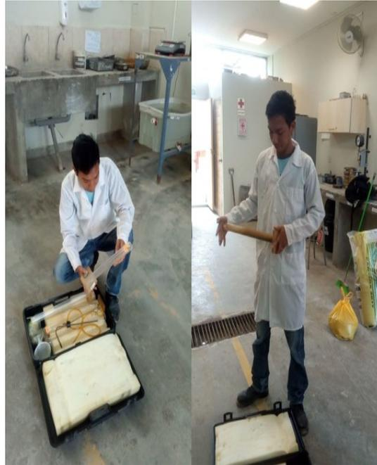
*Figura 32: Ensayo de Equivalencia de Arena*
