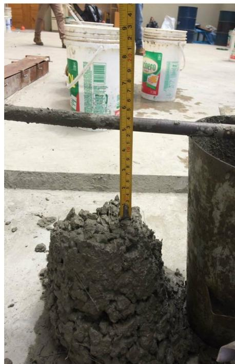
Figura 41: Asentamiento con 30%(R.A): 1%+20 kg/m<sup>3</sup>
