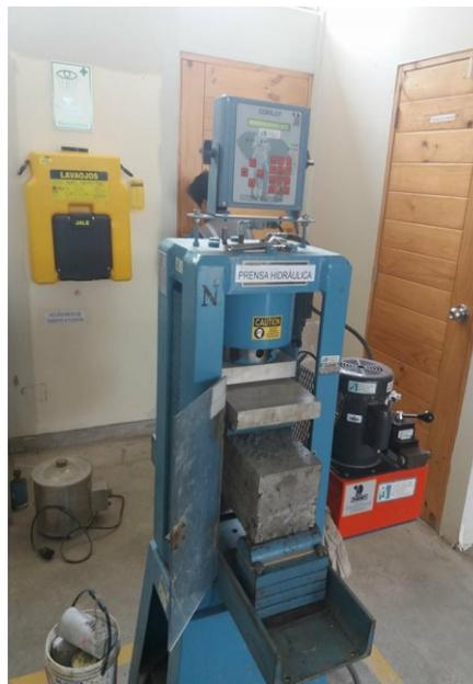
*Figura 43: Rotura de Probetas Vigas – Flexión*
