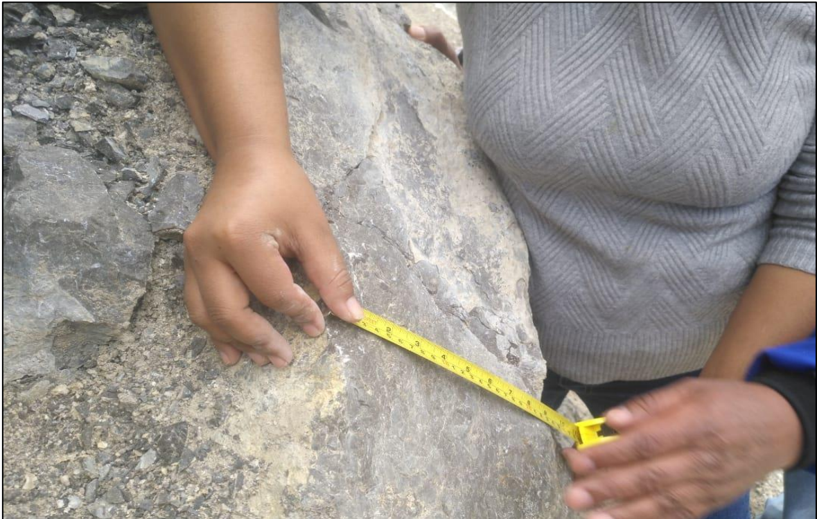
Figura 18. Medición de persistencia de la discontinuidad.
