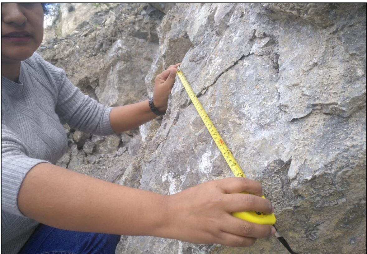
Figura 19. Medición de la potencia del estrato.
