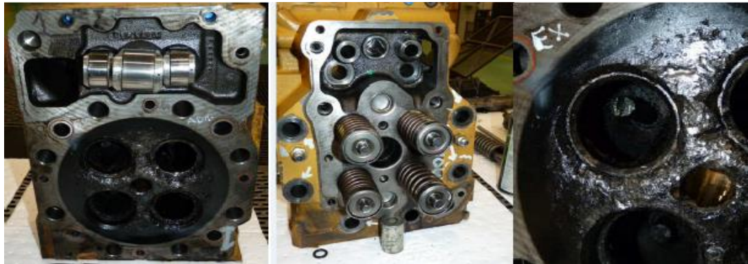
Figura 22. Partes dañadas del camión HT139.
