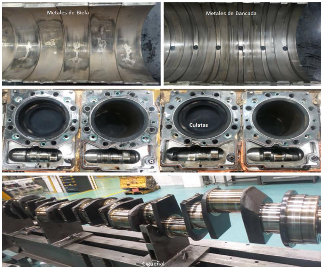
Figura 25. Partes evaluadas en reparación de motor con reparación anterior PBR del camión HT128. Fuente: Elaboración Informe de Reparación - CRC/Ferreyros SA.
