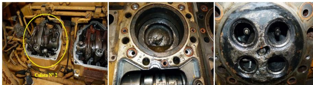
Figura 21. Partes dañadas del camión HT103.
