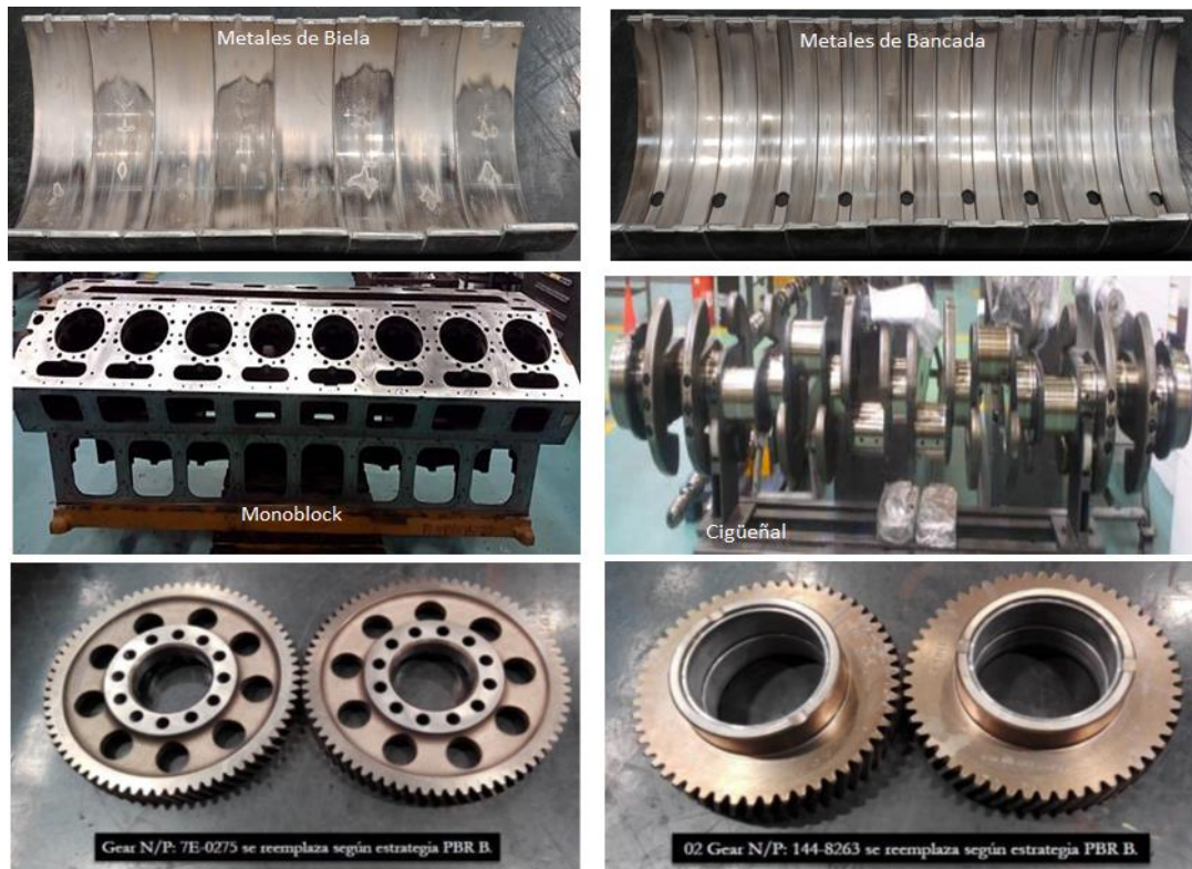
Figura 24. Partes evaluadas en reparación de motor con reparación anterior PBR del camión HT146. Fuente: Elaboración Informe de Reparación - CRC/Ferreyros SA.
