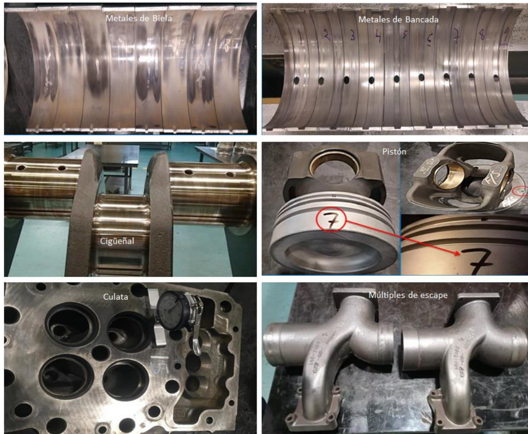
Figura 24. Partes evaluadas en reparación de motor con reparación anterior PBR del camión HT115. Fuente: Elaboración Informe de Reparación - CRC/Ferreyros SA.
