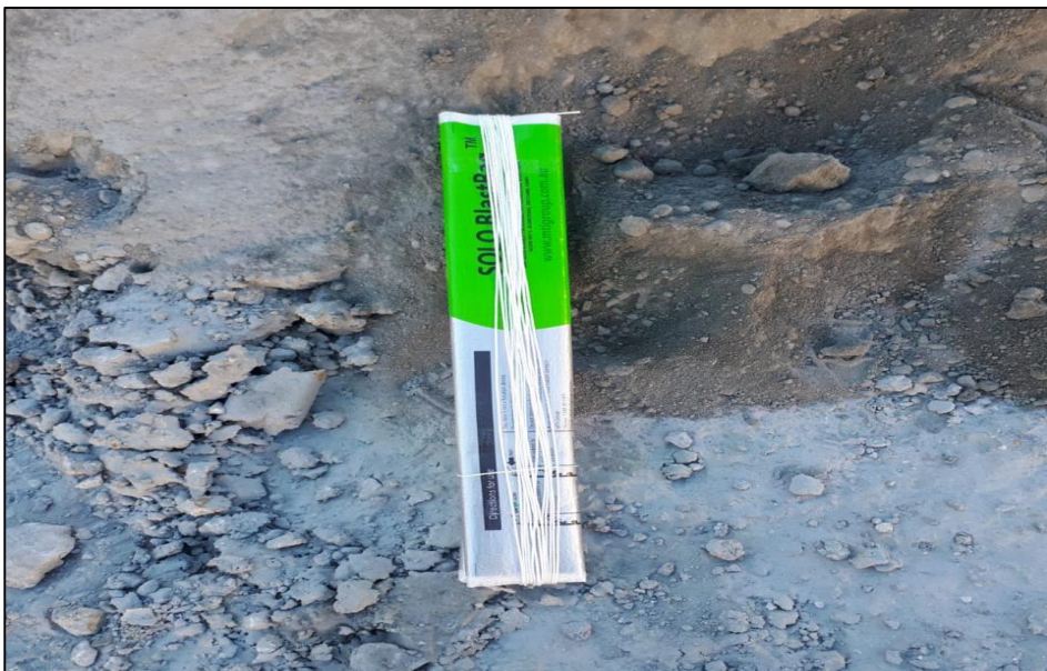
Figura 5. Bolsa de aire antes de ser usado en los taladros de La Quinua. Fuente: Elaboración propia, (2018).
