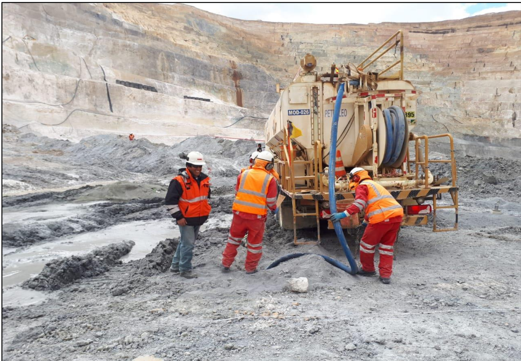
Figura 14: Carguío de taladros.
