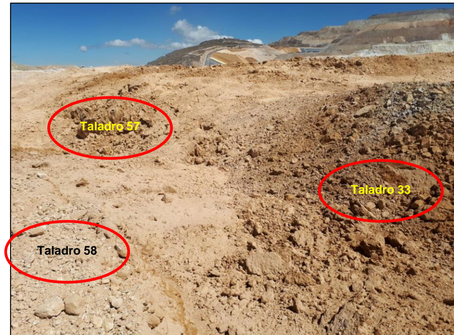
Figura 10: Taladros de prueba después de voladura en La Quinua. Fuente: Elaboración propia, (2018).
