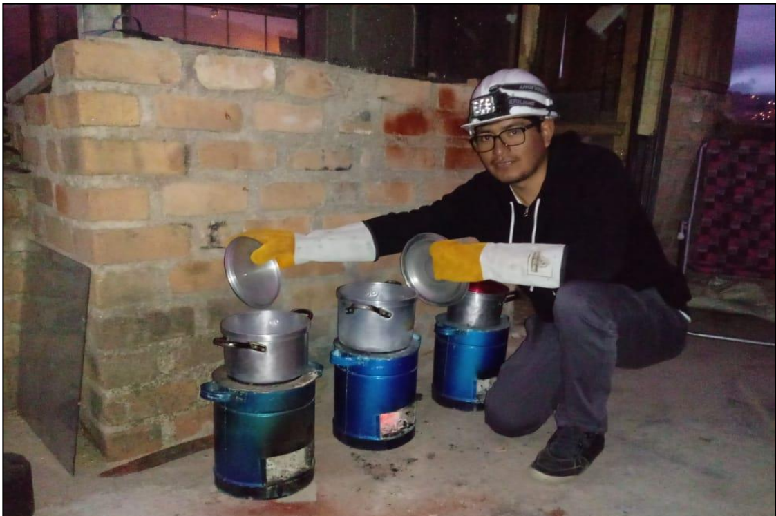
Figura 37. Toma de tiempos de hervido de agua con uso de briquetas. Fuente: Elaboración propia, (2018).
