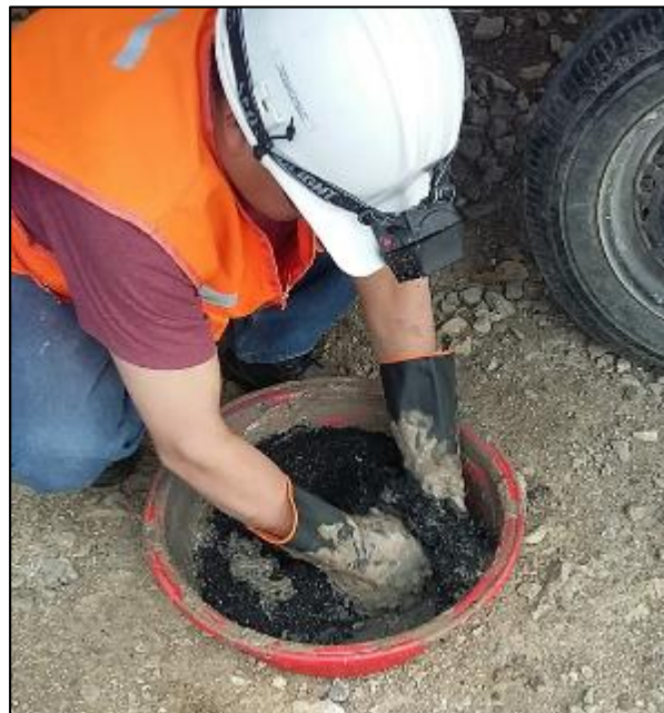
Figura 35. Mezcla para fabricar briquetas. Fuente: Elaboración propia, (2018).
