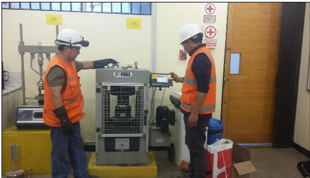
Figura 23. Prueba de compresión uniaxial de la briqueta. Fuente: Elaboración propia, (2018).
