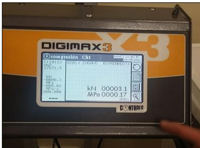
Figura 24. Resultados de compresión uniaxial de la briqueta. Fuente: Elaboración propia, (2018).
