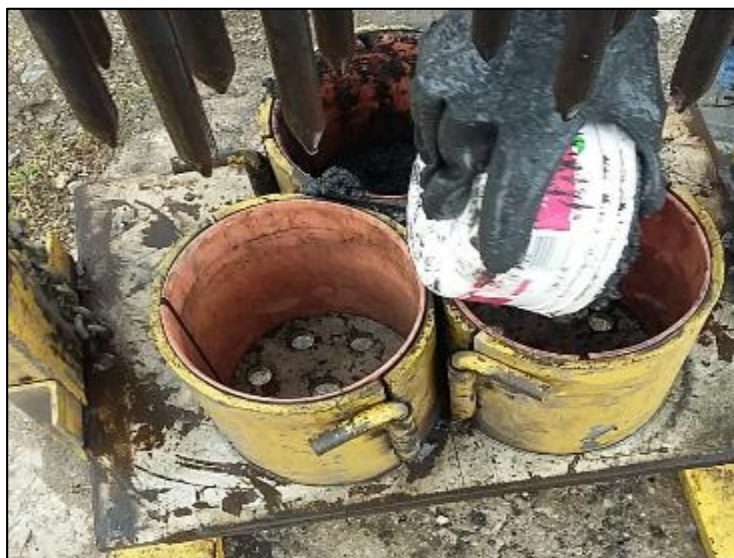
Figura 19. Llenado de mezcla en los moldes de la briquetera. Fuente: Elaboración propia, (2018).
