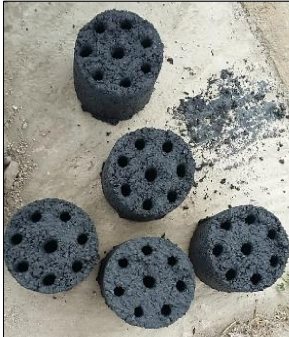
Figura 22. Secado de briquetas. Fuente: Elaboración propia, (2018).
