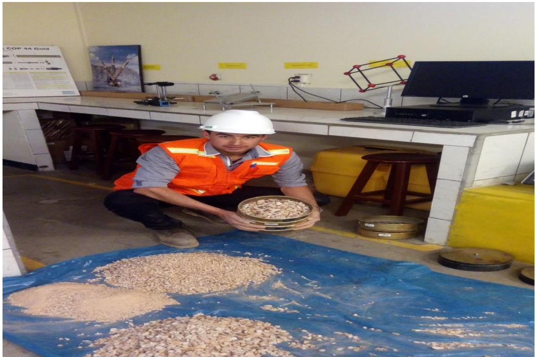
Tamizado de las muestras para obtención del material pétreo de ½ pulg.
