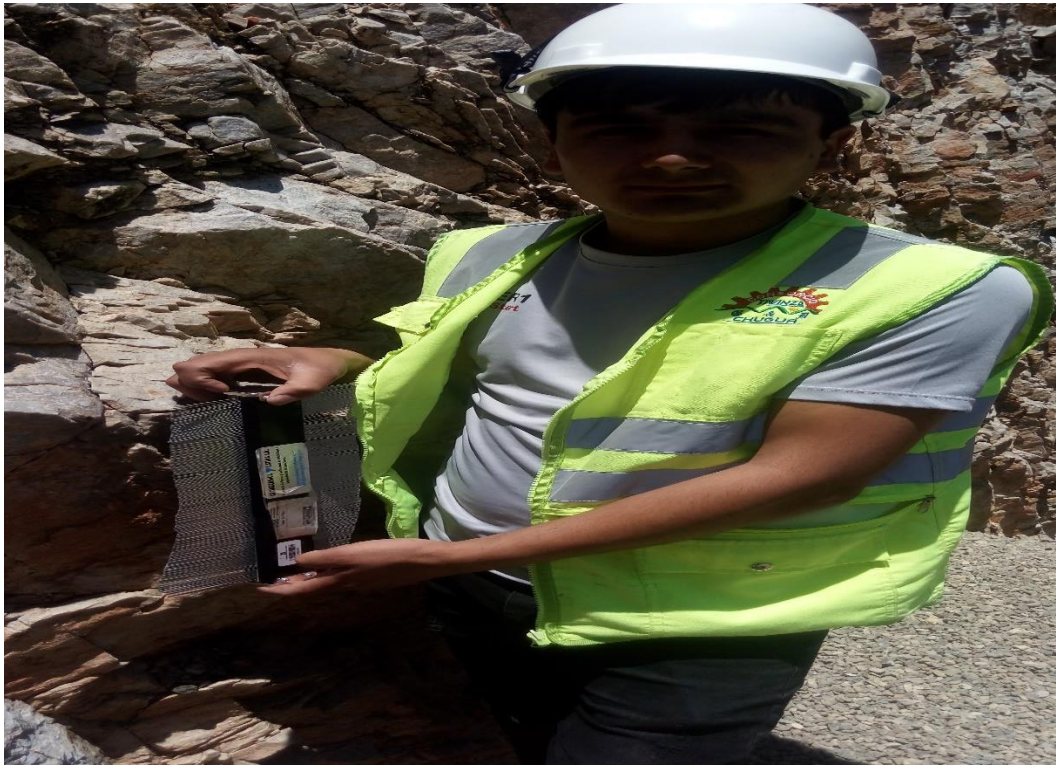
Medición del nivel de rugosidad con el peine de barton
