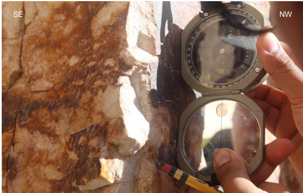
Medición del rumbo, buzamiento y dip direction de la estratificación del macizo rocoso
