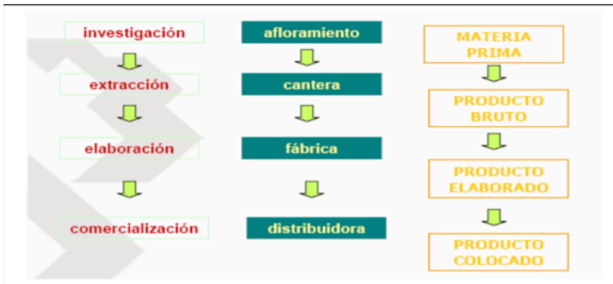
Figura 1 Etapas para la explotación de una cantera.
