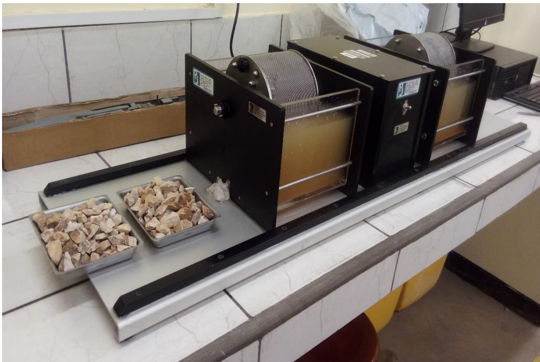
Separación de 500 gr de muestra para cada celda en el equipo micro deval y así proceder con el ensayo de desgaste por frotamiento por dos días consecutivos basados en la norma ASTM 1976.
