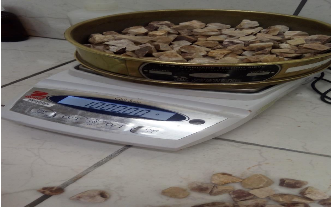
Pesado de la muestra de ½ pulg para el ensayo de frotamiento en la maquina micro deval.
