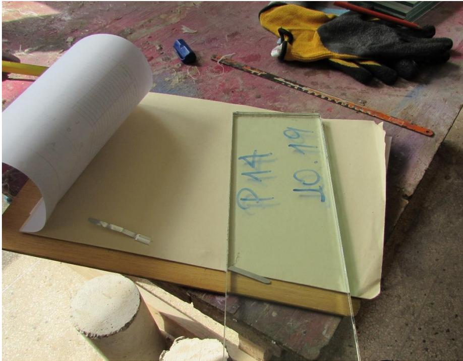
Ilustración 9 - Rotulado de probetas de 10mm.
