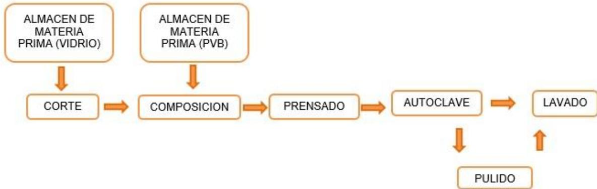
Figura N° 13 - Proceso de Fabricación Vidrio Laminado
