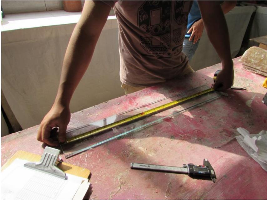
Ilustración 3 - Toma de dimensiones de cada probeta.
