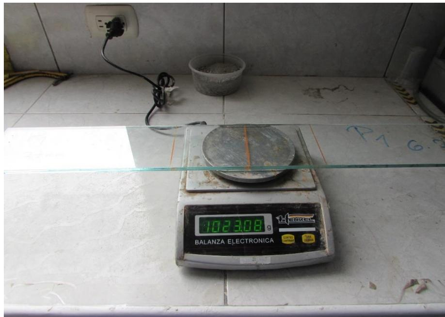
Ilustración 10 - Pesado de probetas.
