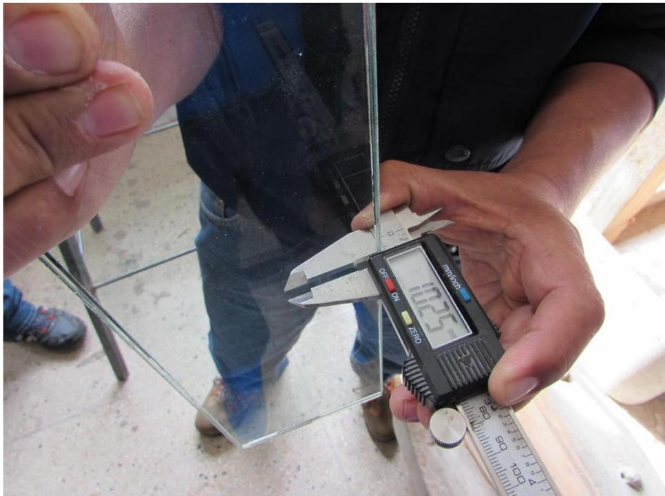
Ilustración 6 - Toma de datos, espesor de probetas de 10mm.
