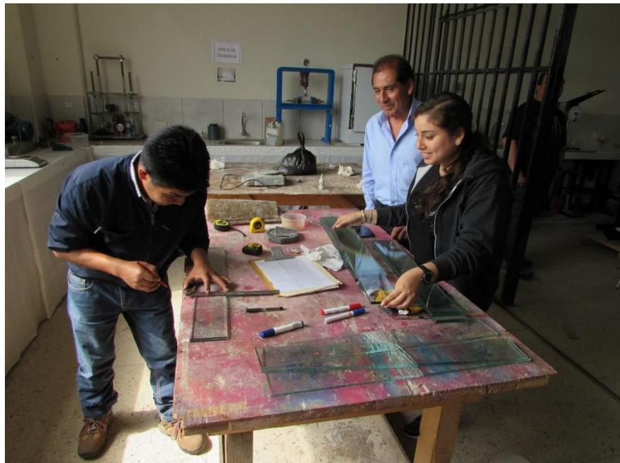
Ilustración 2 - Trazado de ejes de probetas.
