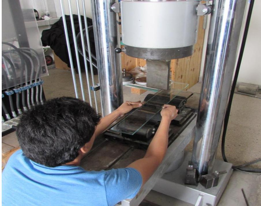
Ilustración 13 - Colocación de probeta para el ensayo.
