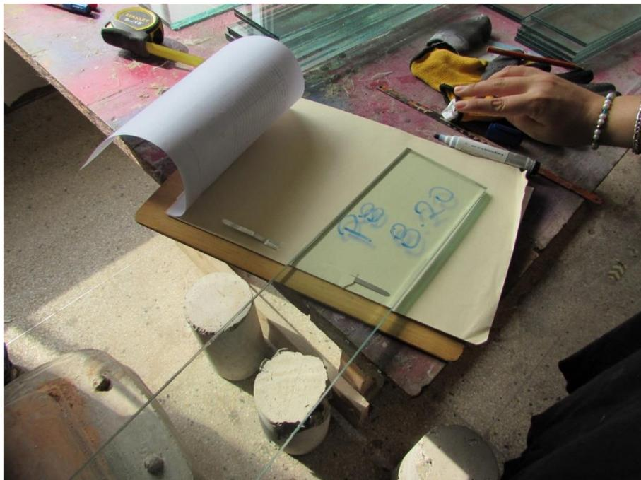
Ilustración 8 - Rotulación de probetas de 8mm.
