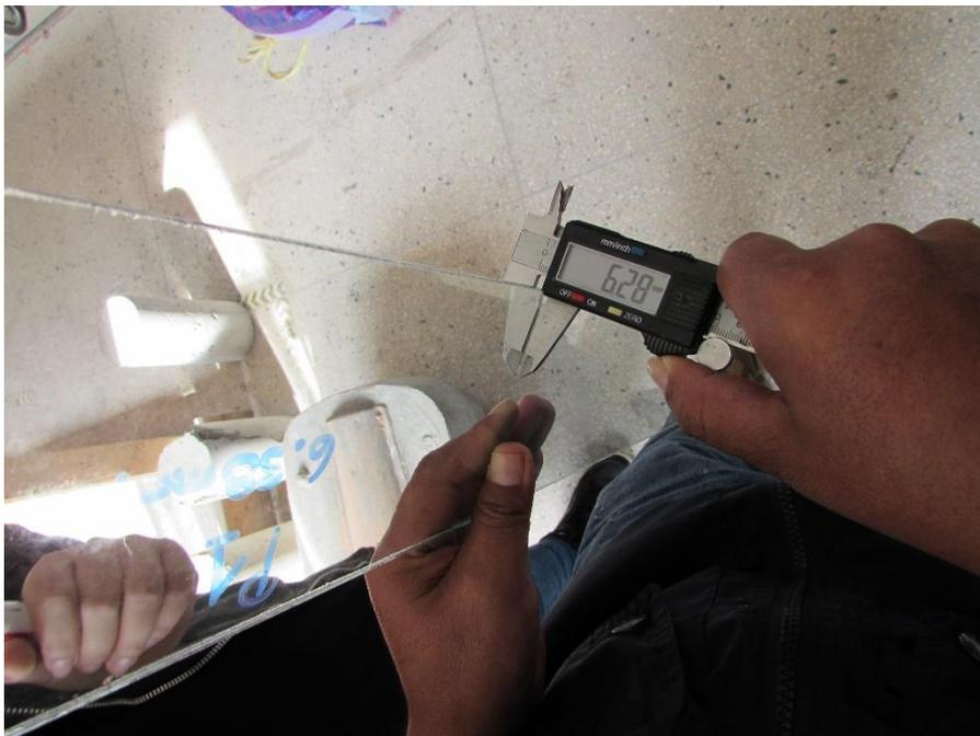
Ilustración 4 - Toma de datos, espesor de probetas de 6mm.
