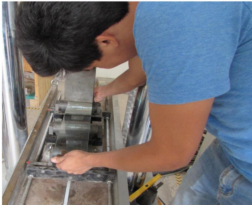
Ilustración 14 - Rotura de probeta del vidrio laminado con espesor de 6mm.
