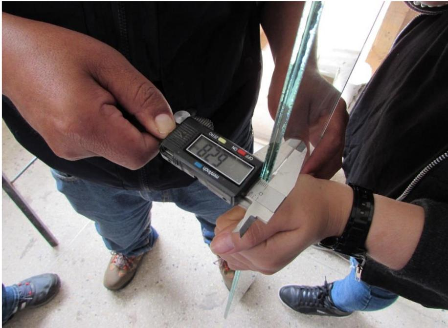
Ilustración 5 - Toma de datos, espesor de probetas de 8mm.
