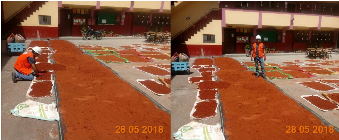
Figura 22. Secado del material para la fabricación de los bloques de adobe compactado
