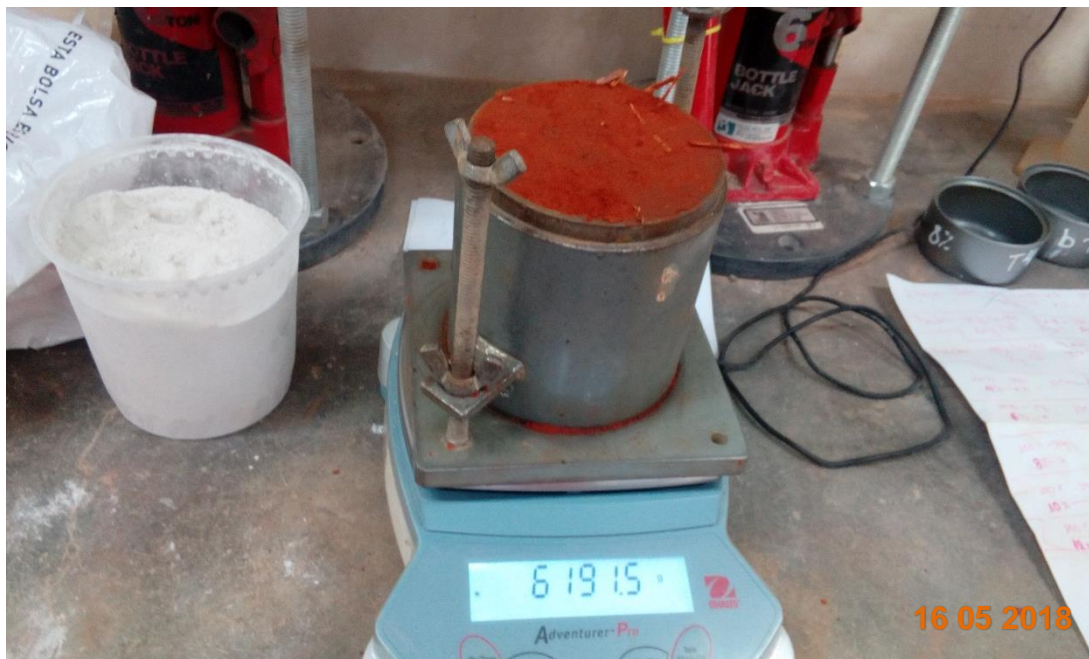
Figura 38. Peso del cilindro más la muestra después de ser compactado durante 25 golpes como indica la norma. Fuente: Elaboración propia, 2018
