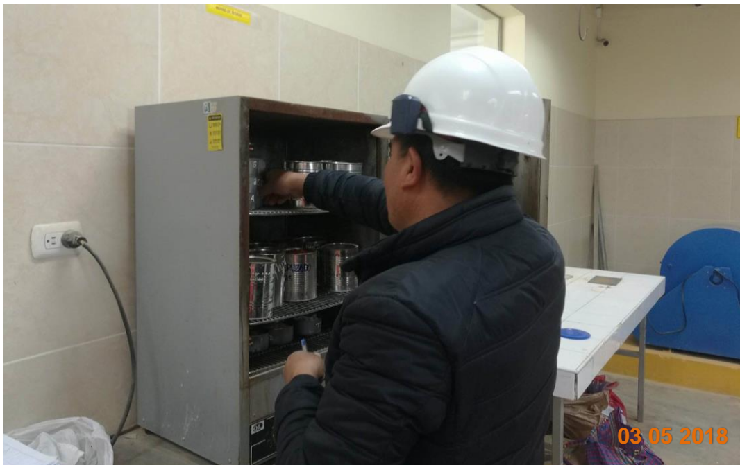
Figura 30. Secado del material durante 24 horas para obtener el contenido de humedad del suelo
