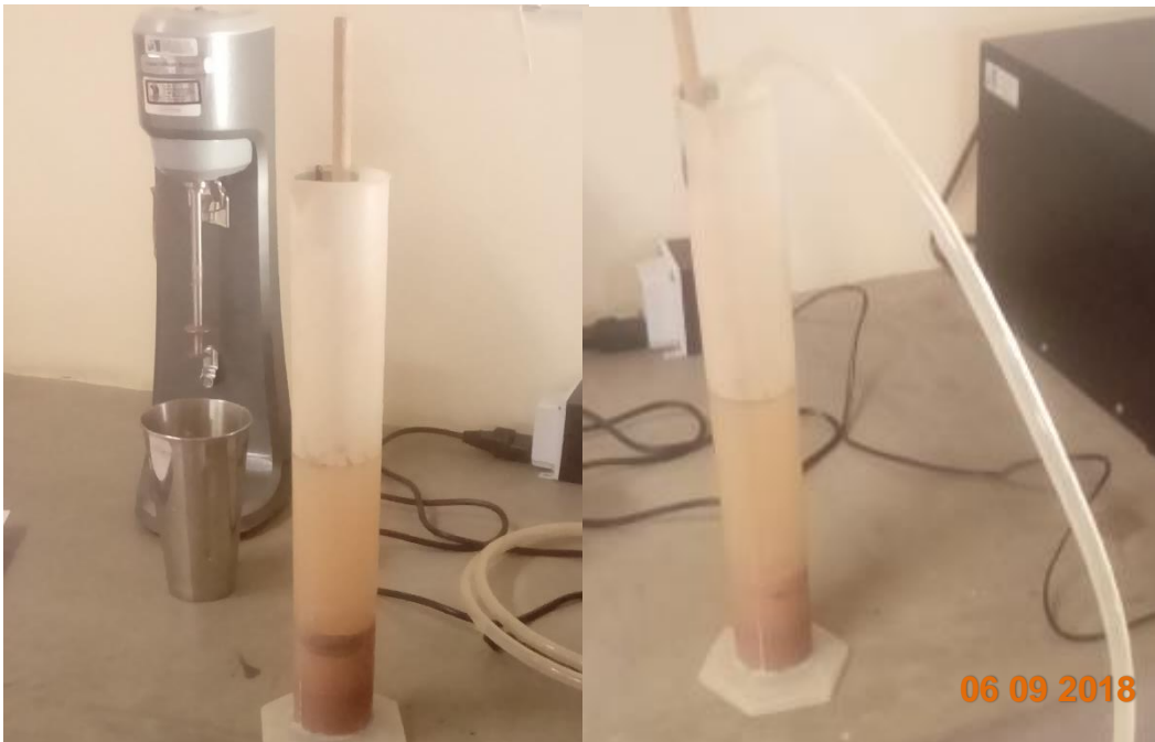
Figura 14. Dejando reposar la muestra durante 15 minutos y luego se sifonea con la manguera
