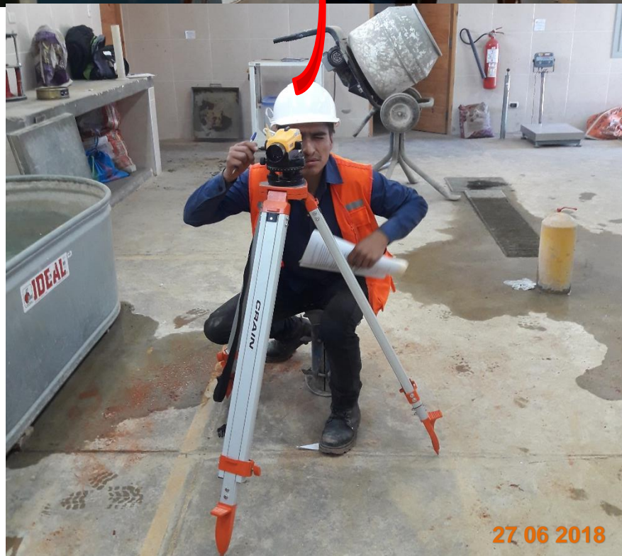
Figura 55. Tomando la medida de deformación a cada milímetro de los especímenes a flexión con el nivel de ingeniero
