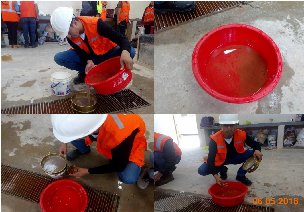
Figura 31. Realizando el lavado del material seco con la malla N°200
