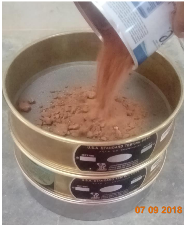
Figura 16. Tamizado del material por la malla N° 40 y N° 200
