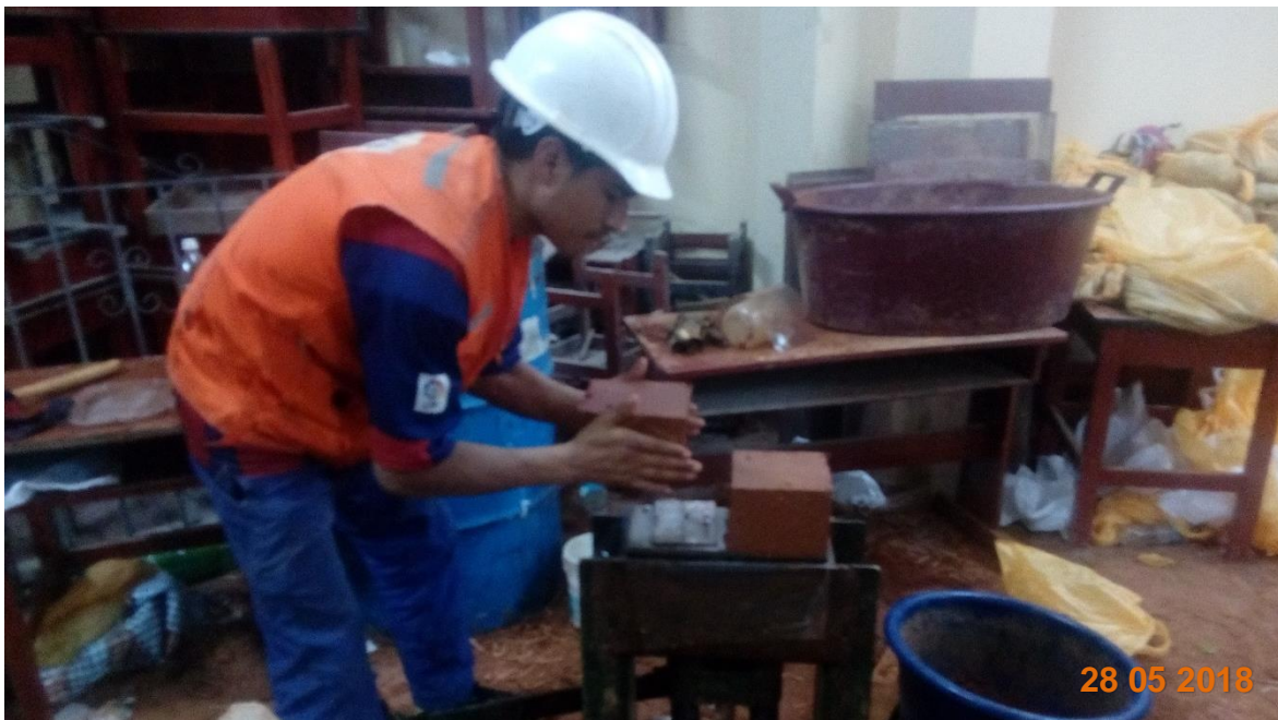
Figura 46. Realizando los cubitos de bloques compactados para el ensayo de compresión
