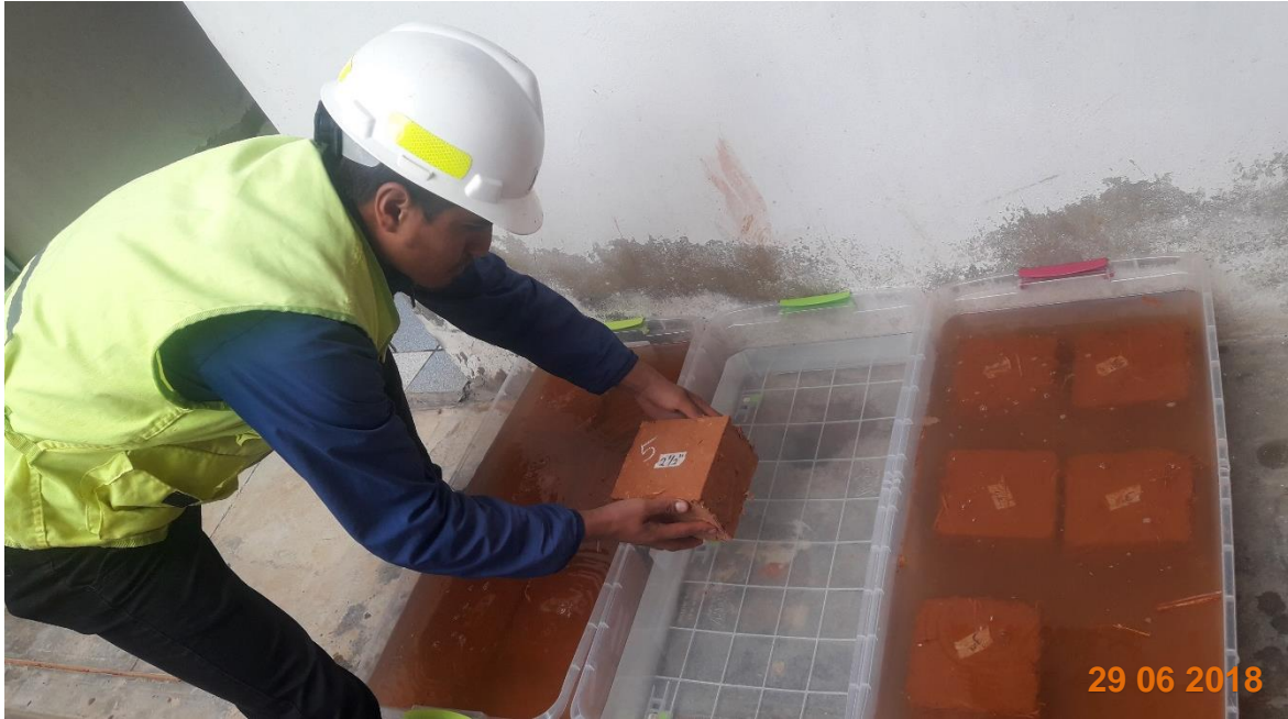
Figura 57. Sumergiendo los especímenes durante 24 horas
