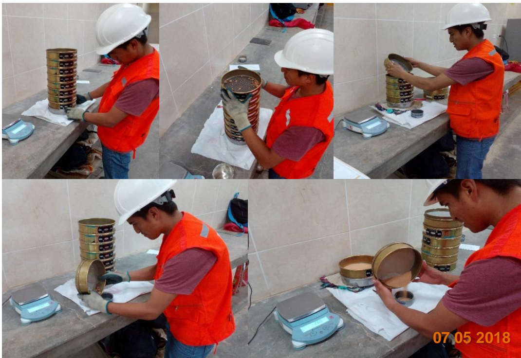
Figura 32. Realizando la granulometría del material por lavado después de ser secado al horno
