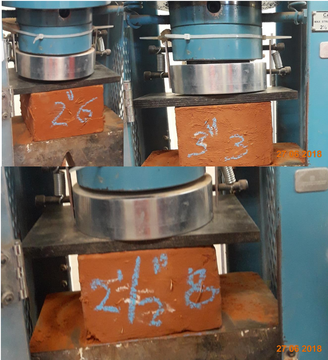
Figura 52. Ensayo a compresión de los especímenes para 2", 2 ½" y 3" de longitud
