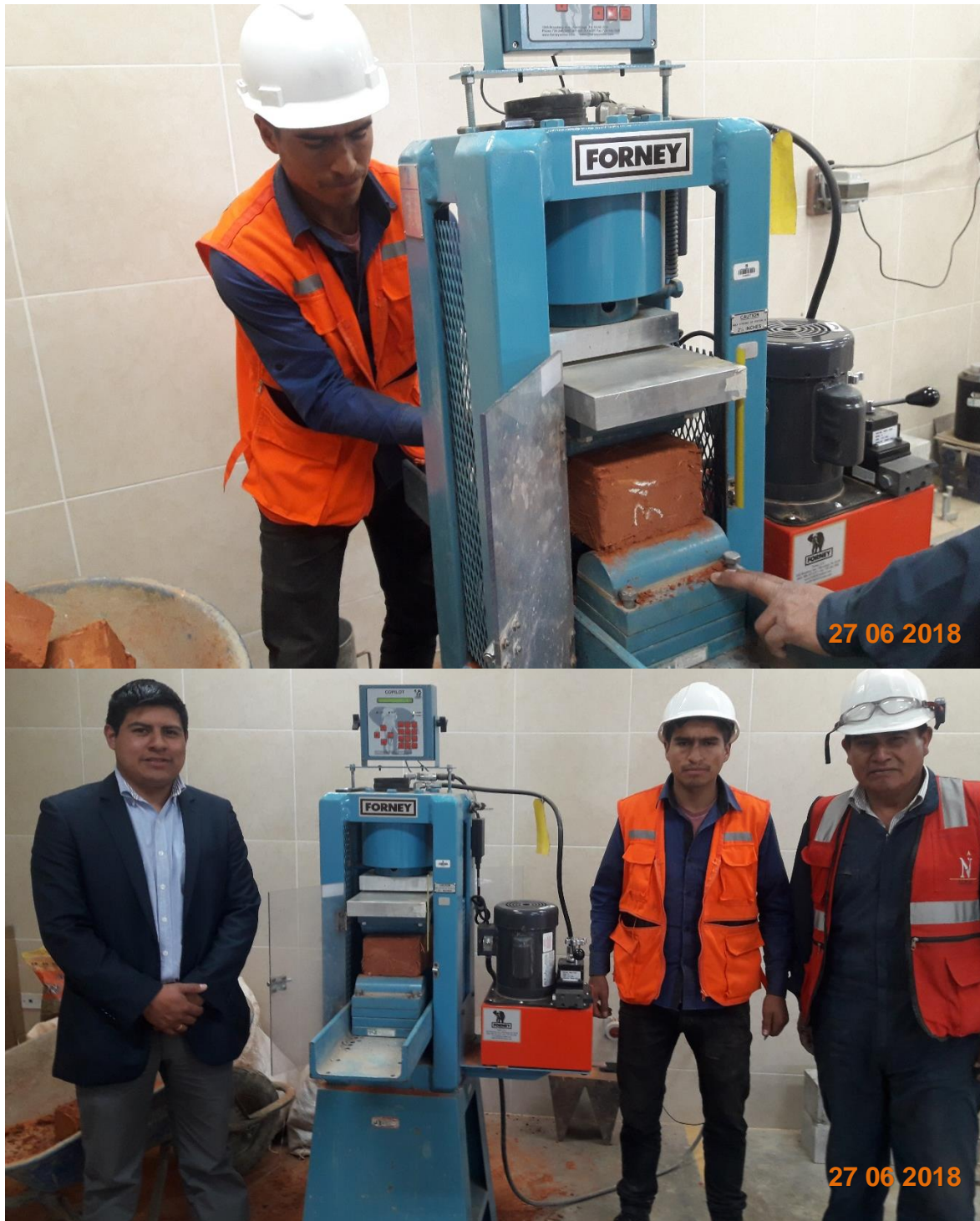
Figura 54. Rotura de los especímenes a flexión para los adobes patrón y con adición de fibras de caña en presencia de mi asesor de tesis
