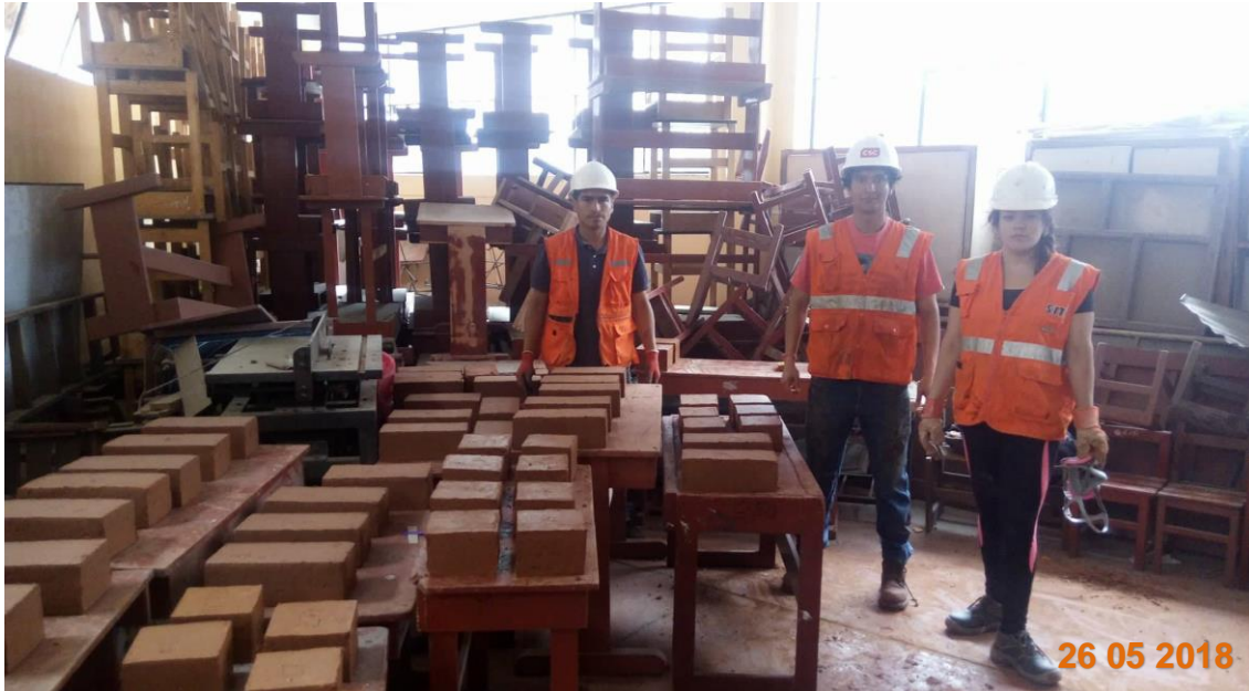
Figura 24. Acopio de los bloques de tierra comprimida para su secado
