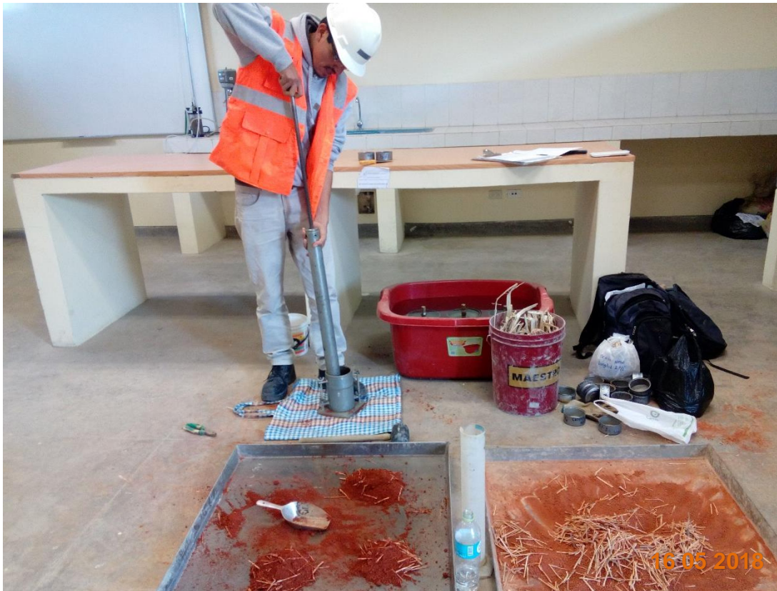
Figura 37. Realizando la compactación Fuente: Elaboración propia, 2018
