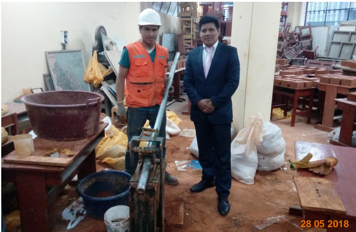
Figura 44. Prensado de la tierra con la máquina CINVA-RAM, con la supervisión de mi asesor Iván Mejía
