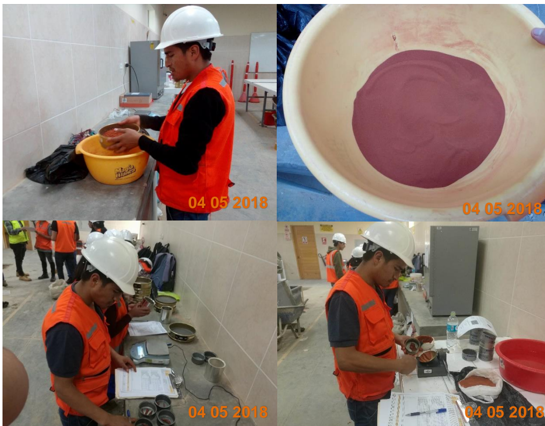
Figura 11. Realizando el ensayo de límites de consistencia o Atterberg
