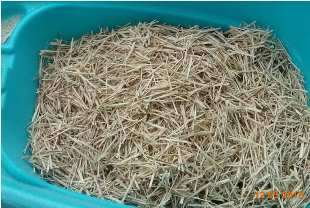
Figura 28. Preparación de la fibra de caña de 2", 2 ½" y 3" de longitud
