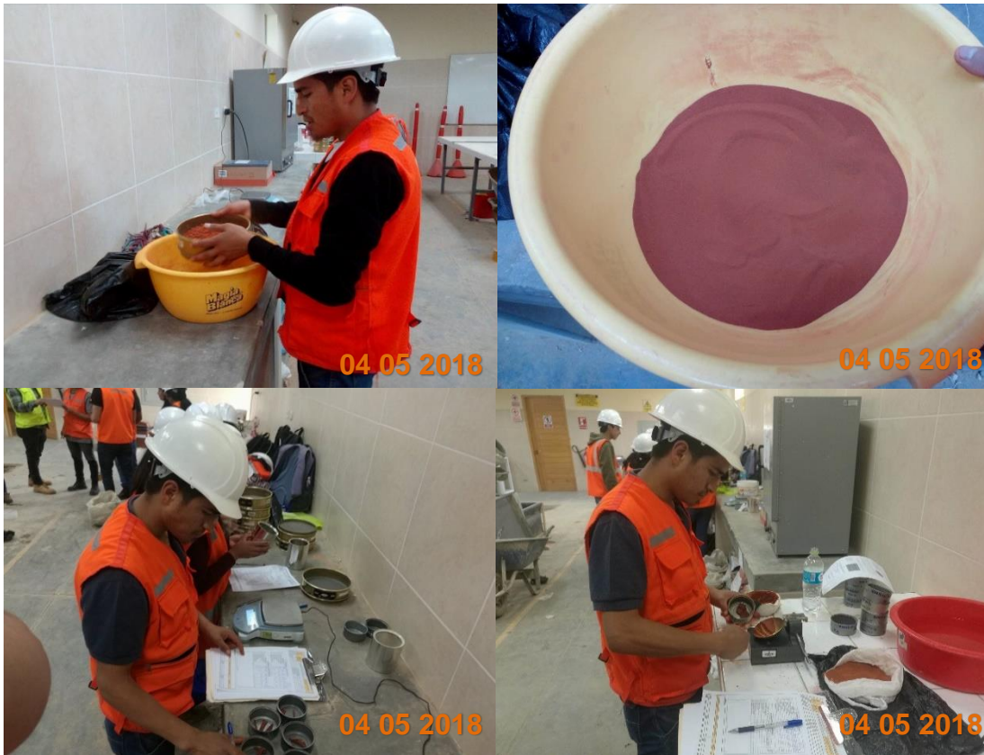
Figura 33. Realizando límites de Atterberg o límites de consistencia
