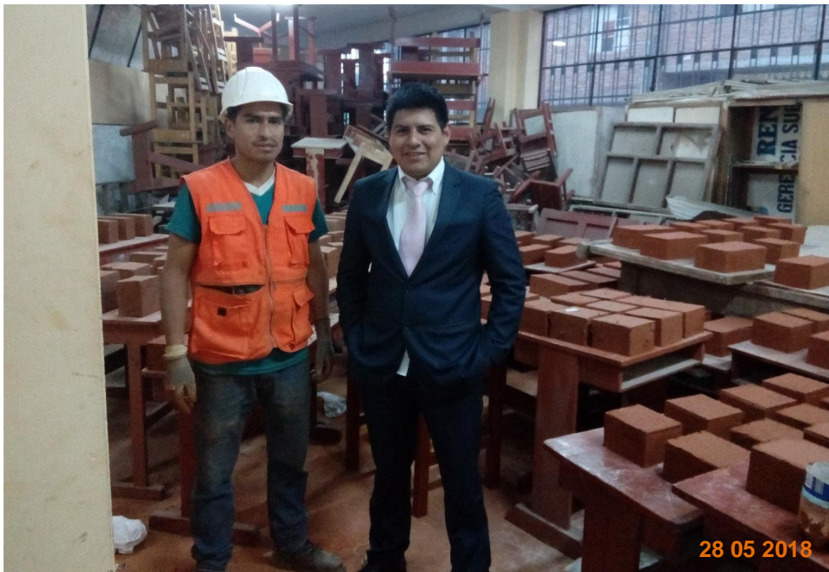
Figura 48. Secado de los bloques compactados con la máquina CINVA-RAM
