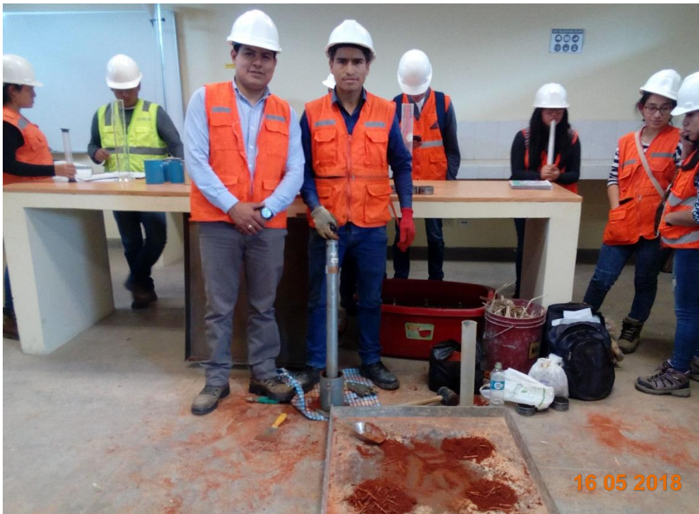
Figura 36. Realizando Proctor Modificado con mi asesor de tesis Iván Mejía
