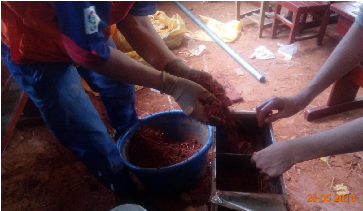
Figura 43. Introduciendo el material para la elaboración del bloque compactado a la máquina CINVA-RAM
