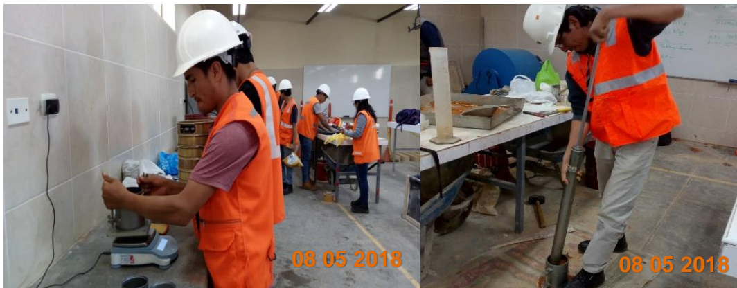
Figura 19. Compactación de la muestra patrón
