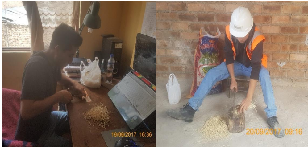
Figura N° 12. . Izquierda, corte con tijera; Derecha corte con machete la paja toquilla.
