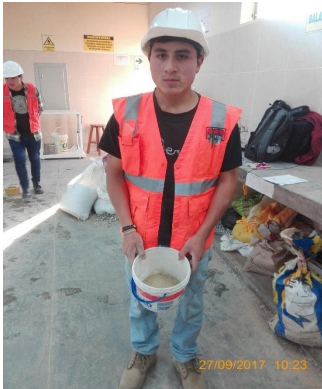
Figura N° 16. Sumergir el suelo durante cuatro horas en agua.
