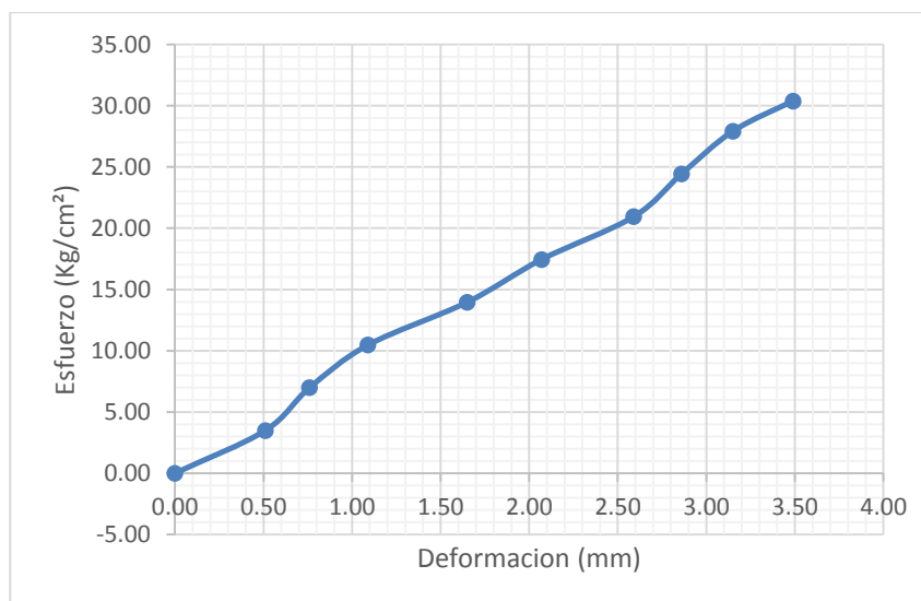
Gráfico N° 54. Curva Esfuerzo – Deformación de muestra 1F – Adobe con adición de 1 pulgada de paja toquilla.
