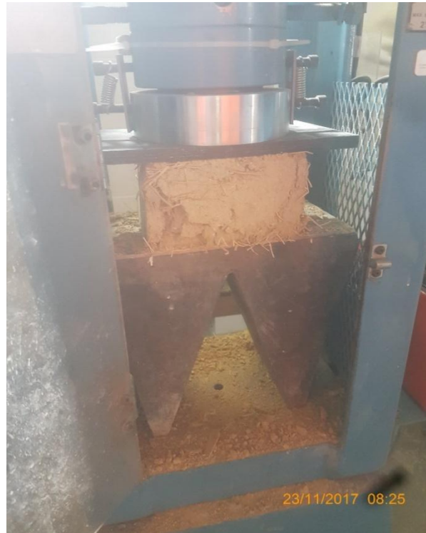
Figura N° 44. Falla del adobe sometido a compresión axial.
