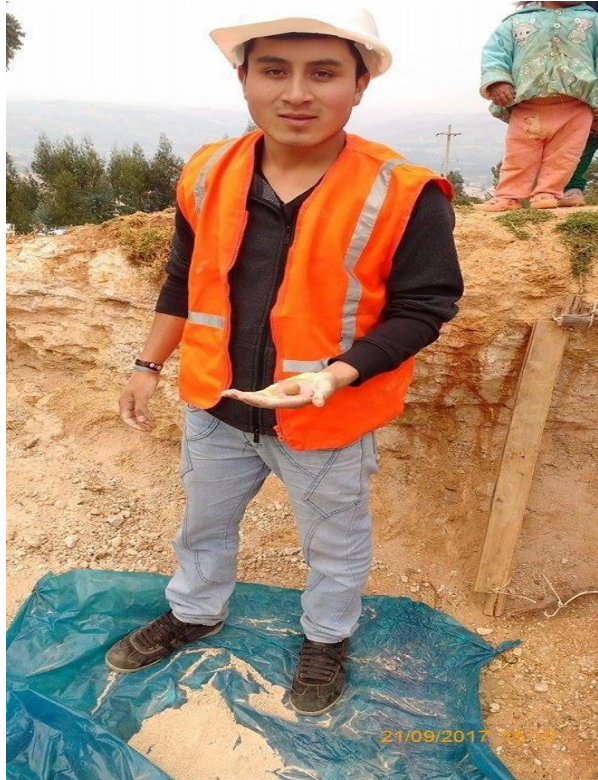
Figura N° 7. Prueba de campo para ver presencia de arcilla o resistencia seca.
