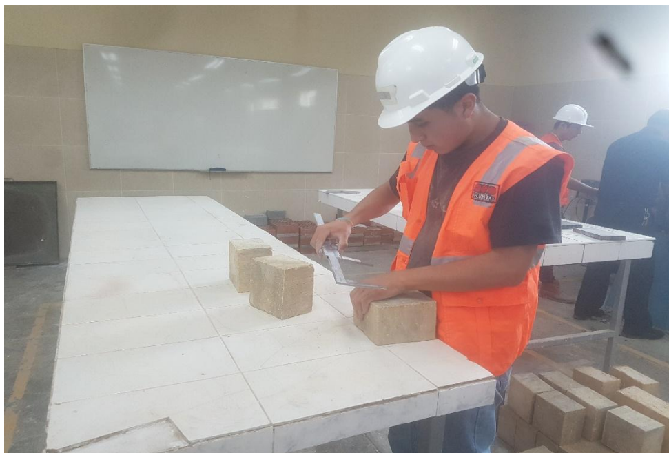
Figura N° 43. medición de las aristas de adobes.
