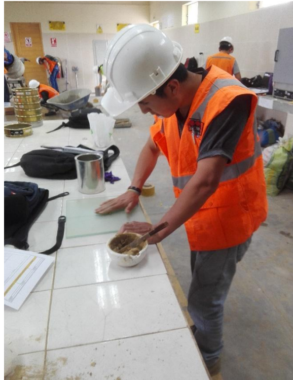
Figura N° 38. ensayo de límites de consistencia.
