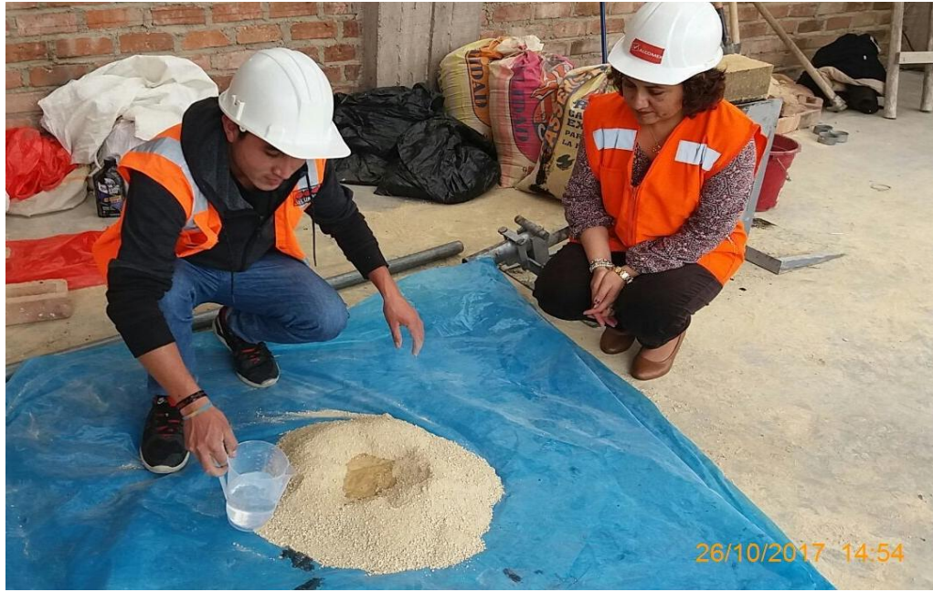
Figura N° 28. Mezclado del suelo con el óptimo contenido de humedad.
