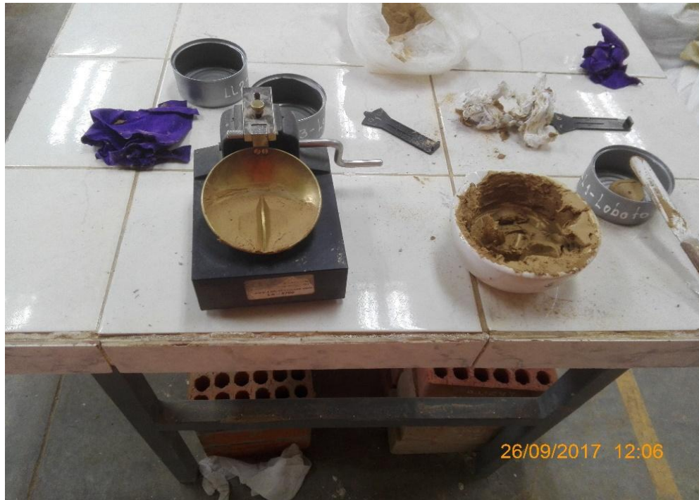
Figura N° 19. Mezclado uniforme del suelo en la cápsula de porcelana
