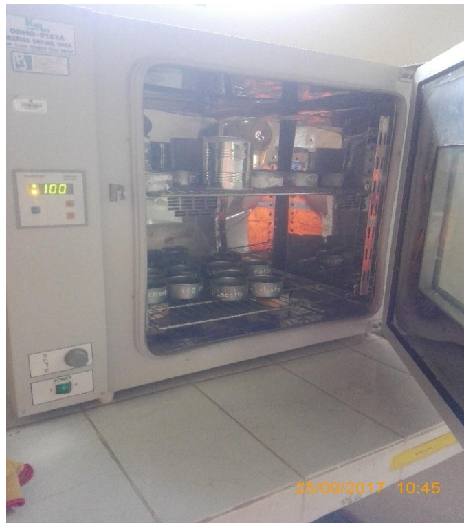
Figura N° 15. Secado al horno del suelo húmedo por 24 horas.
