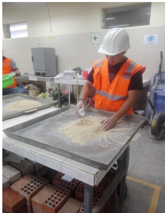
Figura N° 39. adición de agua para realizar el ensayo de proctor modificado.
