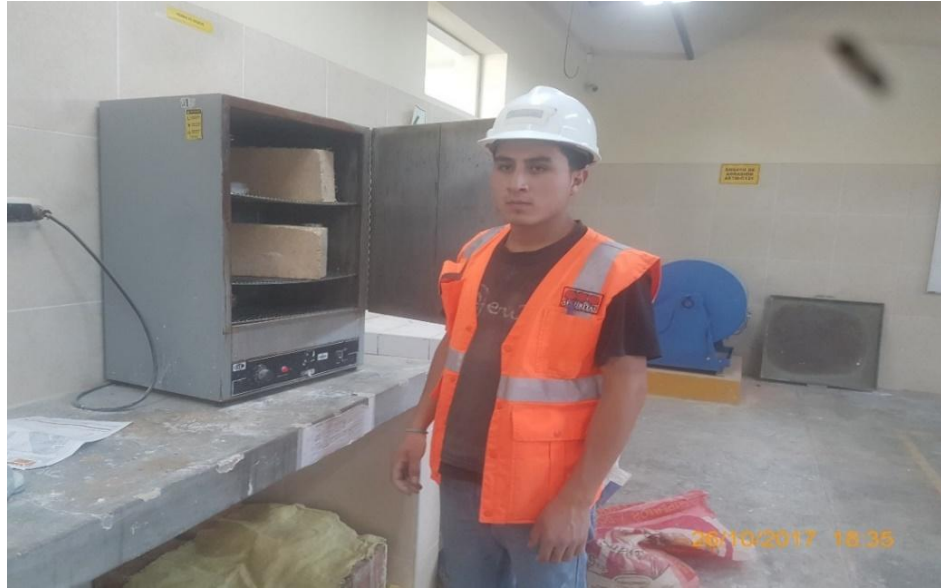
Figura N° 33. Secado al horno de adobes.
