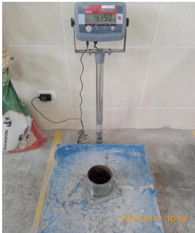
Figura N° 22. Peso y medidas del molde de 101.6 mm de diámetro.
