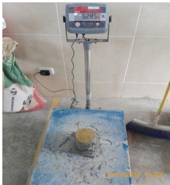
Figura N° 24. Determinación del peso del molde enrasado.
