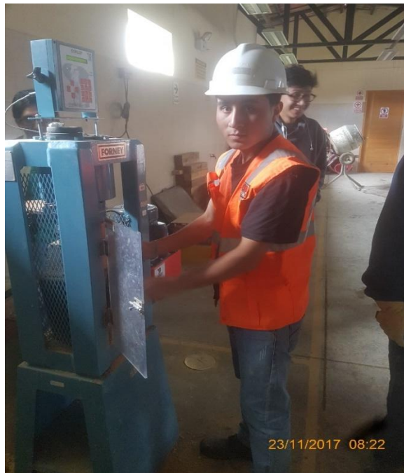
Figura N° 34. Ensayo de resistencia al a compresión axial.
