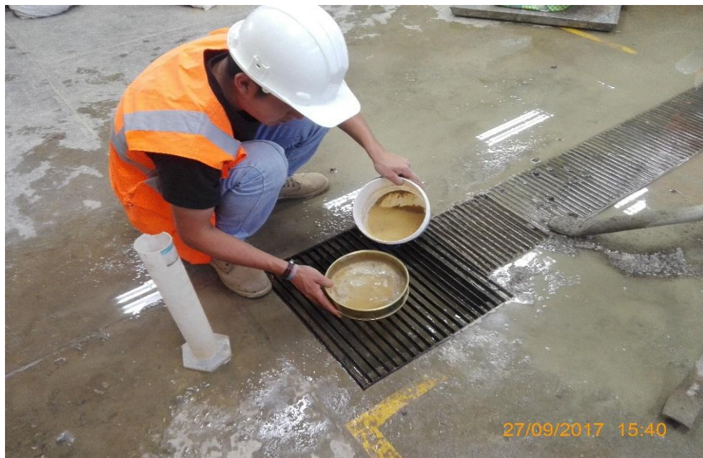
Figura N° 17. Realización del lavado por el tamiz N° 200 del suelo
