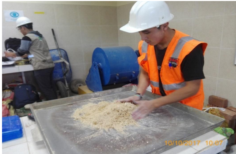
Figura N° 23. Mezclado de 3 kilogramos de suelo con una determinada cantidad de agua.
