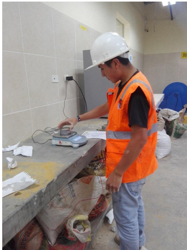
Figura N° 37. peso de muestras para determinar contenido de humedad.
