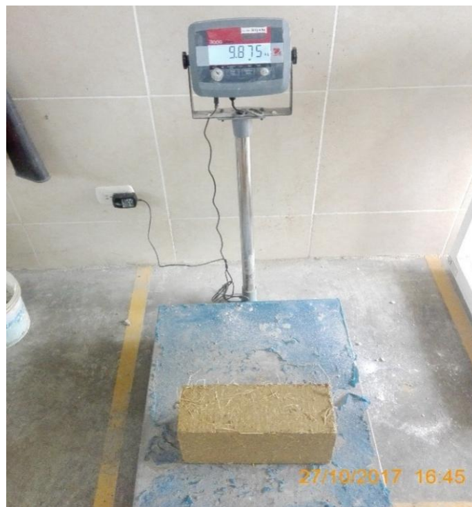
Figura N° 31. Secado de los adobes convencionales y con adición de paja toquilla. Finalmente se secó el adobe por un tiempo de 28 días protegido del viento para no generar rajaduras.
