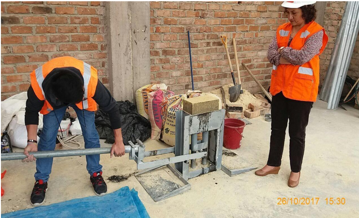
Figura N° 42. elaboración de adobes compactados con la maquina CINVA RAM.
