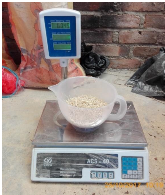
Figura N° 29. Determinación del peso la paja toquilla para cada adobe.
