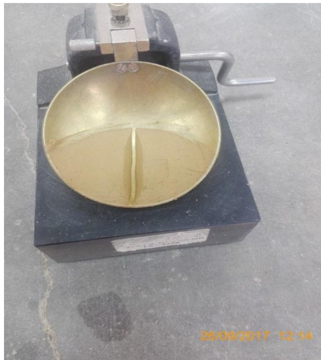
Figura N° 20. Porción de pasta nivelada y ranurada en la copa de casa grande.
