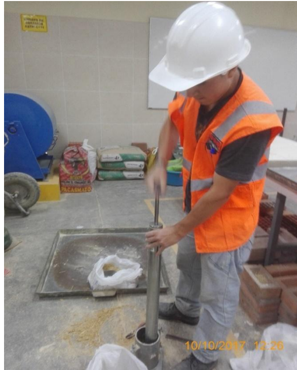
Figura N° 40. compactación de proctor modificado con 25 golpes y 5 capas.
