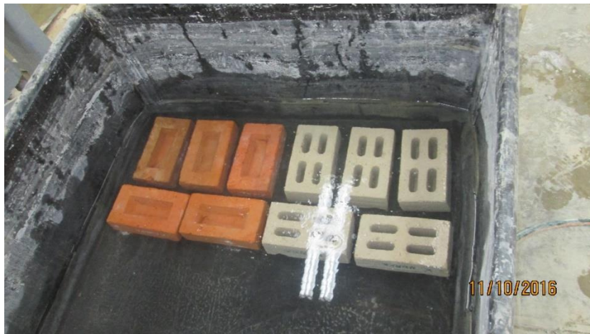
Figura 19. Ladrillos sumergidos por 24 horas luego de haber sido pesados.
