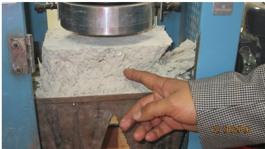
Figura 49. Ladrillo ensayado a compresión.
