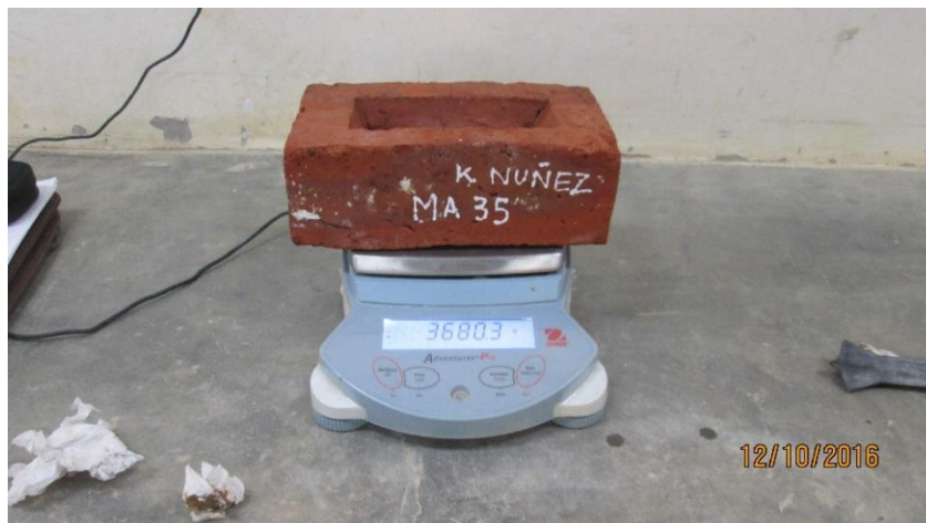
Figura 41. Pesando un ladrillo de arcilla luego de haber sido sumergido por 24 horas.
