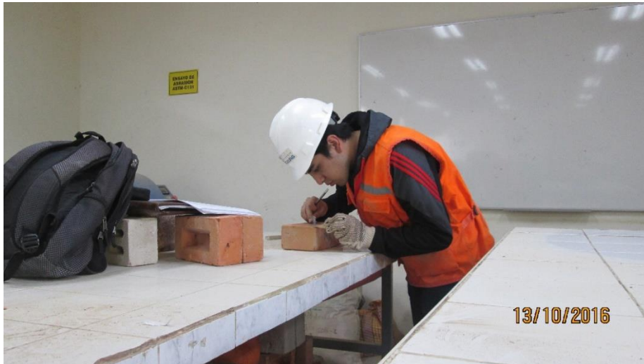
Figura 18. Medición del alabeo.
