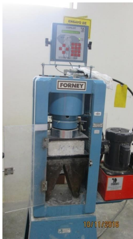
Figura 21. Ladrillo de concreto en la máquina a compresión.
