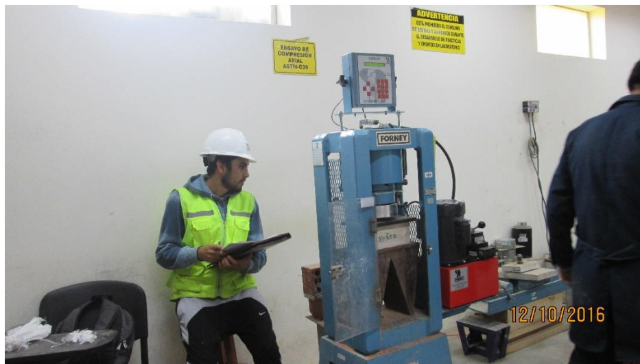
Figura 47. Apuntando la deformación en el ensayo a compresión.
