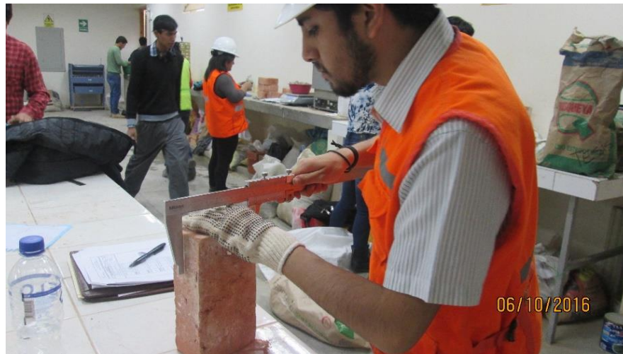
Figura 17. Medición de la variación dimensional.
