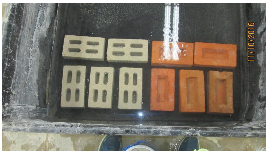
Figura 45. Ladrillos sumergidos en agua por 24 horas para el ensayo de absorción.
