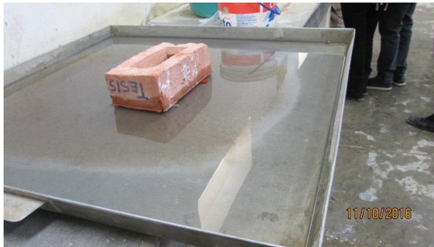
Figura 20. Ladrillo usado para ensayo de succión.
