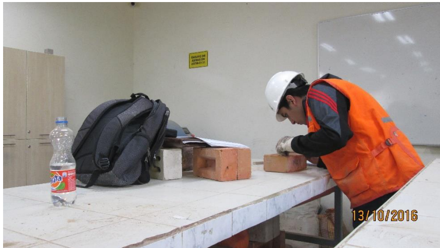
Figura 44. Realizando el ensayo de alabeo.
