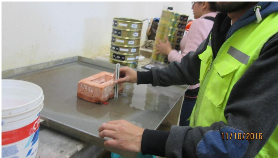
Figura 46. Midiendo la altura de la lámina de agua en el ensayo de succión.
