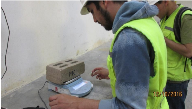
Figura 40. Pesando un ladrillo de concreto luego de haber sido sumergido por 24 horas.
