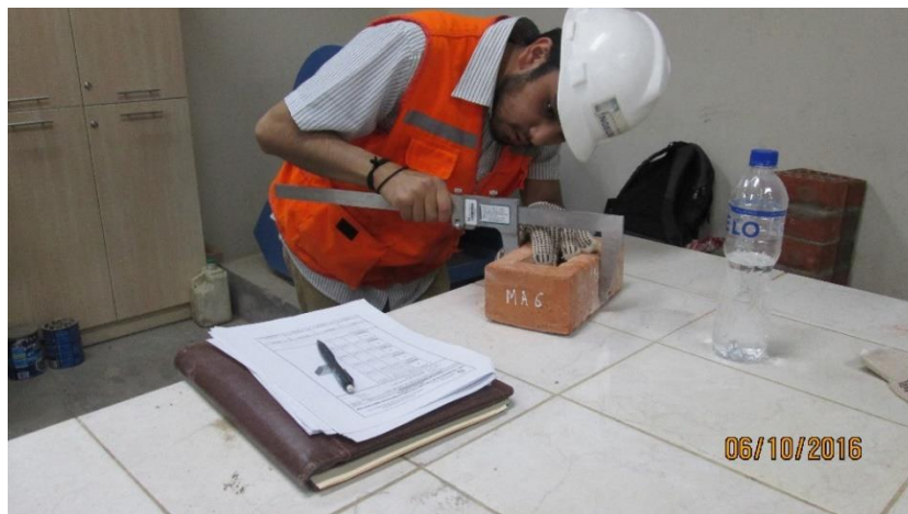
Figura 37. Usando el vernier para sacar medidas de las caras de los ladrillos.
