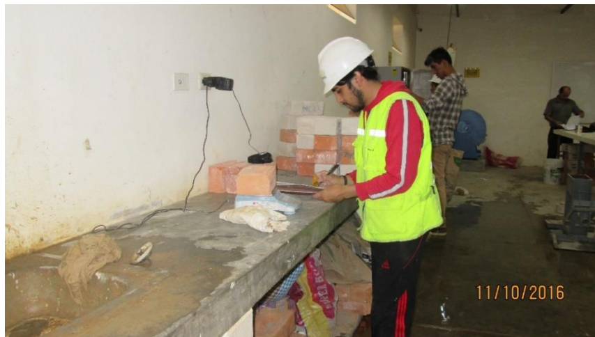
Figura 39. Pesando ladrillos antes de meterlos en el horno.
