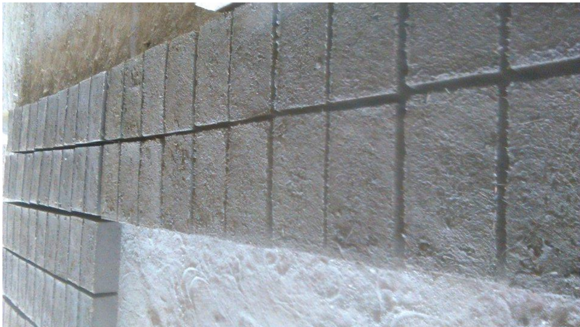
Fotografía N° 9: Adobes recién fabricados colocados en orden para su secado.
