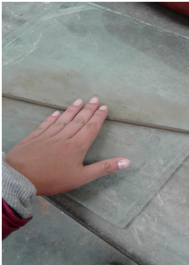
Figura 23: Muestra enrollada encima del vidrio para ensayo de límite plástico.
