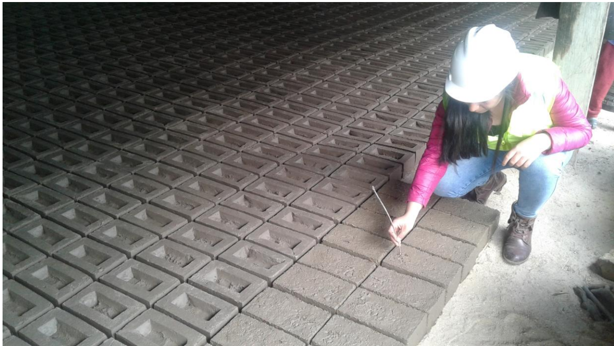
Fotografía N° 8: Colocación de señal en los adobes para su identificación.
