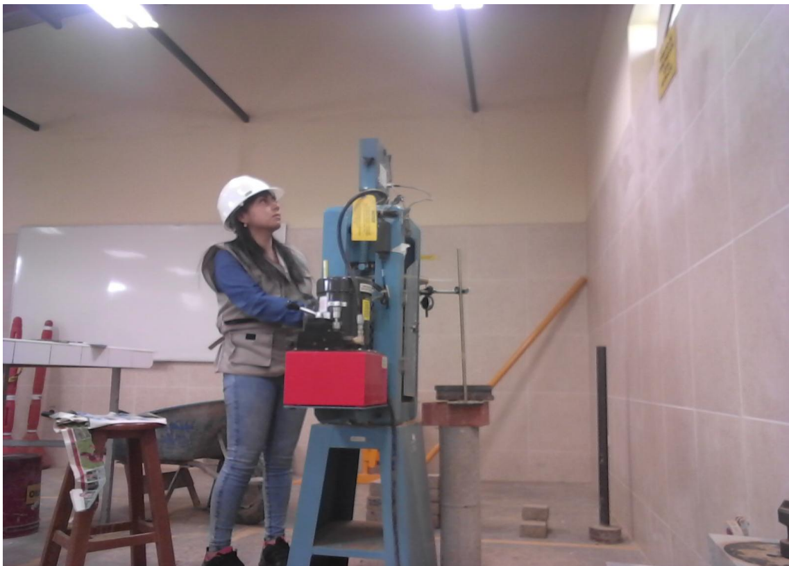
Fotografía N° 13: Utilización del equipo para los ensayos de compresión y flexión.
