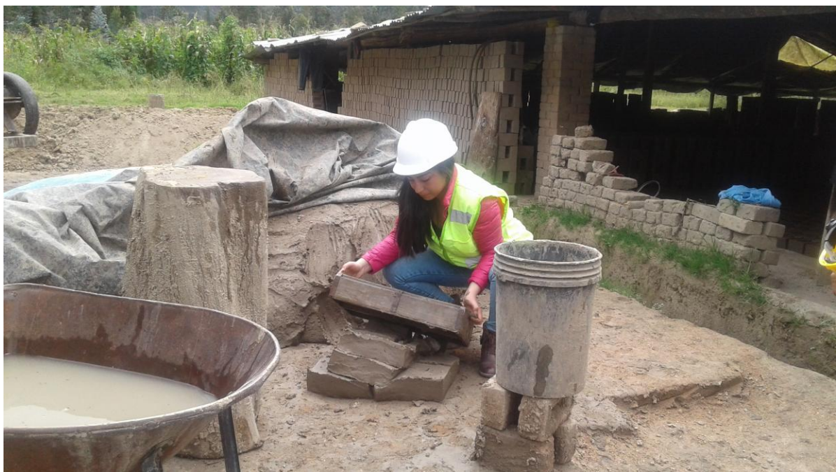
Fotografía N° 2: Molde para fabricación de adobes.
