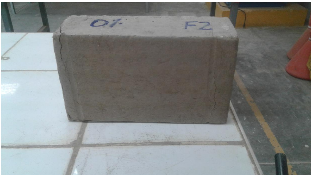
Fotografía N° 16: Especimen F2- 0%, después del ensayo de flexión
