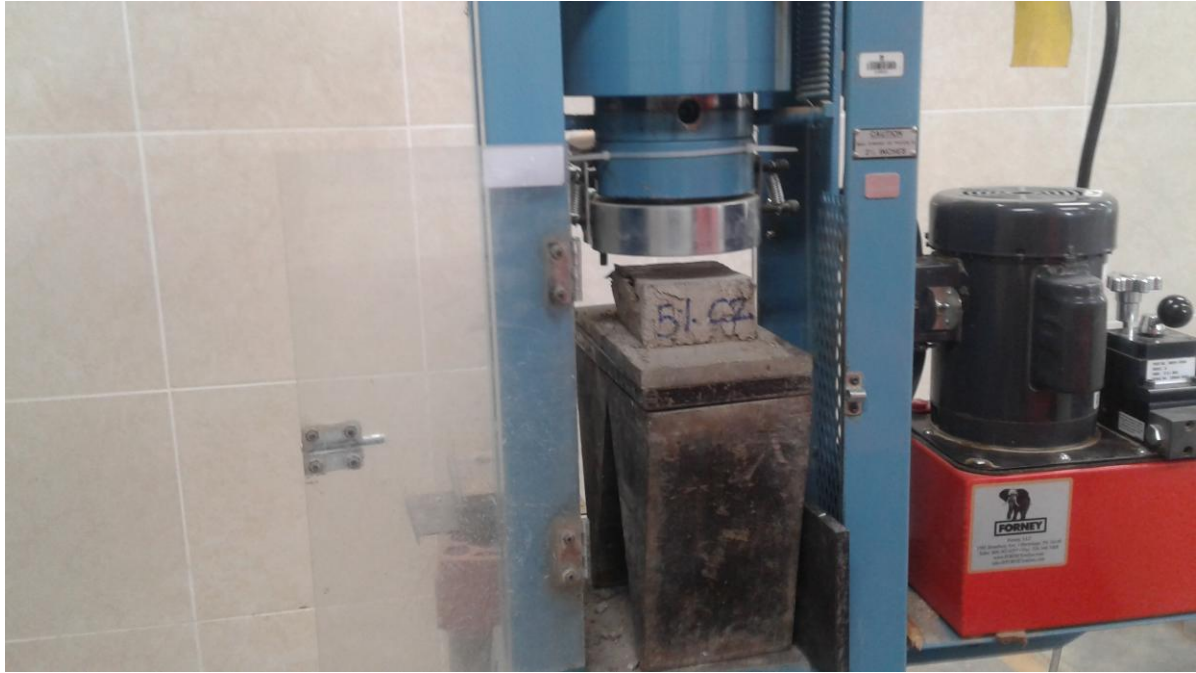
Fotografía N° 14: Ensayo de compresión del espécimen C2 -5%.
