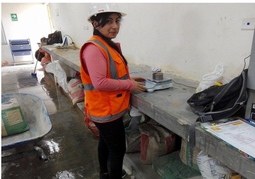
Figura 20: Peso de la muestra para el ensayo de contenido de humedad.
