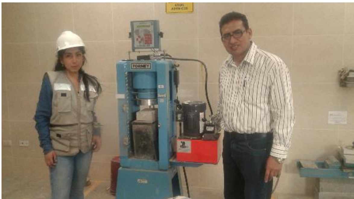
Fotografía N° 18: Ensayo de flexión en el equipo de carga axial.
