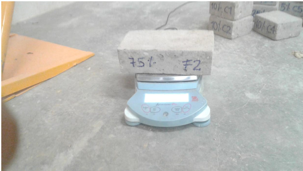
Fotografía N° 11: Pesado de adobes para el ensayo de flexión en la balanza electrónica del laboratorio de la UPNC.
