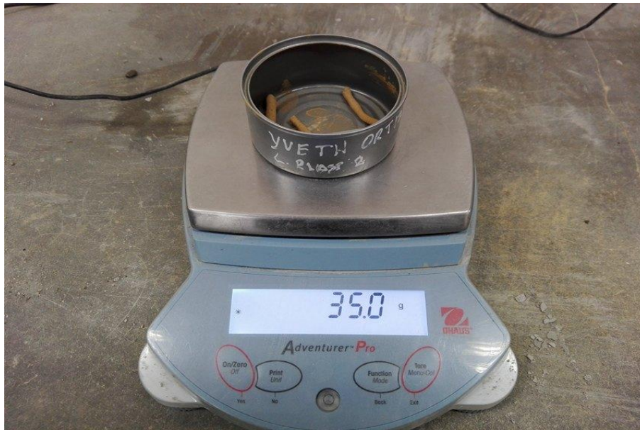
Figura 24: Pesado de muestra en tara para luego introducir al horno.
