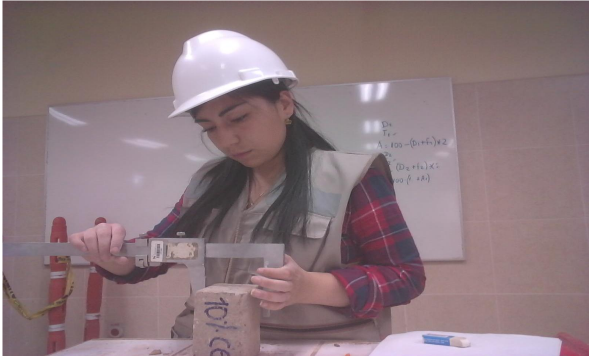
Fotografía N° 12: Medición de los lados de los adobes utilizando el vernier.
