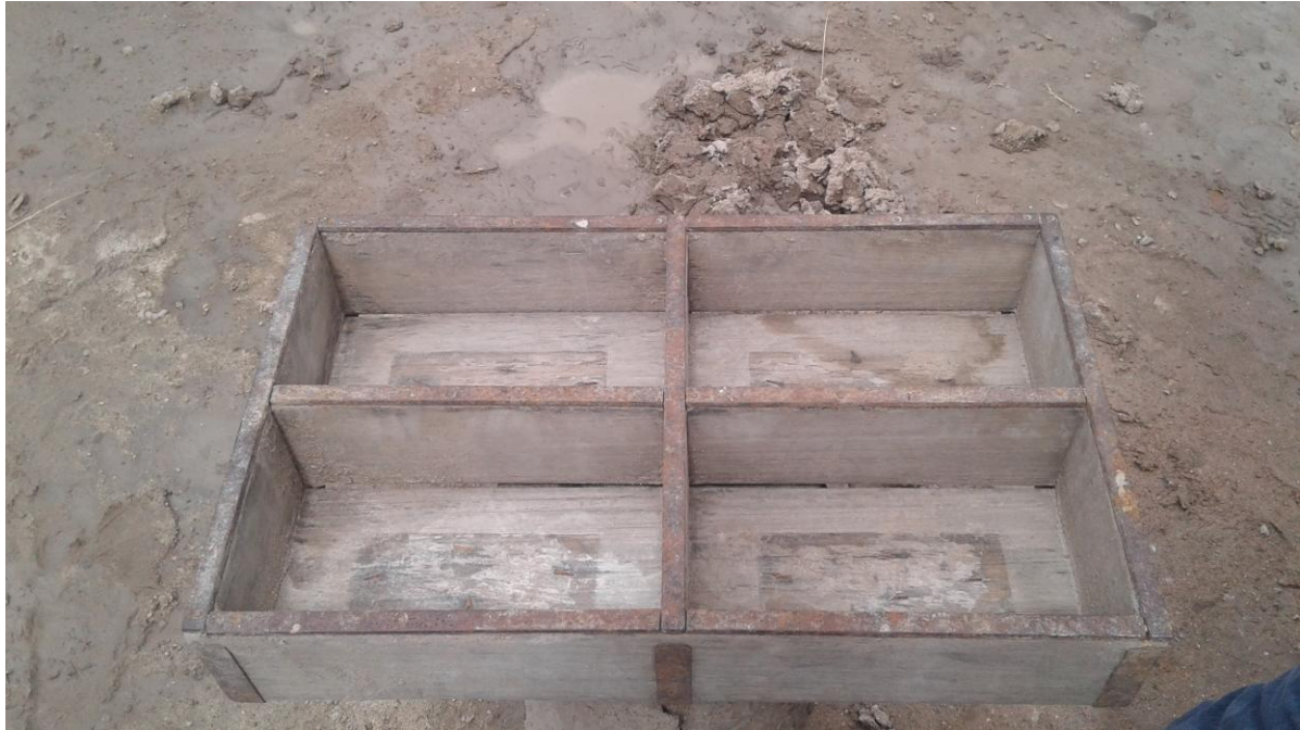
Fotografía N° 2: Molde para fabricación de adobes.
