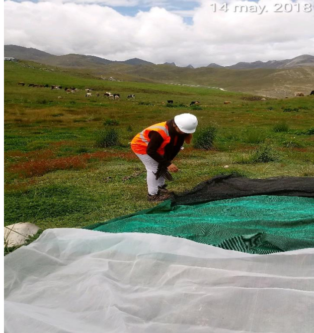
Figura 4. Colocación de las mallas sobre el suelo, para asegurar que las tres tengan el mismo tamaño.
