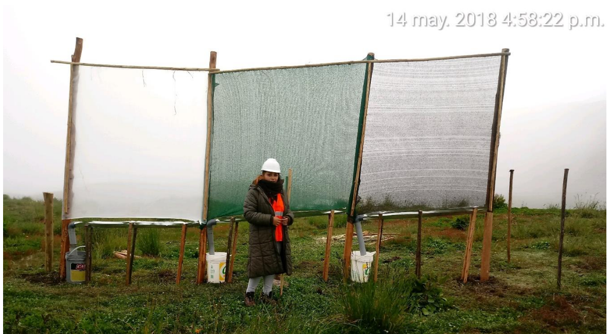
Figura 11. Captador vertical de neblina (atrapanieblas) concluido.
