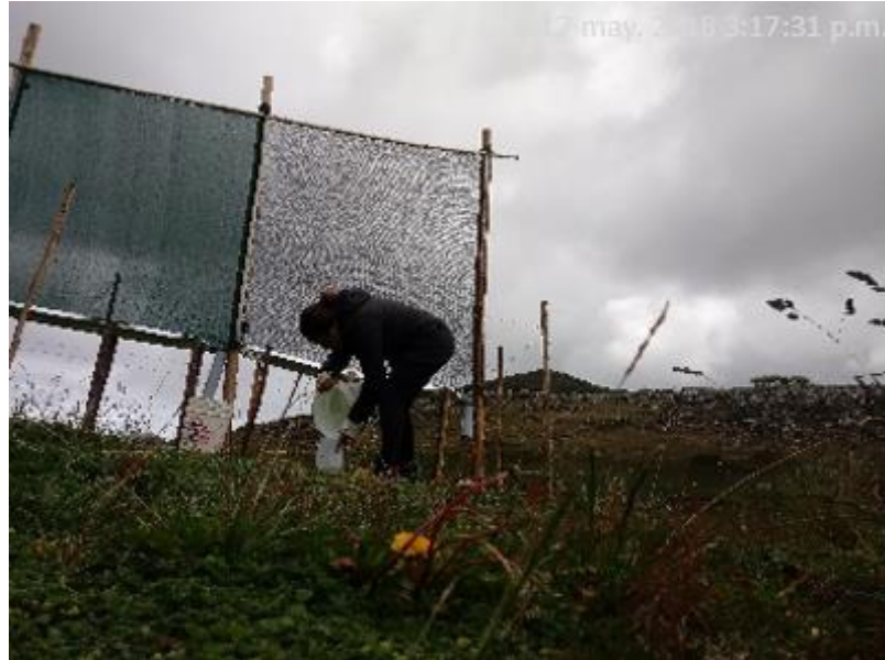
Figura 14. Día 17 de mayo, medición del agua captada.
