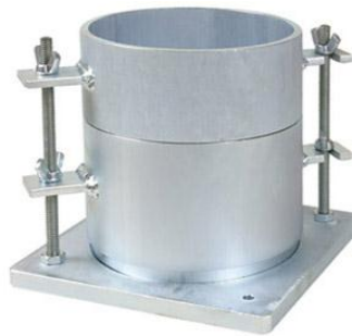
Figura 9: Probeta para ensayo de California Bearing Ratio (CBR). Fuente (Propia)
