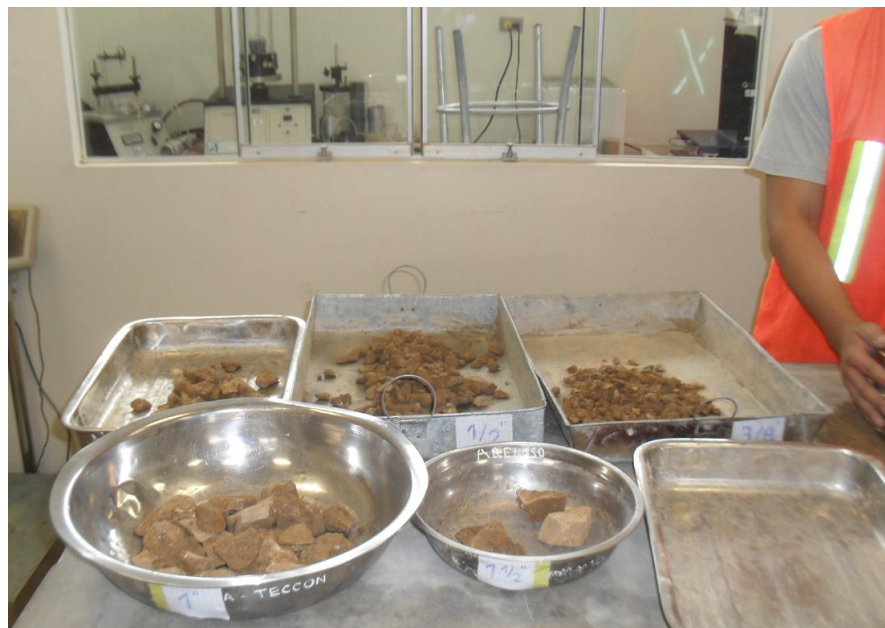
Figura 92: Muestra Retenida en cada Malla (Propia)
