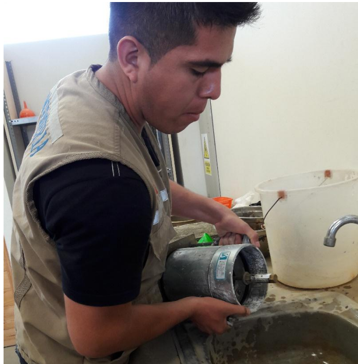
Figura 101: Muestra después de 4 días inmerso en agua (Propia)
