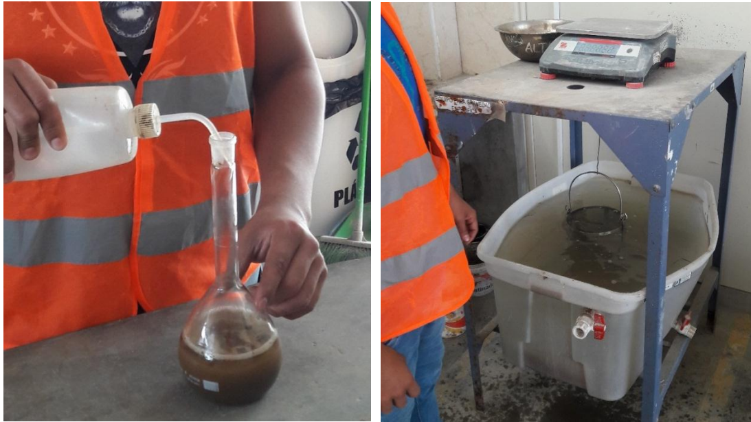
Figura 93: Peso específico y absorción del agregado fino y grueso (Propia)
