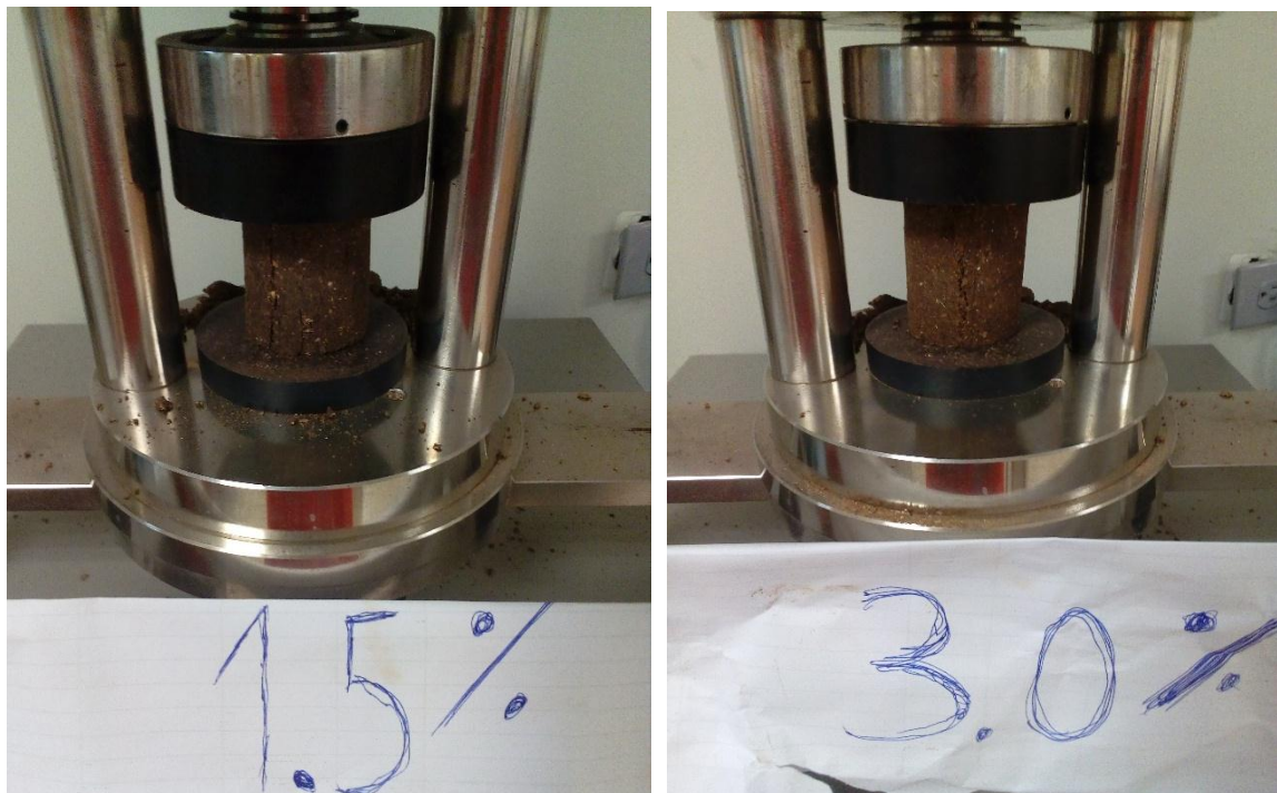
Figura 106: Ensayo de Resistencia Compresión No Confinada al 1.5% y 3.0% de Emulsion Asfaltica (Propia)
