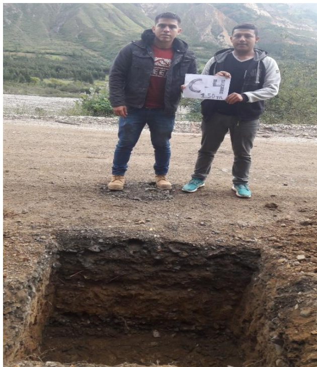
Figura 90: Calicata N° 4 Tramo +3.00 Km - +4.00 Km (Propia)
