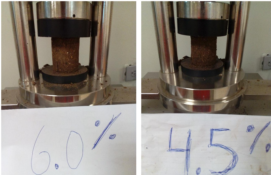
Figura 107: Ensayo de Resistencia Compresión No Confinada al 4.5% y 6.0% de Emulsión Asfáltica (Propia)
