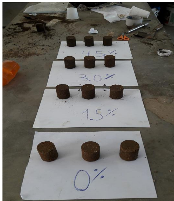
Figura 104: Probetas con diferentes porcentajes de emulsión asfáltica (Propia)
