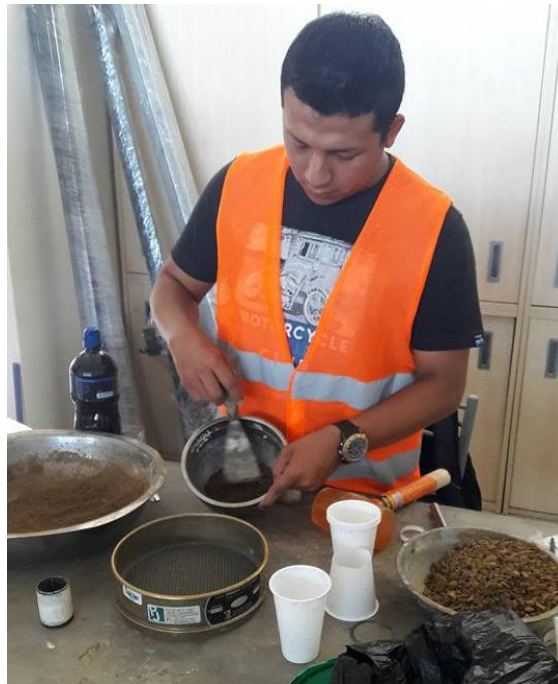
Figura 103: Preparación de la muestra con emulsión asfáltica (Propia)
